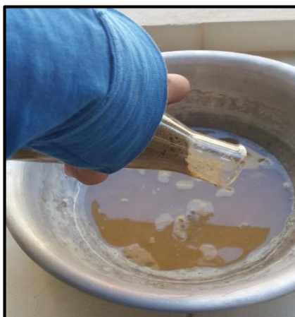
Figura 85. La muestra en el plato listo para meter al horno y pesarla posteriormente.
