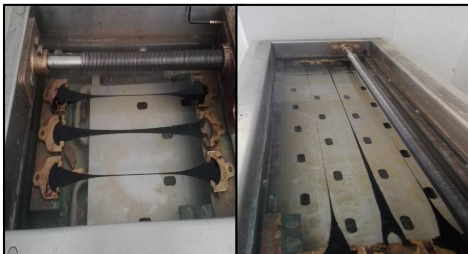
Figura 121. Encender el equipo y ver cuánto es la marcación en la regla cuando caiga al estirarse el residuo de emulsión.
