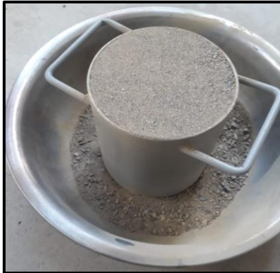
Figura 71. Volumen suelto de arena.
