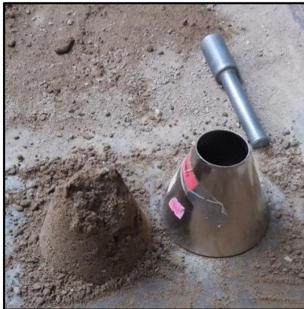
Figura 80. Introduciendo la muestra en el cono en 3 capas con 25 golpes y enrasando.
