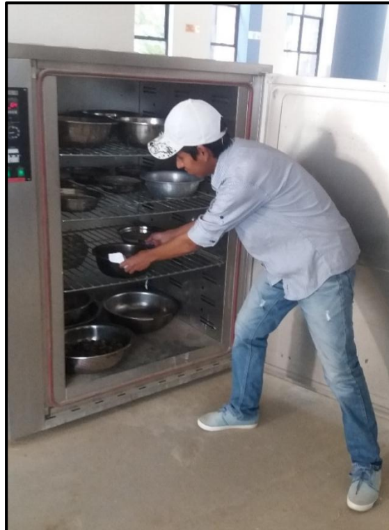
Figura 92. Obtención del peso seco de la muestra.
