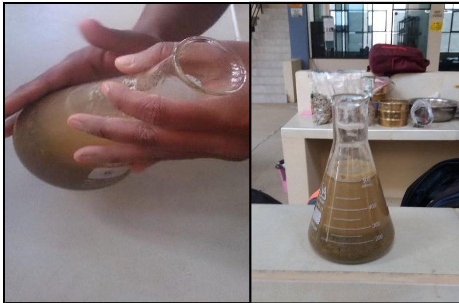
Figura 84. Agitando el matraz y vaciando en un plato toda la muestra.
