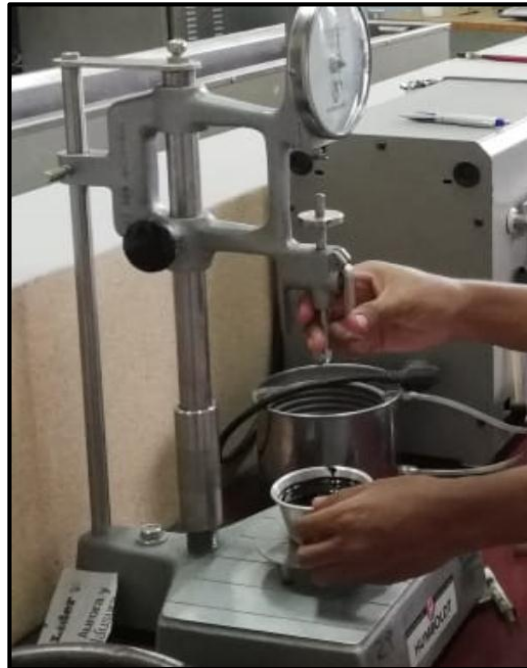
Figura 115. Proceso de penetración.
