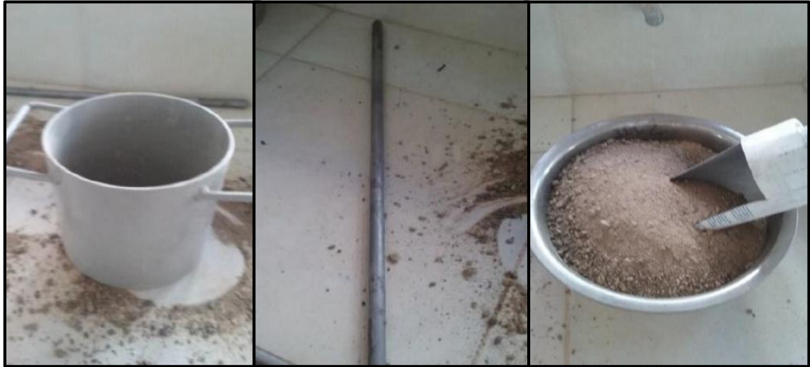
Figura 70. Materiales molde de 3 L, varilla y la muestra de arena para realizar el ensayo.
