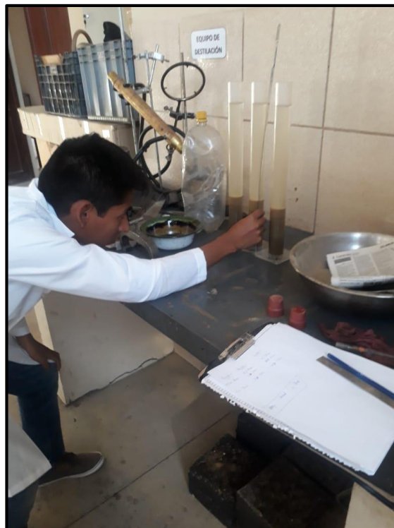
Figura 62. Mediante un embudo vierto la muestra de arena en las probetas hasta el límite que indica la probeta.
