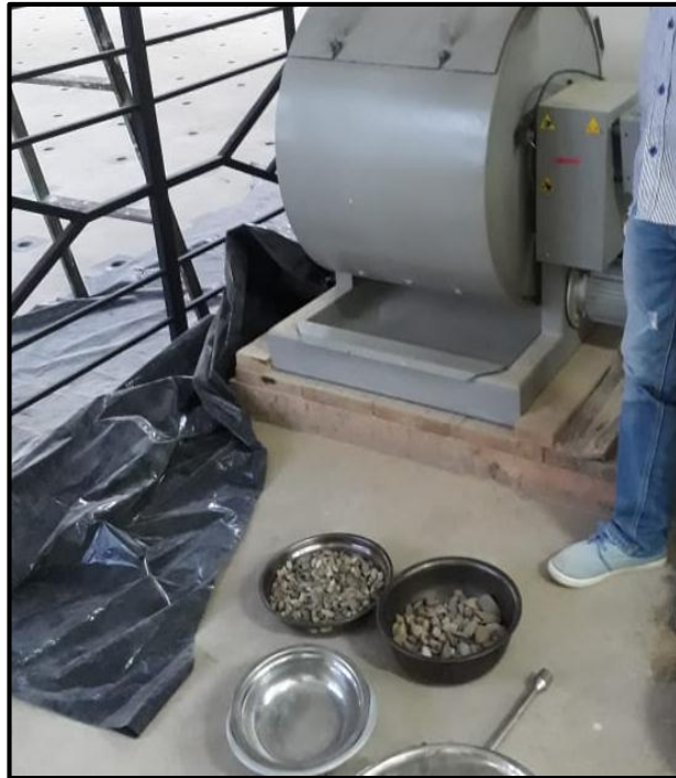
Figura 96. Máquina de los ángeles donde introducimos las muestras de las 2 bandejas.
