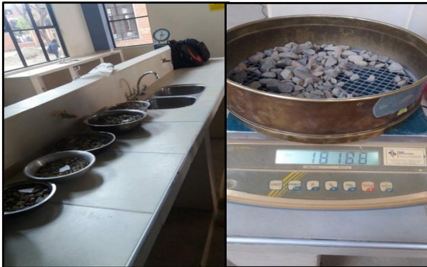
Figura 93. Tamizando la muestra por los tamices 3/4", 1/2" y 3/8"
