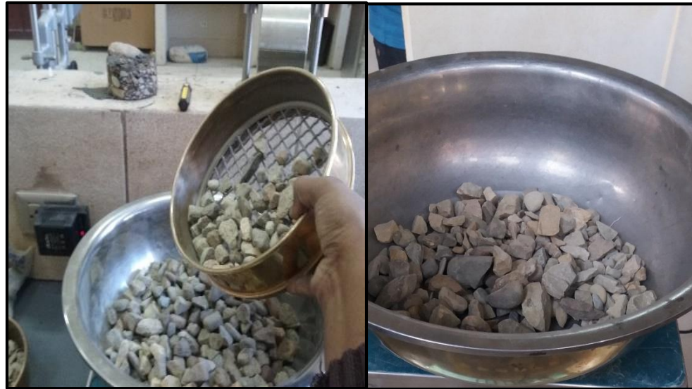
Figura 94. Vaciando en una bandeja la muestra hasta obtener un peso retenido de 2500 gr.
