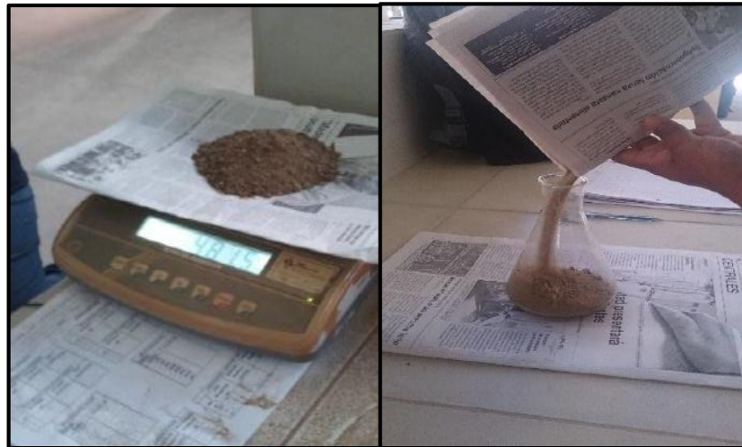
Figura 82. Obteniendo el peso de la muestra, vaciando la muestra en el matraz.
