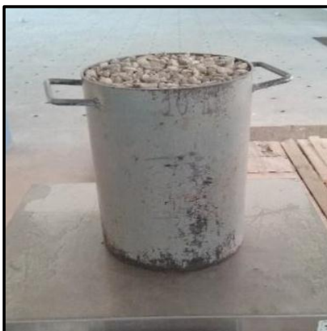
Figura 76. Enrazando con la varilla para la obtención del peso.
