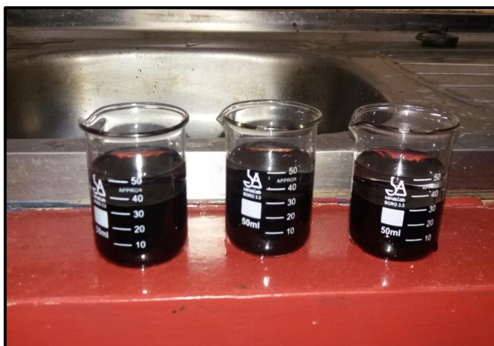
Figura 127. Luego se procede agregar el agua destilada hasta los 50 ml y se deja por 30 minutos en agua y luego procedemos a pesarlo.
