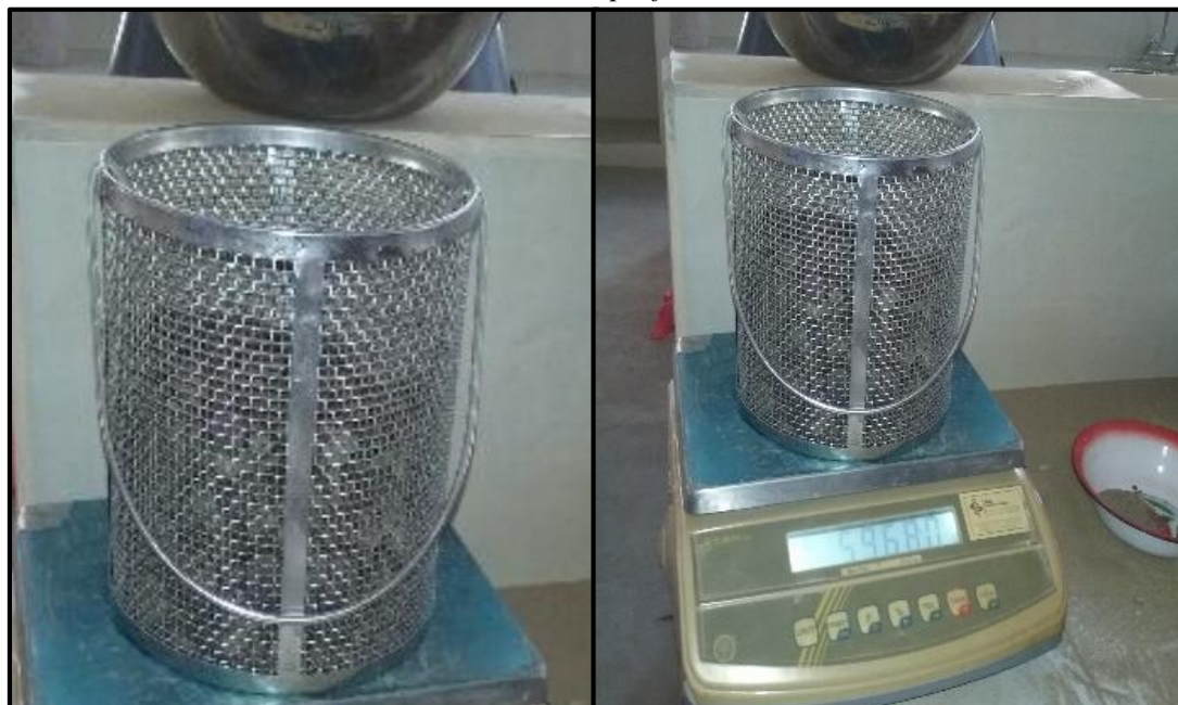
Figura 88. Introduciendo la muestra al canastillo para luego obtener el peso de la muestra saturada con superficie seca.
