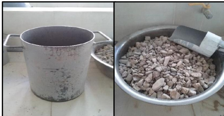
Figura 73. Materiales: molde de 10 L, varilla y la muestra de grava para realizar el ensayo.
