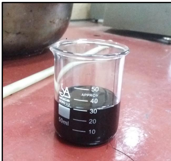
Figura 126. Se debe llenar el vaso precipitado del ligante asfáltico previamente calentado y dejarlo por 30 minutos.
