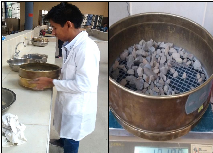
Figura 60. Tamizado a detalle la muestra para luego obtener el peso retenido en el tamiz.
