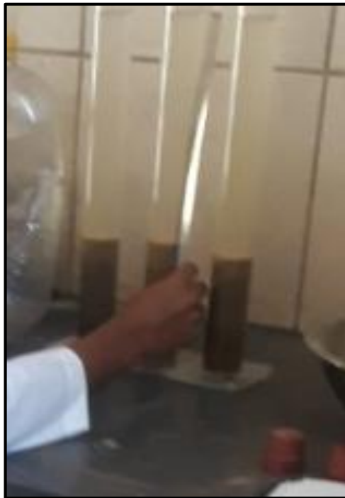
Figura 66. Llenamos con agua las 3 probetas hasta el límite superior.
