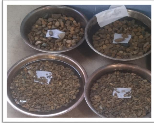
Figura B.8. Material sumergido en agua por 24 horas
