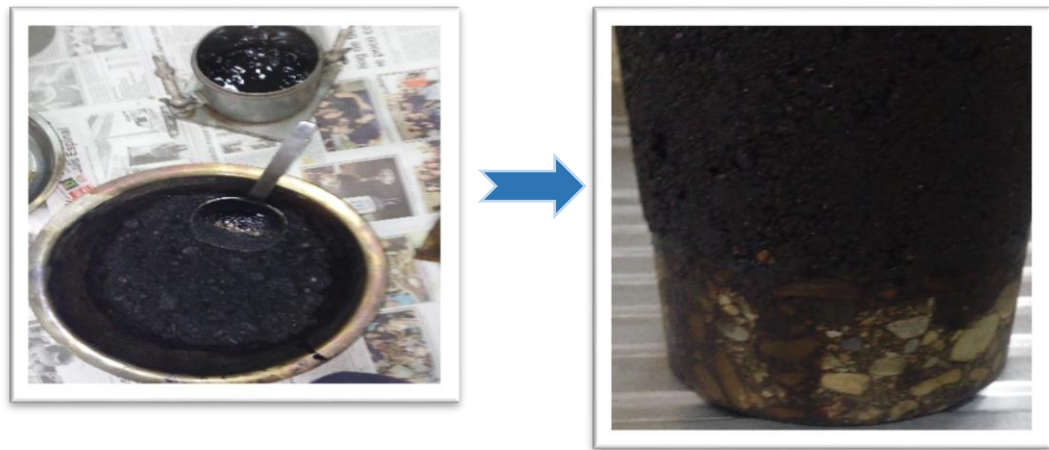
Figura E.8. Preparación de sobre carpeta asfáltica nueva a 150 °C y Testigo realizado a 150 golpes sobre carpeta asfáltica existente
