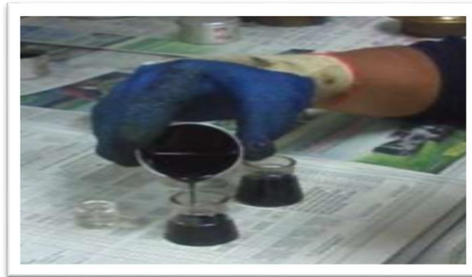
Figura C.22. Vertido de cemento asfáltico
