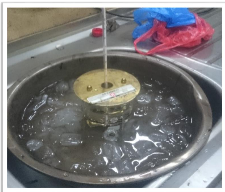
Figura C.18. Proceso para bajar la temperatura a 4°C
