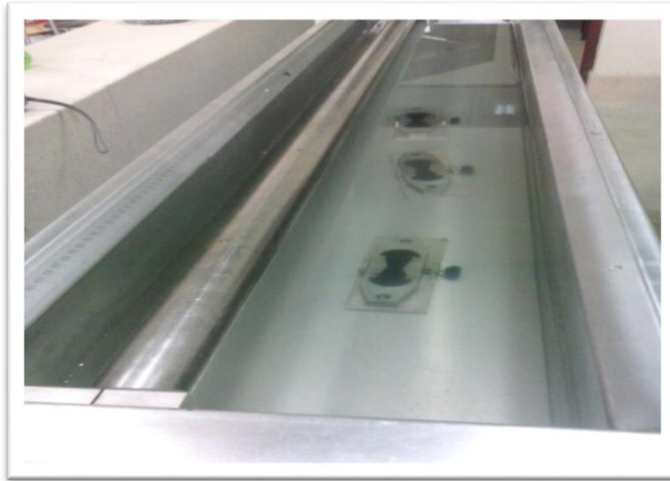
Figura C.10. Muestras sumergidas en baño maría a 25°C
