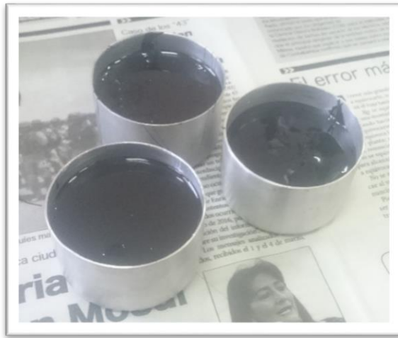
Figura C.3. Vertido del cemento asfáltico en las cápsulas
