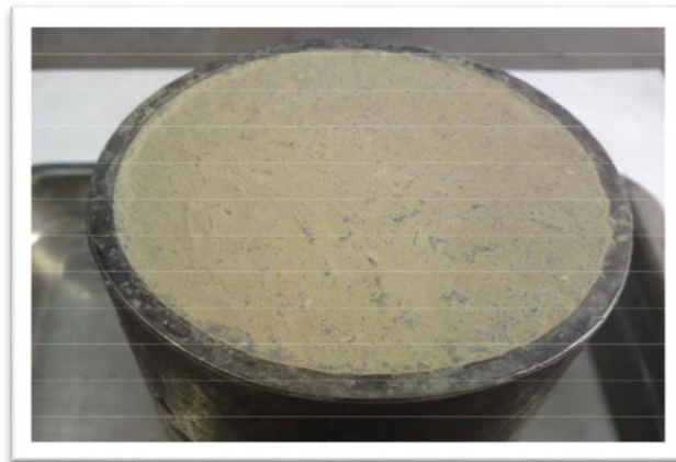
Figura 2.12. Extensión del filler en probetas circulares
