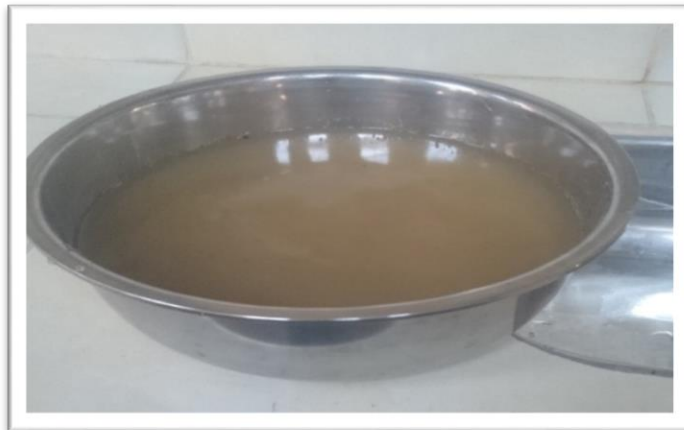
Figura B.16. Preparado e inmersión de la muestra por 24 horas
