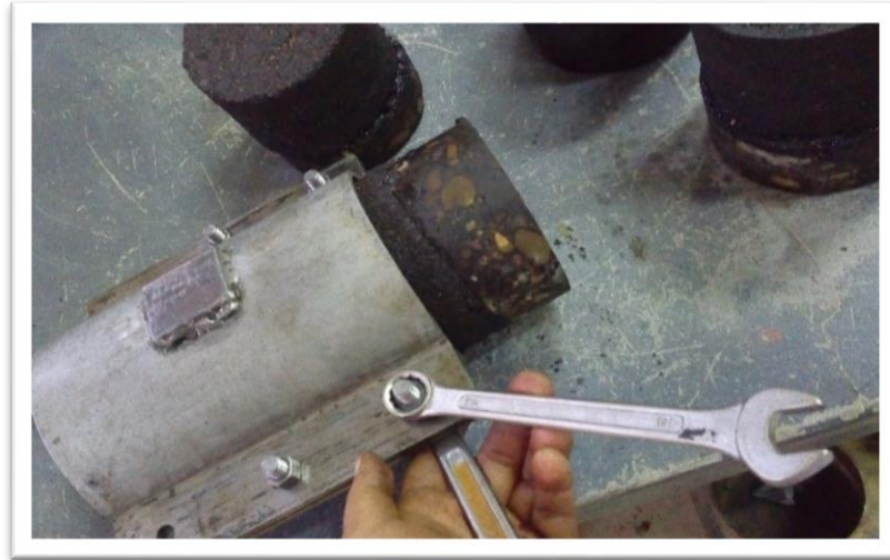
Figura E.14. Testigo colocado de tal forma que quede a 10 mm de cada borde de la mordaza ajustados con pernos del molde
