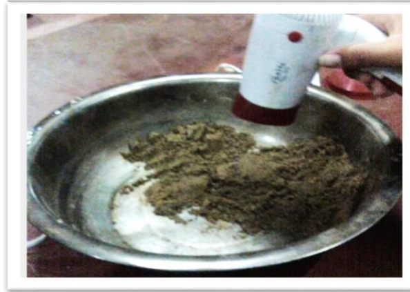
Figura B.17. Secado superficialmente con la secadora
