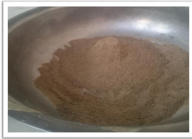
Figura B.19. Verificación de la condición de saturado con superficie seca
