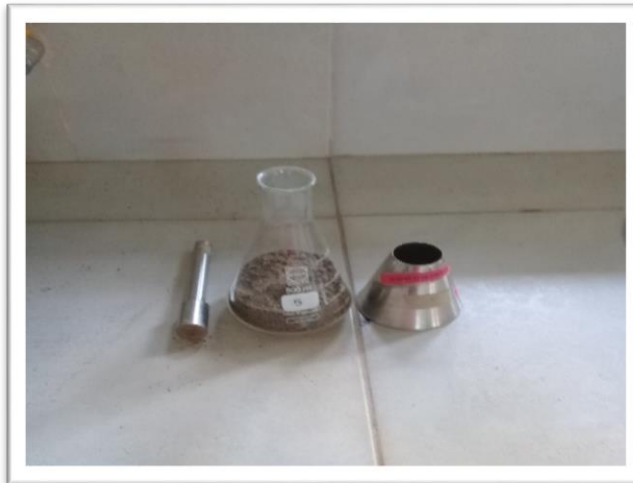
Figura B.20. Determinación del peso de la muestra + matraz
