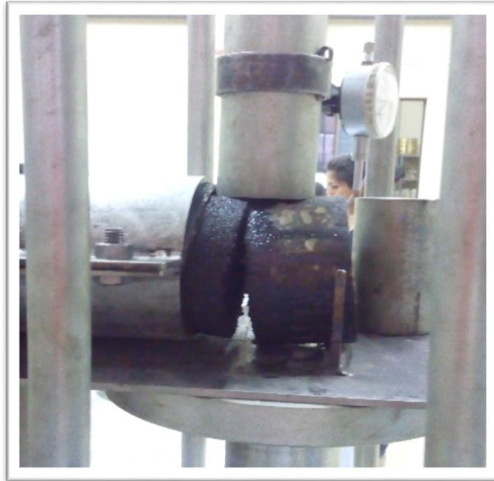
Figura E.16. Deslazamiento entre una capa y otra hasta alcanzar la deformación máxima
