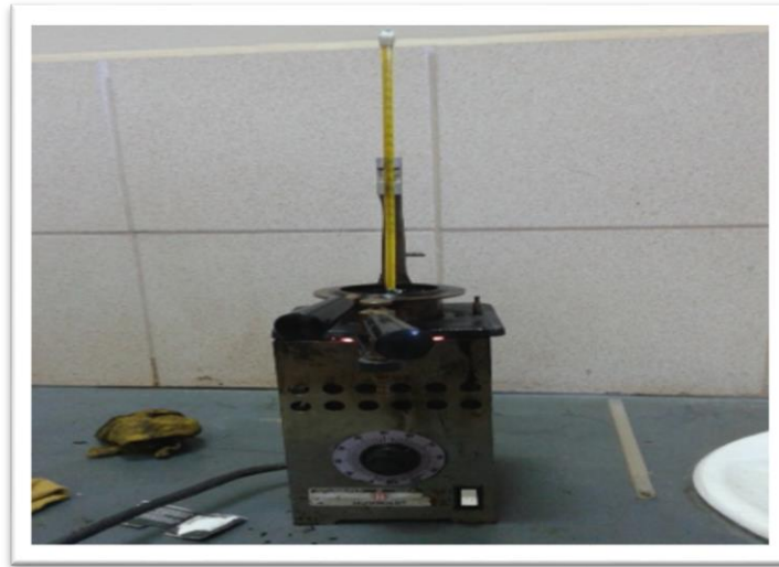
Figura C.13. Proceso de calentamiento del material bituminoso y control de la temperatura
