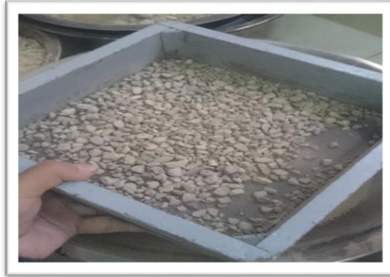
Figura B.36. Tamizado del material en el Tamiz N° 12
