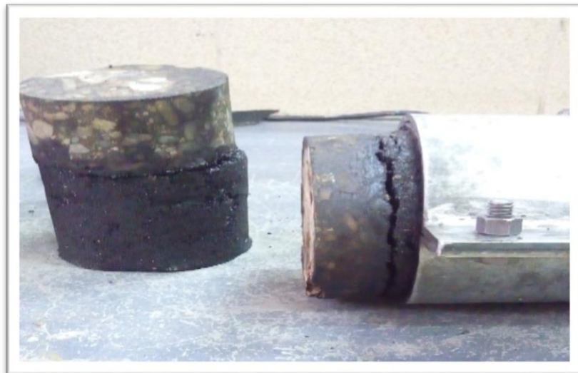
Figura E.15. Testigo sometido a evaluación de adherencia a temperatura ambiente a través de Ensayo de corte LCD
