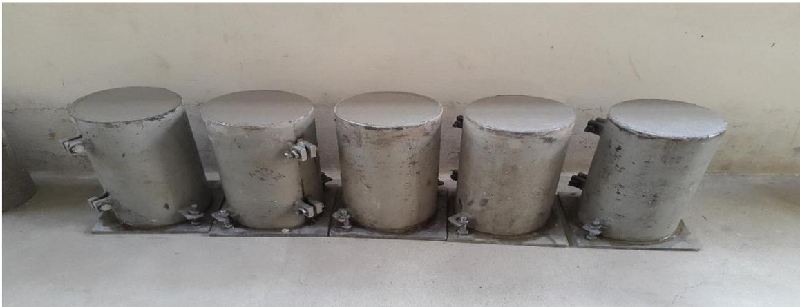
Imagen N°2: Esquema para Ensayar Cilindros de Hormigón a Compresión.
