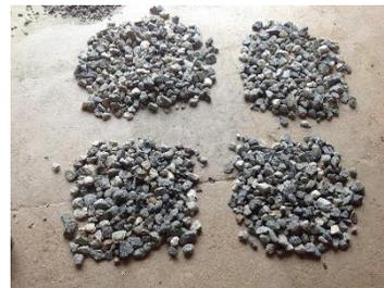
Imagen N°3: Método de Cuarteo del Material de Grava
