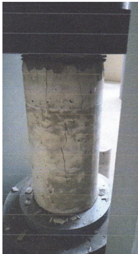
Figura 2. Rotura a compresión de probetas
