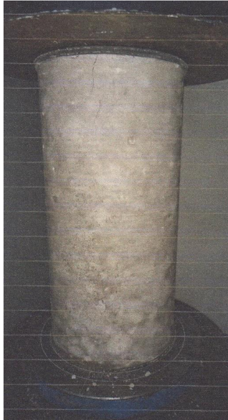
Figura 3. Rotura a compresión de probetas
