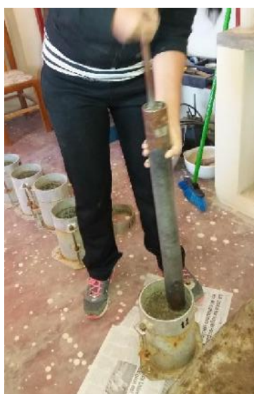
Figura 3.6. Proceso de compactación
