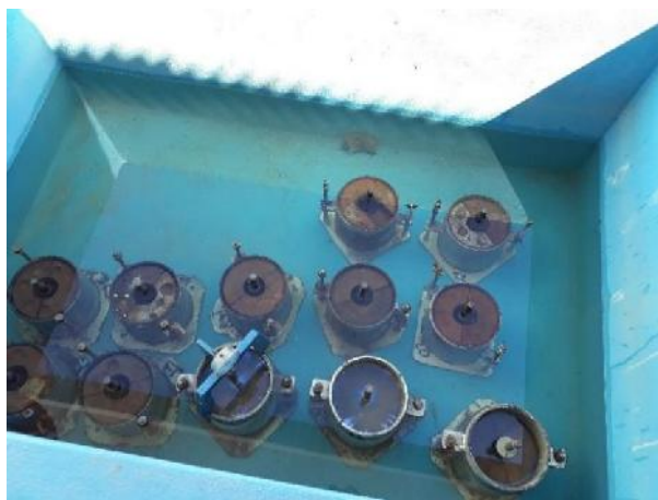
Figura 3.7. Moldes de C.B.R. con muestra en saturación
