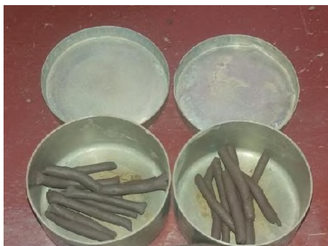
Figura 3.5. Ensayo del límite plástico
