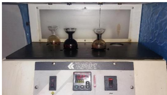
Figura 3.9. Determinación de la viscosidad Saybolt - Furol
