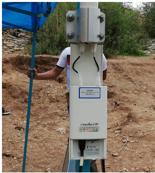
Fotografía 4.8. Radio Rocket M5 conectada.
