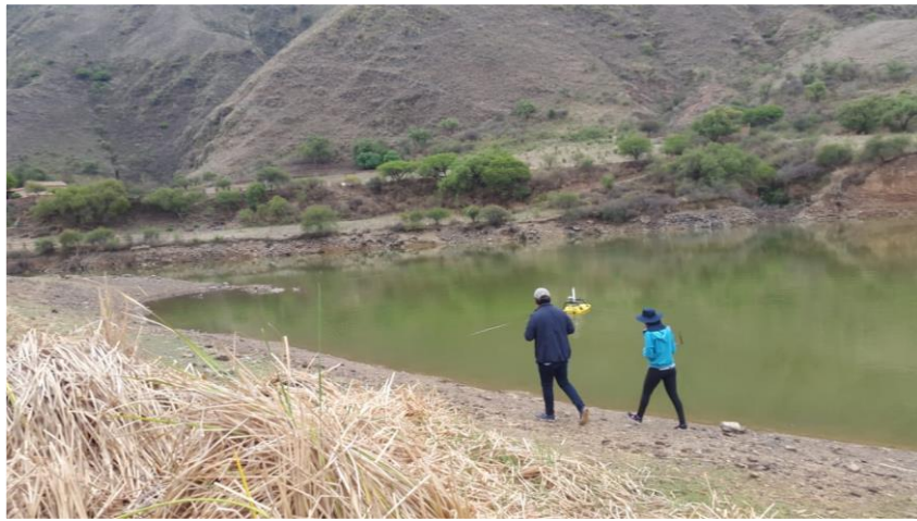
Fotografía 4.5. Conducción del Q-Boat a través del embalse.
