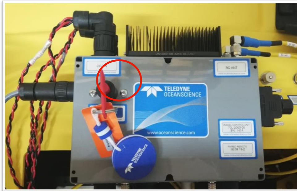
Fotografía 3.1. Llave de encendido del ADCP.
