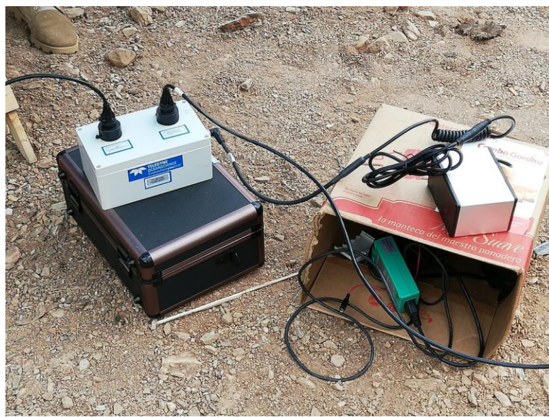
Fotografía 4.7. Conexión de la batería a la radio Rocket M5.
