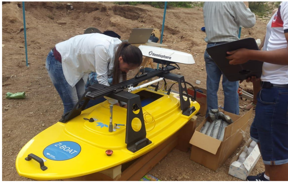
Fotografía 4.6. Conexión de los instrumentos al Z-Boat.
