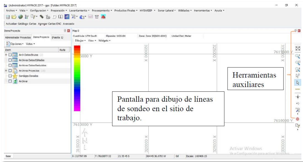
Figura 3.30. Pantalla para dibujo de líneas de sondeo y herramientas auxiliares. Fuente: Metodología para levantamiento batimétrico utilizando Hypack.
