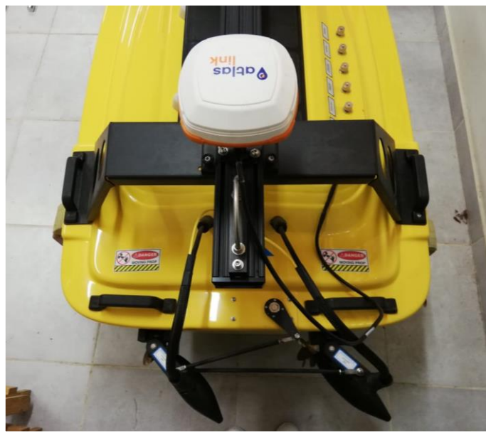
Fotografía 4. GPS montado en Q-Boat 1800.
