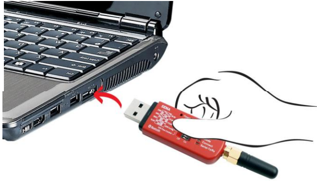
Figura 2-2 Conexión de un dispositivo serie a Parani -SD1000U
