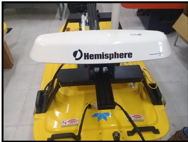
Fotografía 2. Vector V320 montado en Z-Boat 1800.
