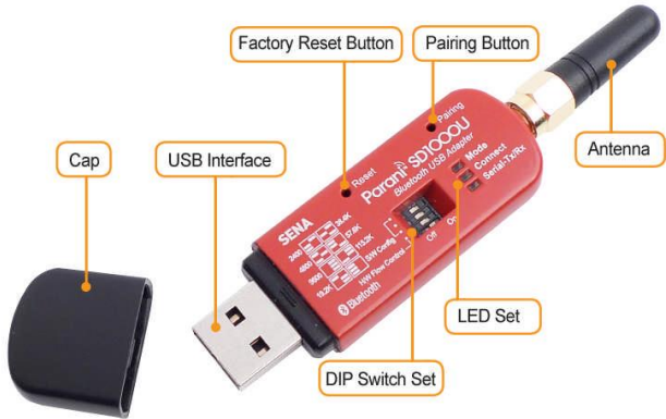
Figura 2-1. El diseño del panel de Parani-SD1000U.
