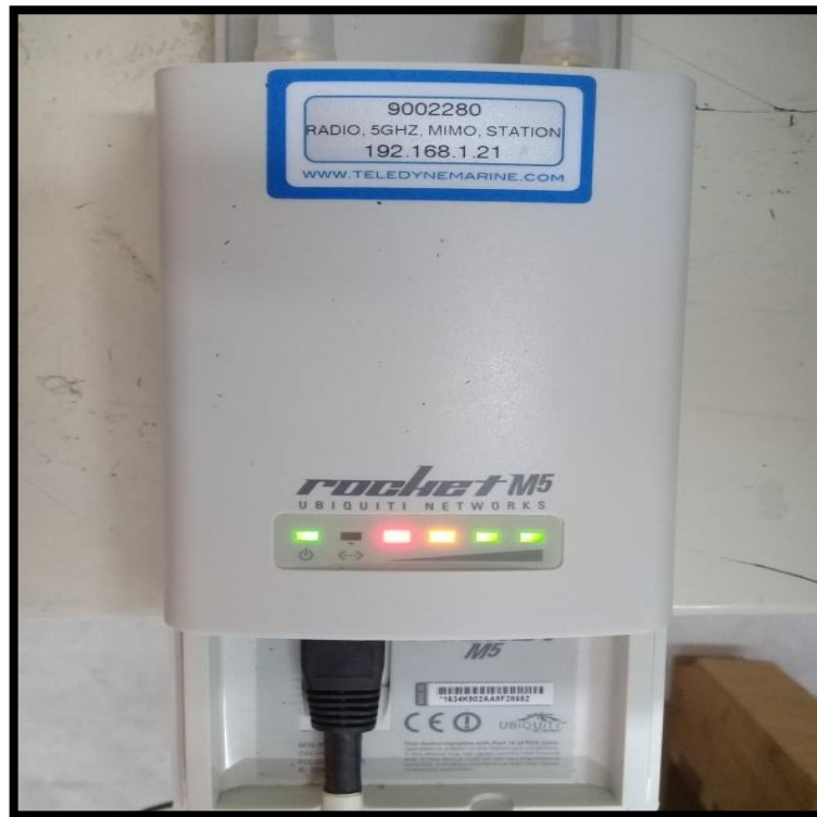
Fotografía 3. Verificación de recepción de señal de los sensores del Z-Boat en la antena
