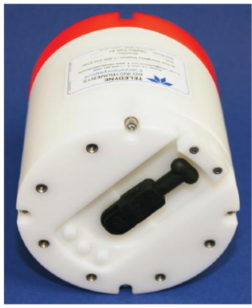
Figura 2. ADCP RiverPro 1200-I lado posterior
