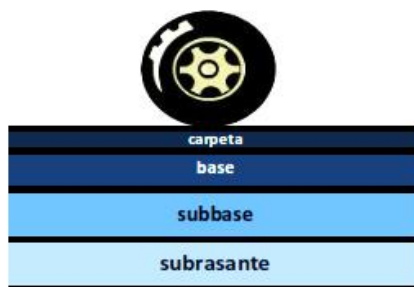
Figura 2.1 - Paquete estructural pavimento flexible
