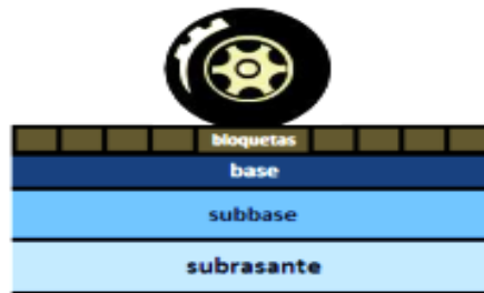
Figura 2.3 - Paquete estructural pavimento articulado
