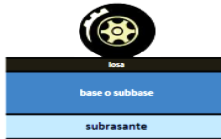
Figura 2.2 - Paquete estructural pavimento rígido
