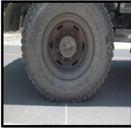
Fotografía 8 - Volqueta de 8 m 3 de capacidad con eje trasero simple de llantas dobles
