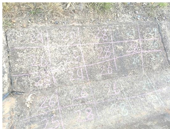
Figura 3.23 Disparos del esclerómetro
