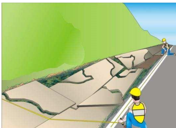
Figura 2.14 Fracturamiento de la cuneta
