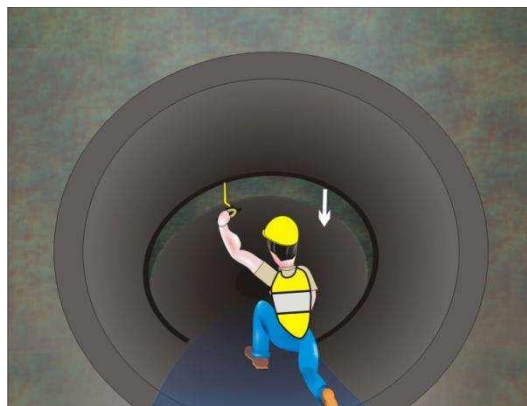
Figura 2.24 Hundimiento o aplastamiento
