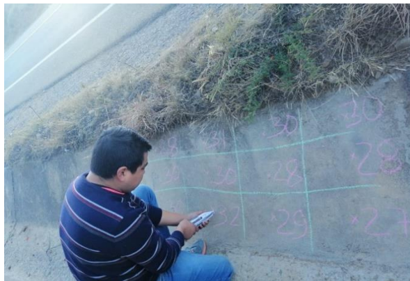
Figura 3.22 Disparos del esclerómetro
