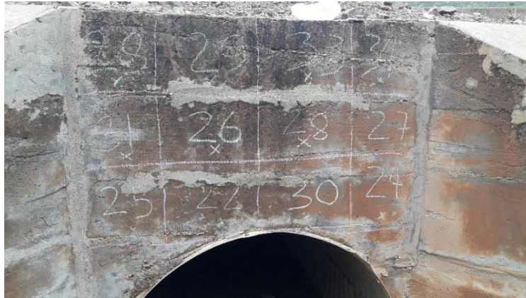
Figura 3.17 Disparos del esclerómetro
