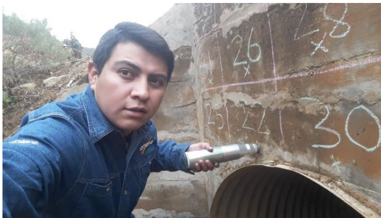
Figura 3.18 Marcación y disparos con el esclerómetro
