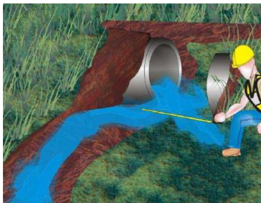
Figura 2.23 Separación de sección de tubería
