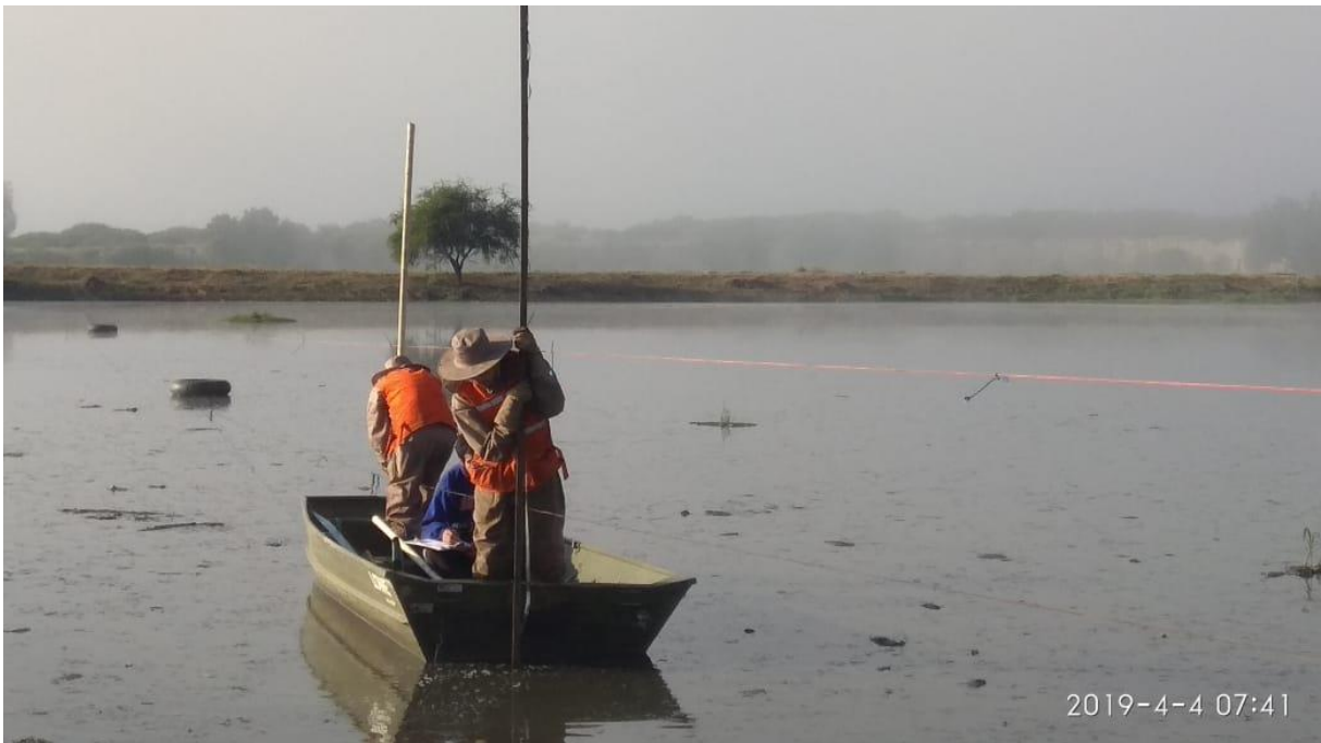
Fotografía N° 10: Toma de mediciones batimétricas simultánea en dos puntos de la sección transversal de la laguna anaeróbica 2
