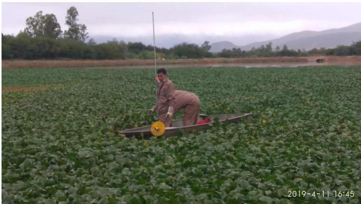
Fotografía N° 11: Mediciones batimétricas por trabajadores de la Empresa “SYL INGENIEROS” en puntos aleatorios de la laguna anaeróbica 1 dentro el sector de algas
