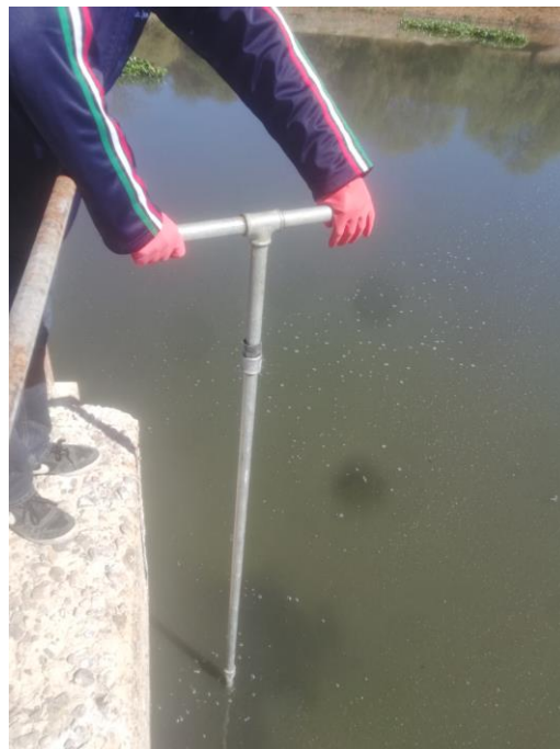
Fotografía N° 12: Sacamuestras introducido con giros durante el proceso en la laguna anaeróbica 1
