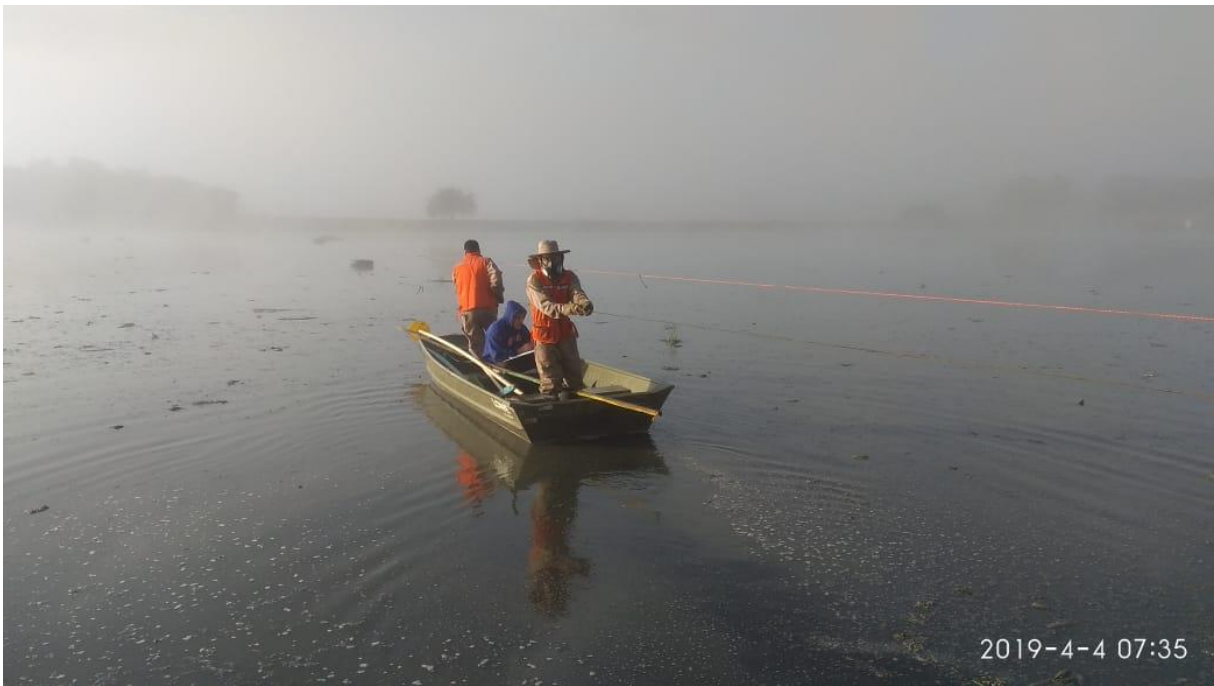
Fotografía N° 10: Toma de mediciones batimétricas simultánea en dos puntos de la sección transversal de la laguna anaeróbica 2
