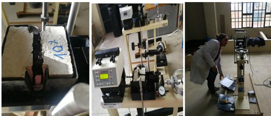
Figura 3.32 Ensayo de adherencia de los selladores
