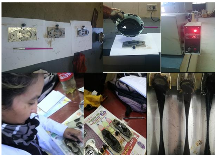
Figura 3.19 Procedimiento del ensayo de ductilidad
