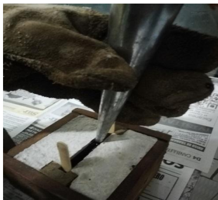
Figura 3.30 Colocado del sellador a juntas
