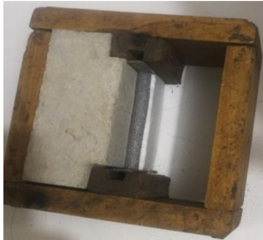
Figura 3.23 Preparado de la losa para vaciar el sellador
