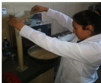
Figura 3.5 Adicionando la arena a las probetas
