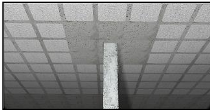
FIGURA 4.2 Losa reticular con casetones no recuperables
