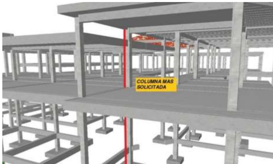
Figura 3.25 Columna más solicitada, Fuente: Elaboración Propia.
