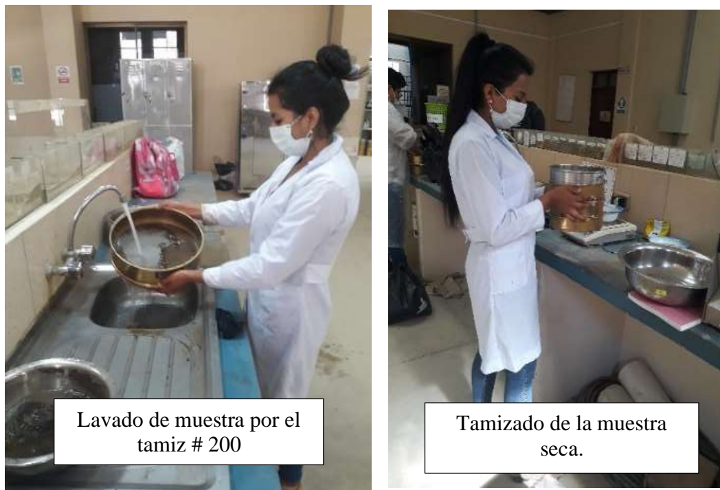
Figura 3.13. Esquema de realización del ensayo granulométrico mediante lavado
