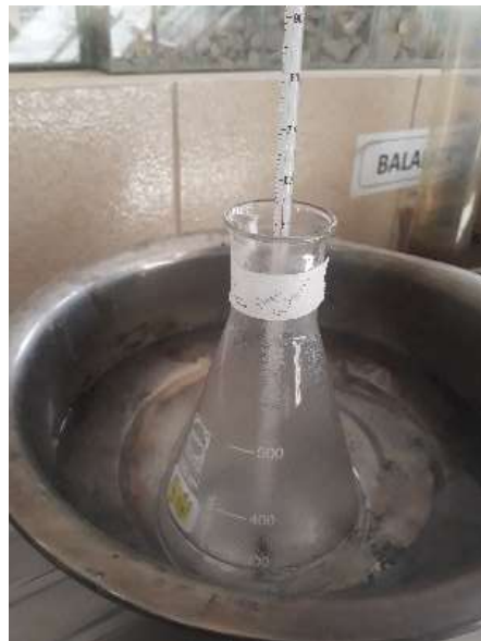
Figura 3.17. Esquema de la realización del ensayo de gravedad específica de los sólidos de un suelo (calibración de los frascos volumétricos)
