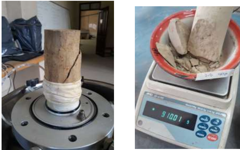
Figura 4.14. Esquema de remoción del espécimen al finalizar el ensayo UU
