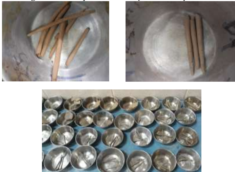
Figura 3.16. Esquema del ensayo de límite plástico
