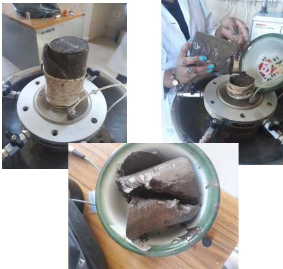
Figura 4.10. Esquema del retiro del espécimen al concluir el ensayo CU.
