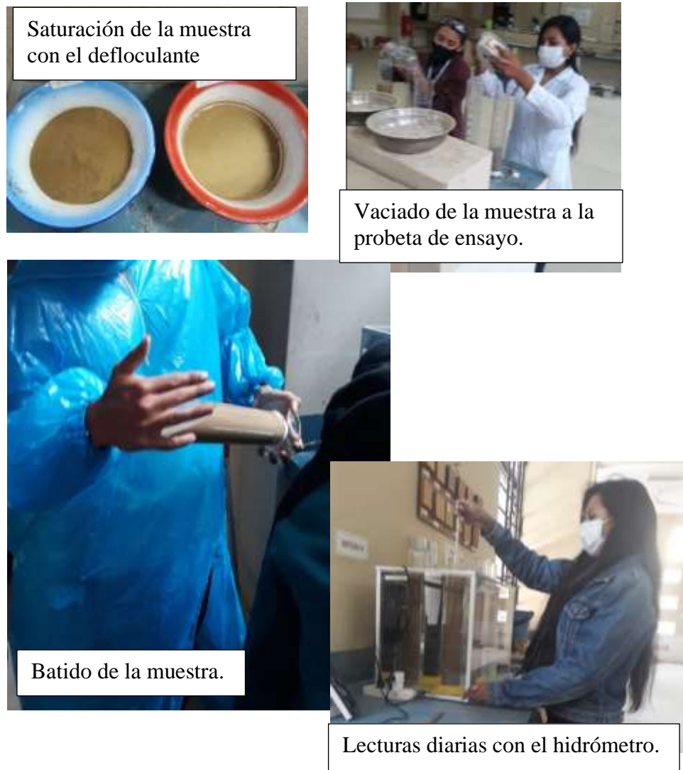
Figura 3.14. Esquema de realización del ensayo de granulometría por hidrómetro
