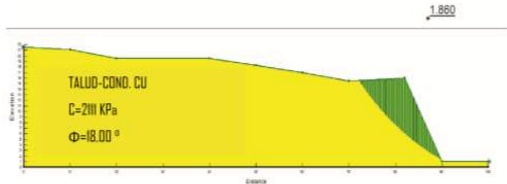
Figura 4.26. Factor de seguridad del talud – ensayo CU
