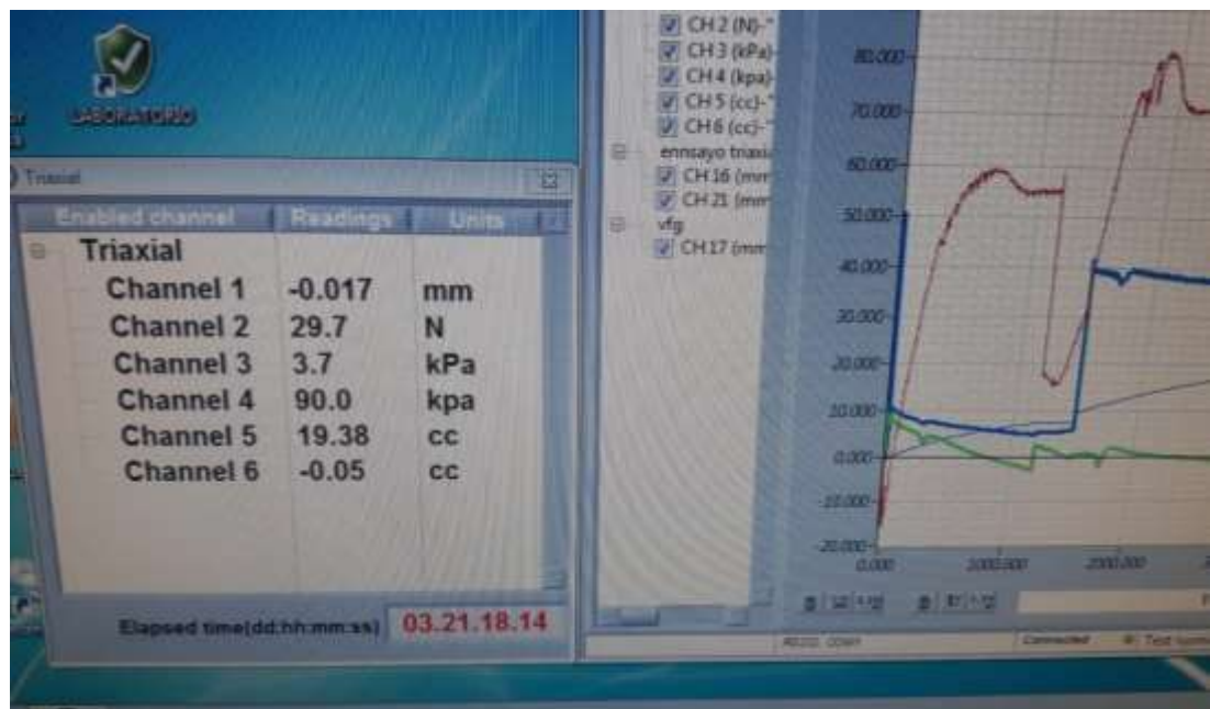
Figura 4.9. Canales mostrados en el ordenador del triaxial generados por el DATACOMM (Especimen 1 Punto 2)
