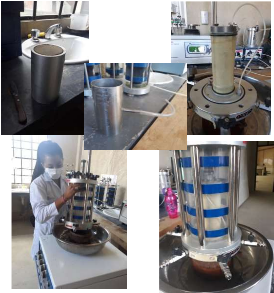
Figura 4.5. Esquema del montaje de la muestra en la celda
