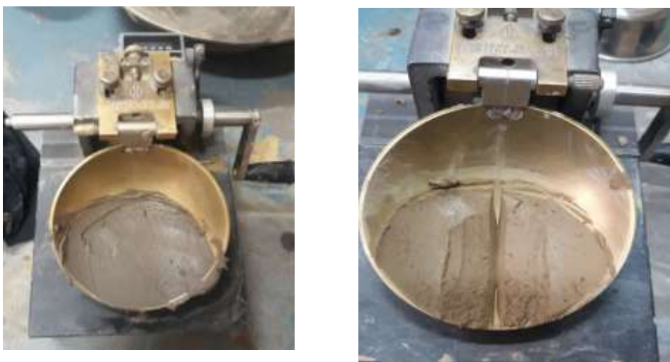
Figura 3.15. Esquema de realización del ensayo de límite líquido
