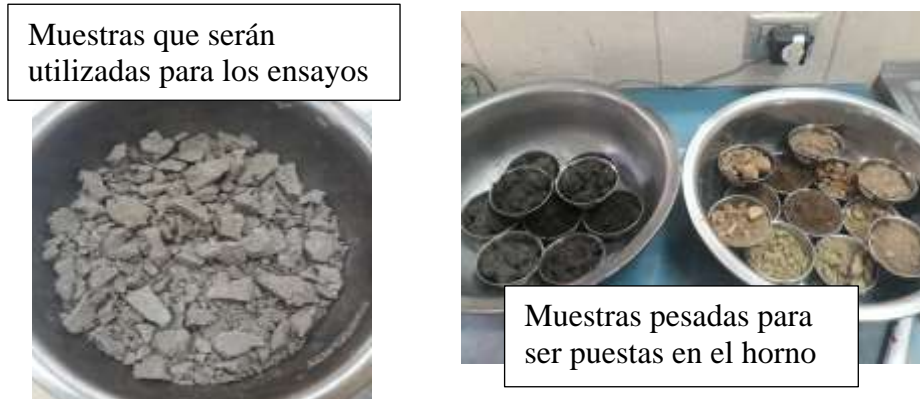
Figura 3.12. Esquema de la realización del ensayo de contenido de humedad
