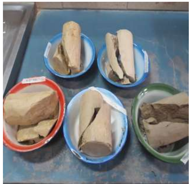
Muestras llevadas al horno para controlar su humedad.
