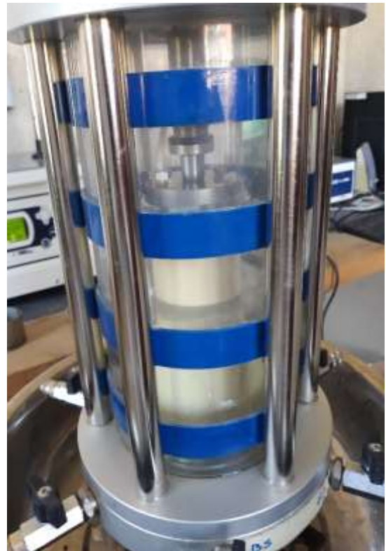
Colocado de la celda y llenado de agua
