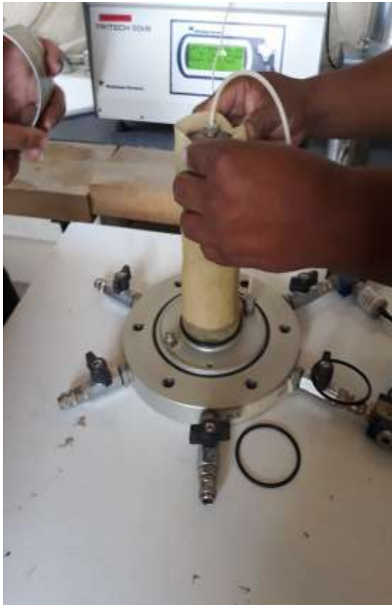
Armado de la muestra en la base de la celda triaxial
