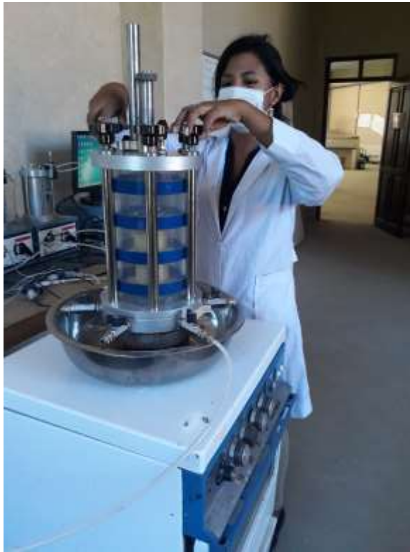
Colocado de la celda y llenado de agua
