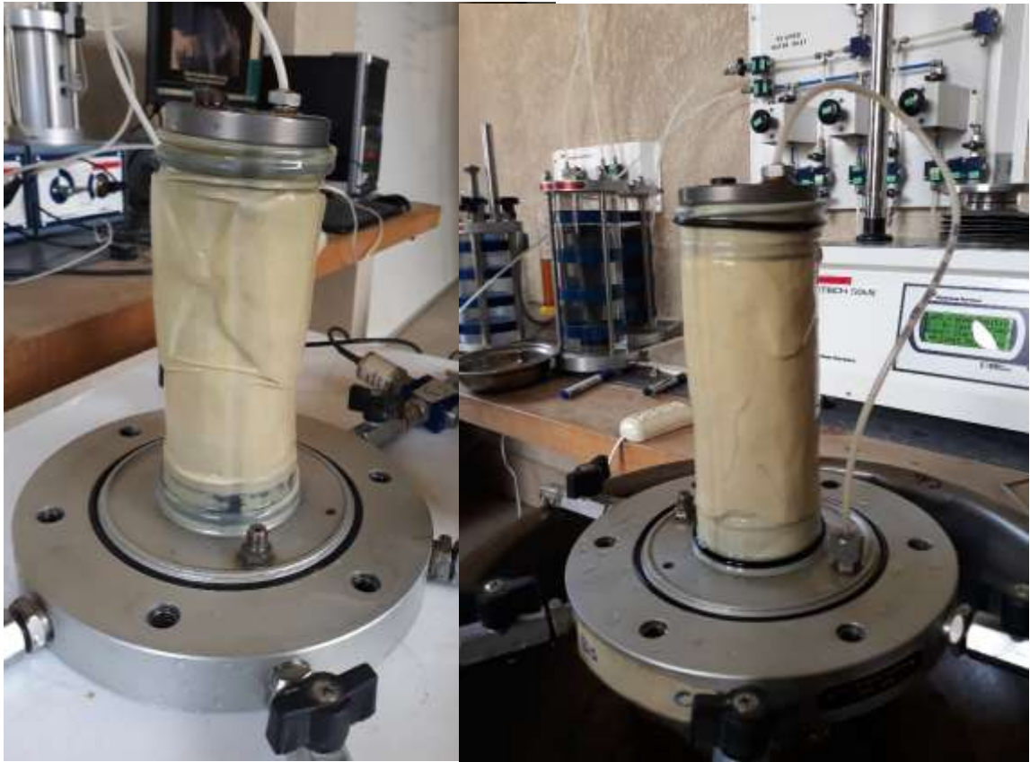
Probetas con membrana latex despues del ensayo
