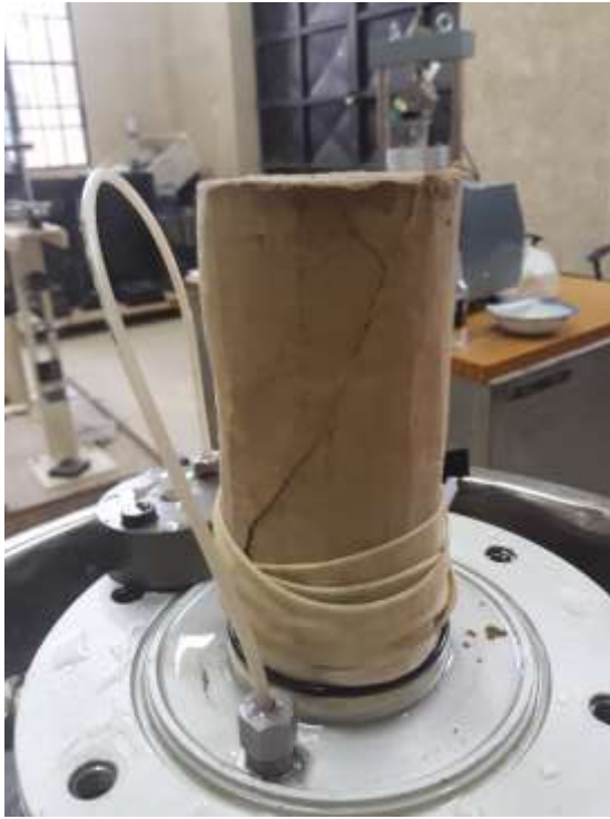
Probetas fisuradas después de los ensayos en la base de la celda triaxial
