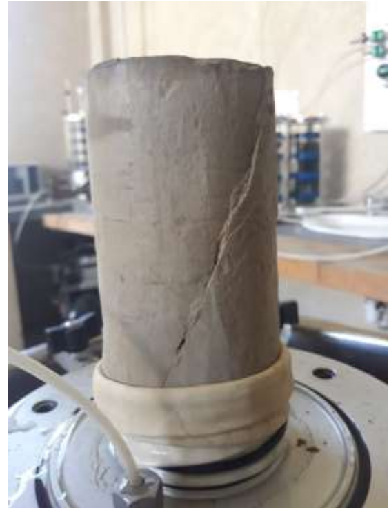
Probetas fisuradas después de los ensayos en la base de la celda triaxial
