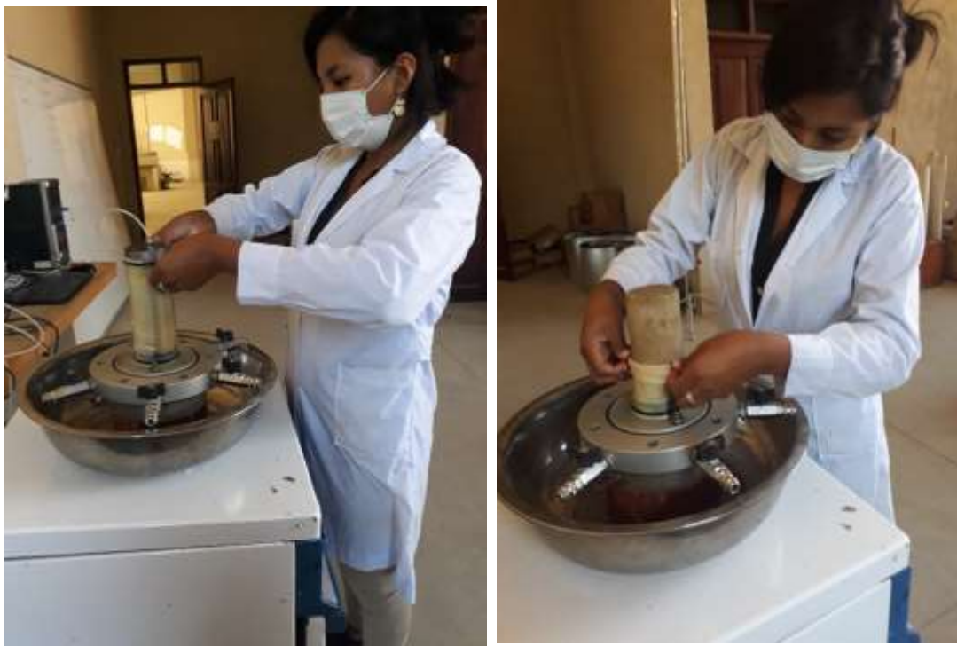
Remoción de la membrana y oring's concluido el ensayo
