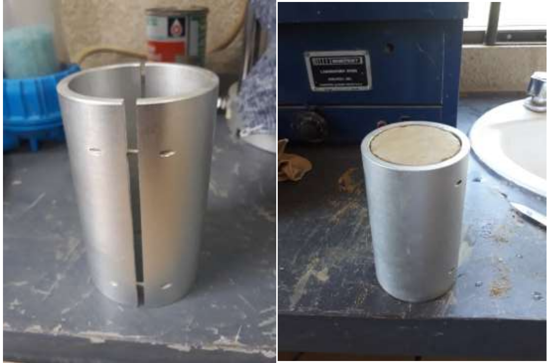
Muestra enrasada para llevar a cabo el ensayo
