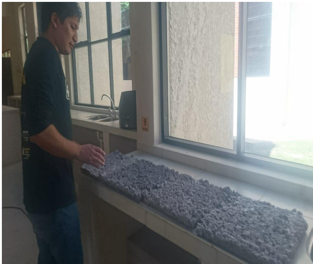
Imagen 3. 27 Losas de hormigón poroso
