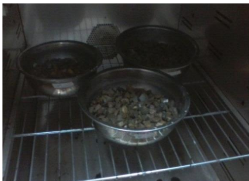
Imagen 3. 12 Secado de la muestra en el horno.
