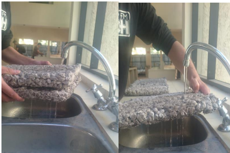
Imagen 3. 28 Prueba de permeabilidad
