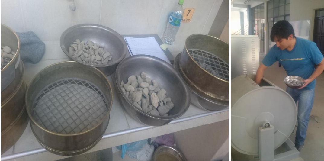
Imagen 3. 7 Pesar los materiales retenidos en las cantidades del método que corresponden
