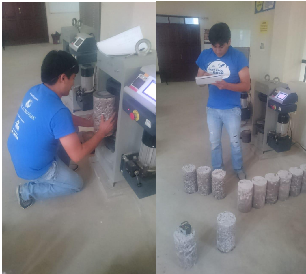
Imagen 3. 23 Ensayo de compresión
