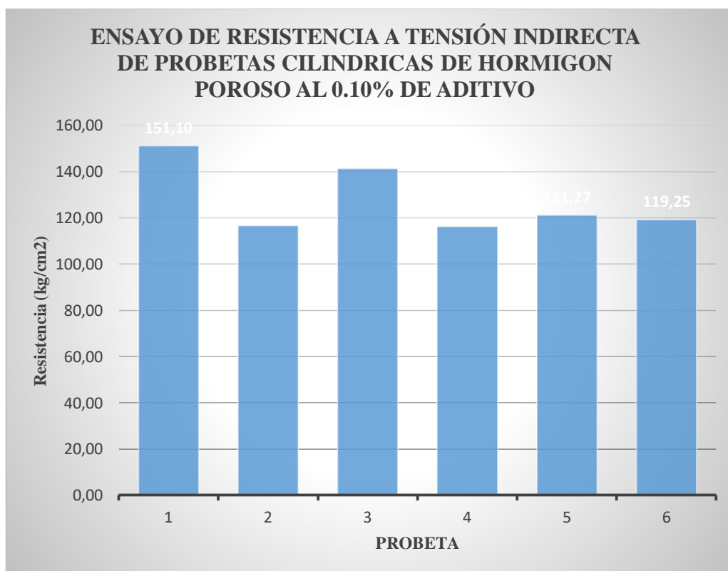
Gráfica 3. 25 Ensayo de Resistencia a tensión indirecta de hormigón poroso con 0.10 % de aditivo
