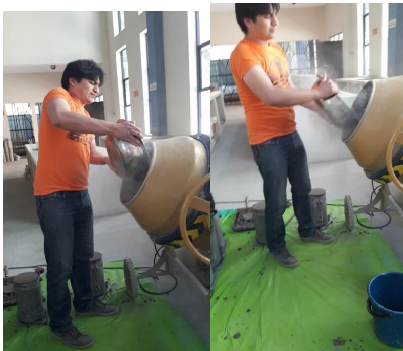
Imagen 3. 21 Muestra de mezclado del concreto permeable
