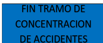
Figura N° 63. Señalización fin de tramo de concentración de accidentes TCA 4
