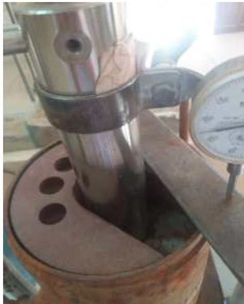
Figura 3.16: Rotura de probetas
