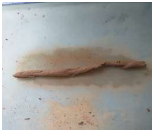
Figura 3.8: Ensayo del límite plástico
