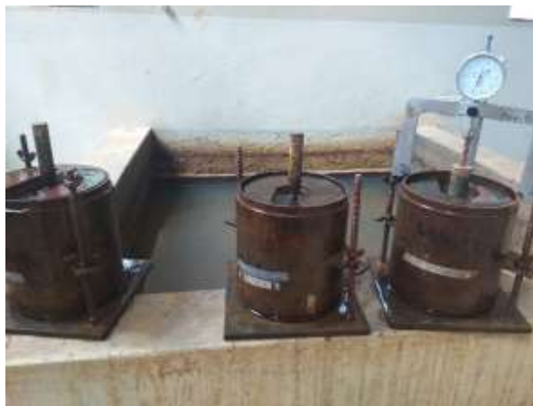
Figura 3.15: Lectura de los moldes con el extensómetro
