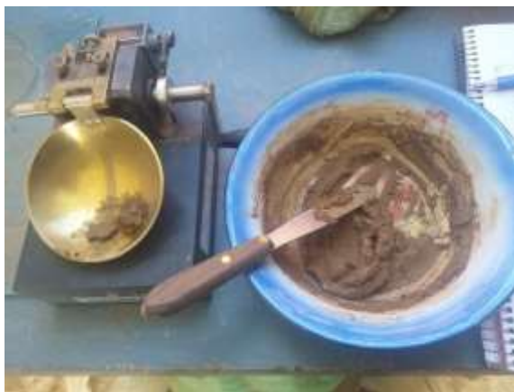
Figura 3.7: Ensayo del límite líquido
