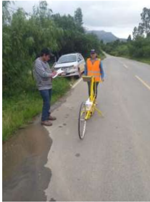
Figura 3.23: Medición de la rugosidad con el rugosímetro de Merlín
