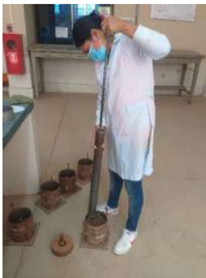
Figura 3.12: Compactación de los moldes
