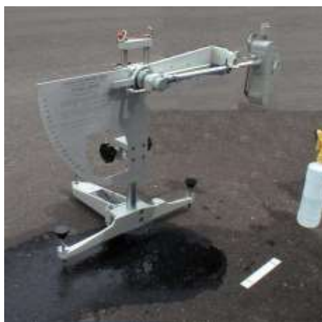
Figura 2.12: Péndulo de fricción británico
