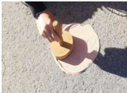
Figura 3.25: Dispersión de la arena sobre la superficie
