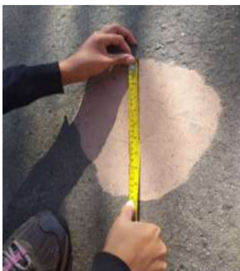
Figura 3.26: Medición y registro del diámetro de área cubierta
