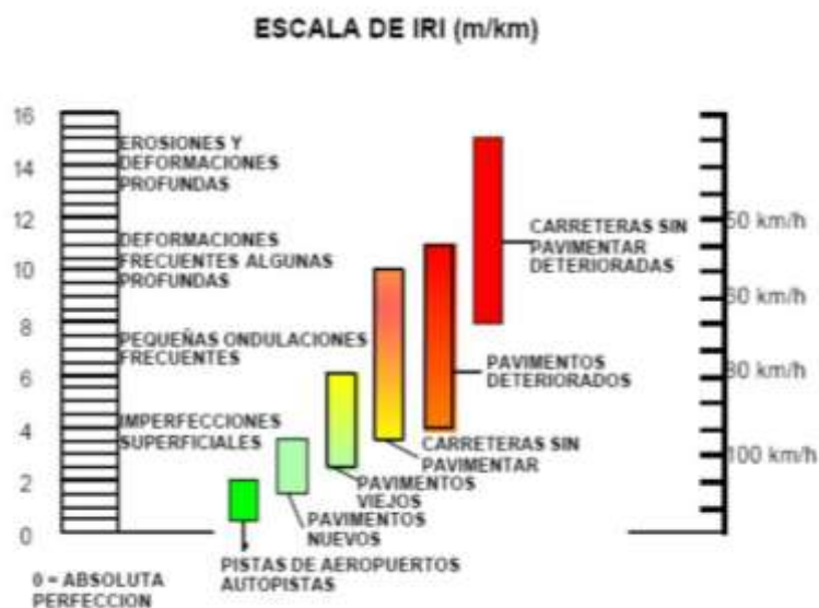
Figura 2.10: Escala de clasificación del IRI
