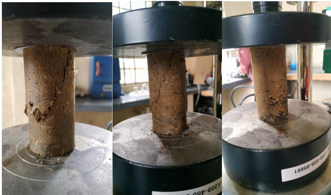
Molde ensayado a compresión
