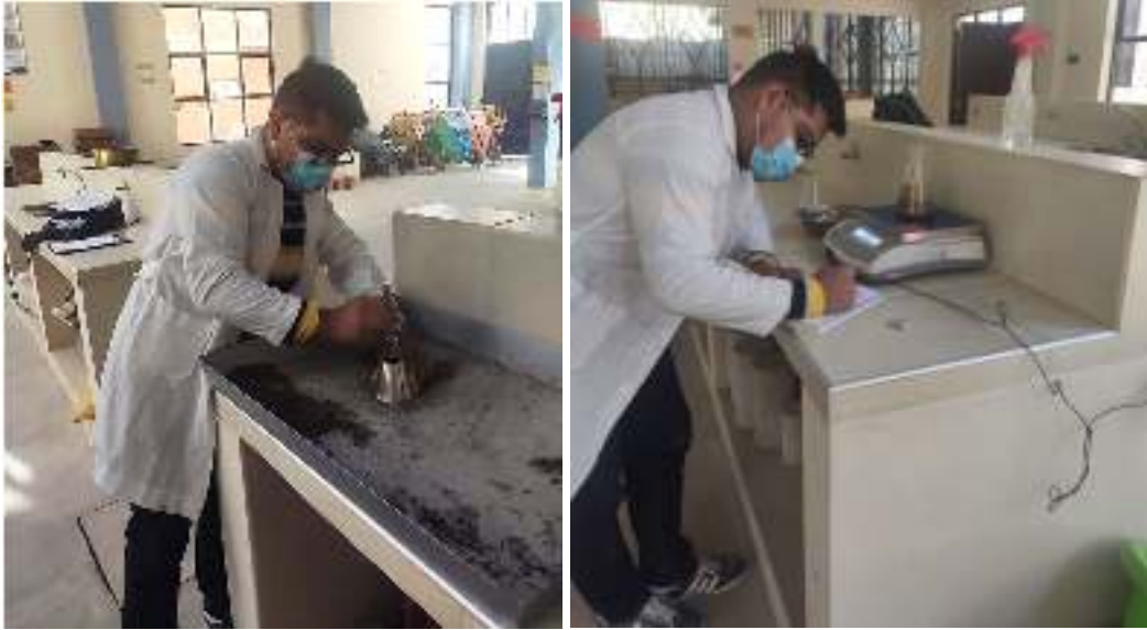
Ilustración N° 36 Preparación del agregado fino para ensayo de peso específico
