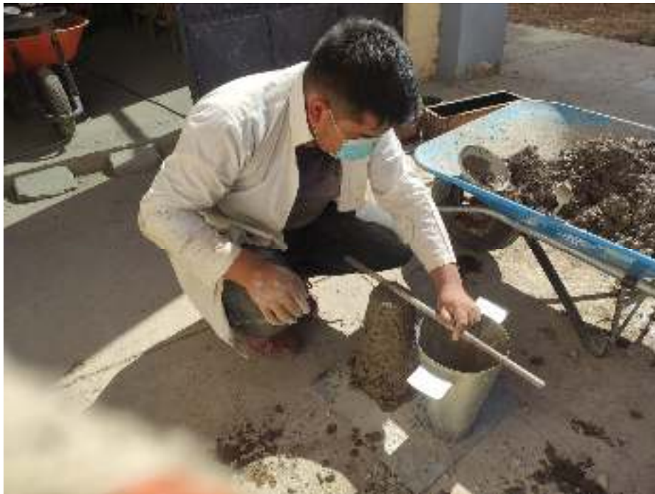
Ilustración N° 53 Medición de asentamiento en hormigón fibroso al 1.4%
