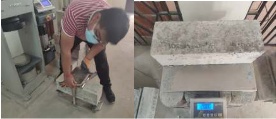
Ilustración N° 60 Pesado y acomodado de viga para ensayo a flexión.
