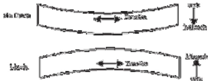
Ilustración N° 6 Alabeo causado por cambios de humedad.
