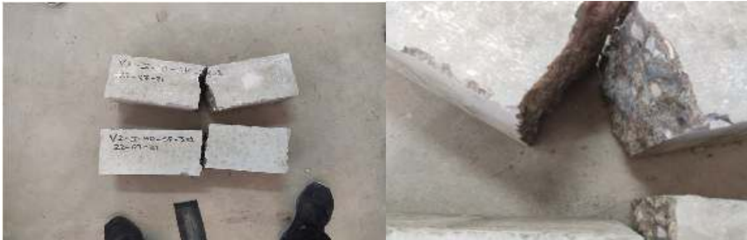
Ilustración N° 62 Rotura de vigas con hormigón de alta resistencia.
