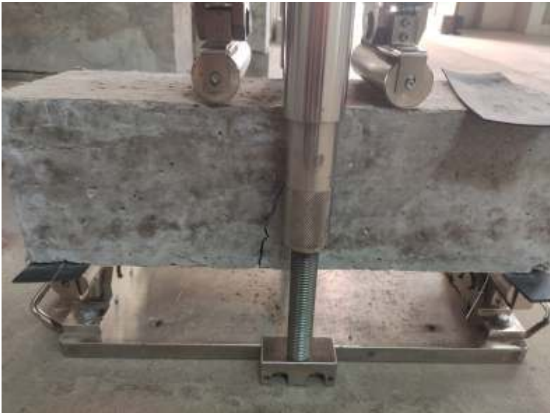
Ilustración N° 61 Rotura de viga prismática con fibra al 1.4%
