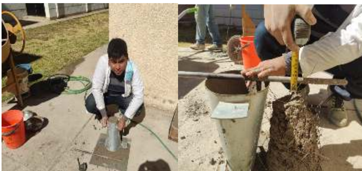
Ilustración N° 51 Medición del asentamiento a hormigón fibroso
