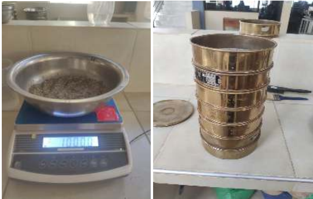
Ilustración N° 30 Pesado de material fino
