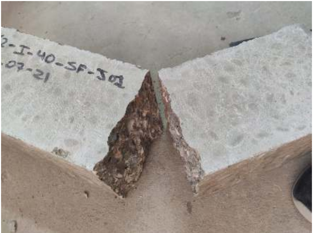
Ilustración N° 55 Rotura de viga prismática con hormigón convencional
