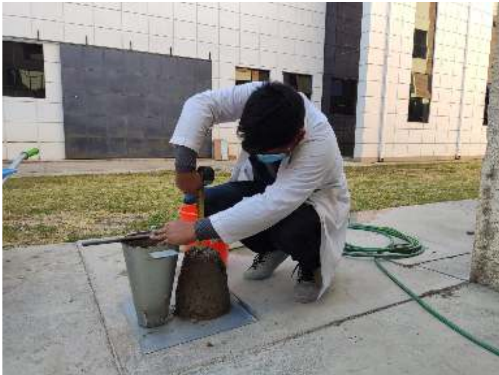
Ilustración N° 50 Medición del asentamiento
