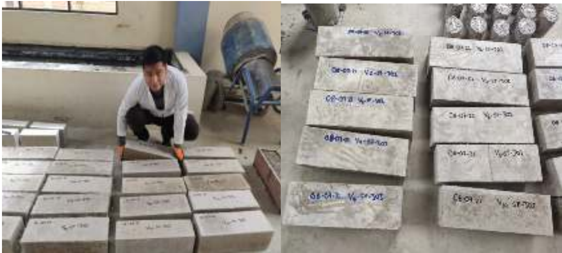
Ilustración N° 54. Vigas prismáticas con hormigón convencional
