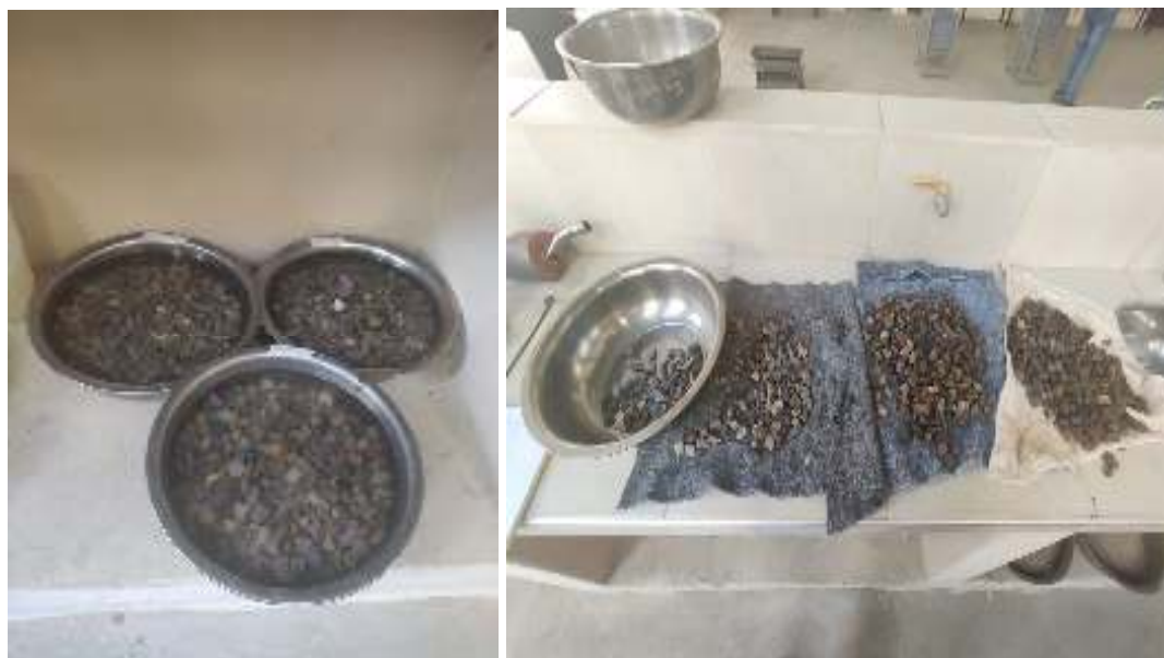
Ilustración N° 34 Preparación del agregado grueso para ensayo de peso específico
