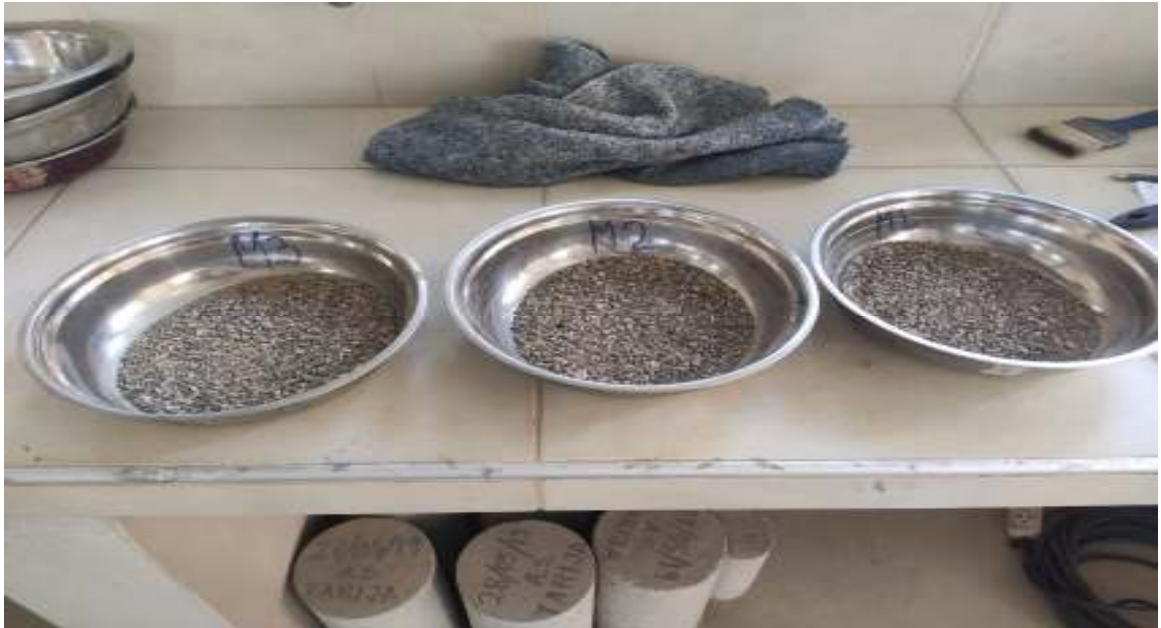
Ilustración N° 43 Muestras de agregado fino para ensayo de contenido de humedad
