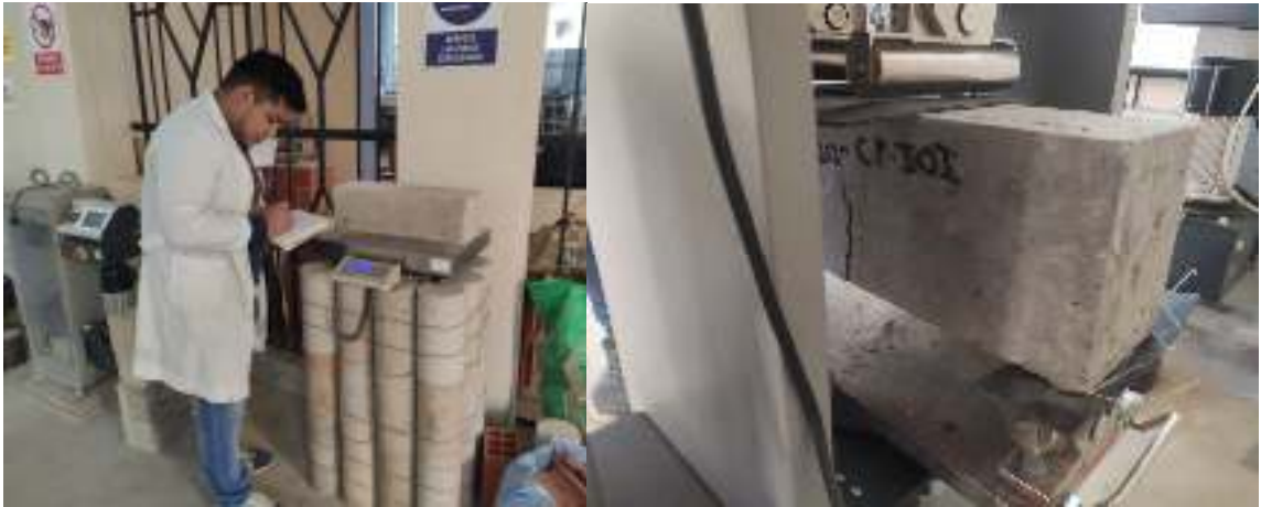
Ilustración N° 56 Pesado y rotura de vigas con fibras al 0.6%
