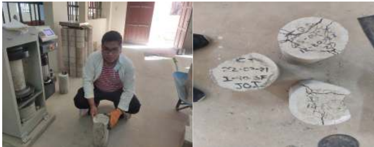
Ilustración N° 64 Rotura de muestras cilíndricas con hormigón de alta resistencia
