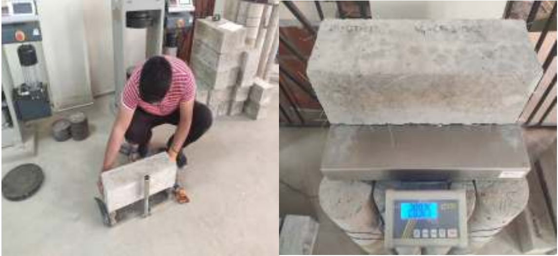
Ilustración N° 58 Pesado y posicionamiento de la viga a ser ensayada
