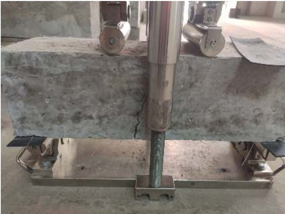
Ilustración N° 59 Rotura de viga con fibra al 1 %
