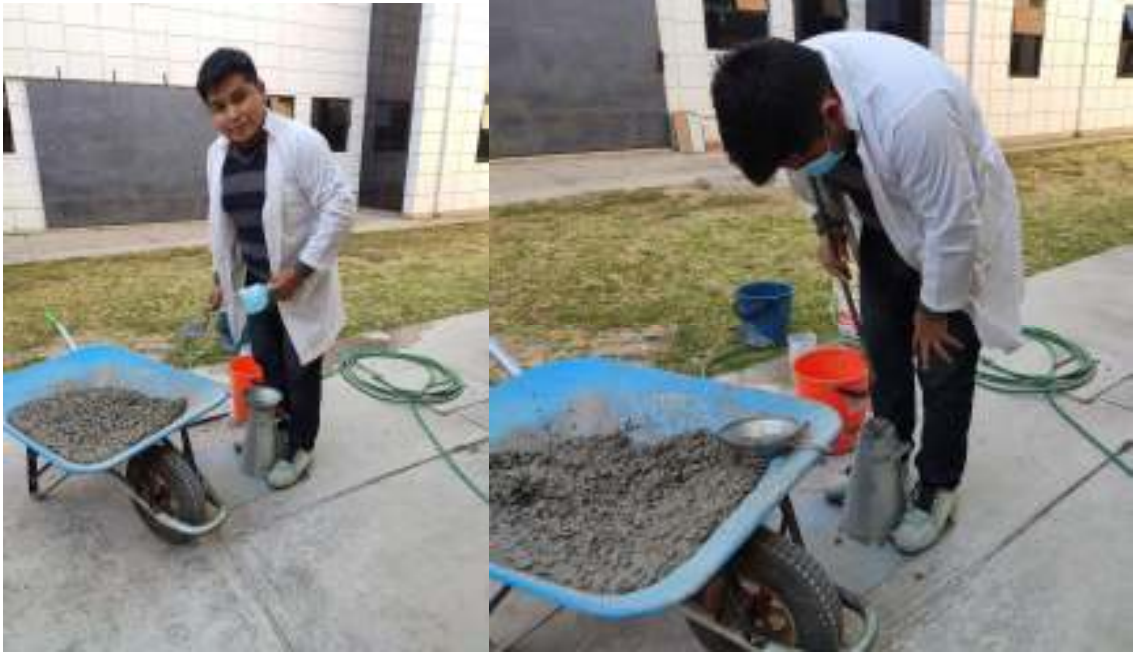
Ilustración N° 49 Realización del ensayo del cono de Abrams
