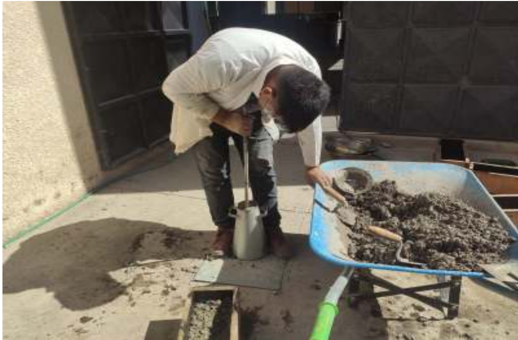
Ilustración N° 52 Apisonado para ensayo de cono de abrams
