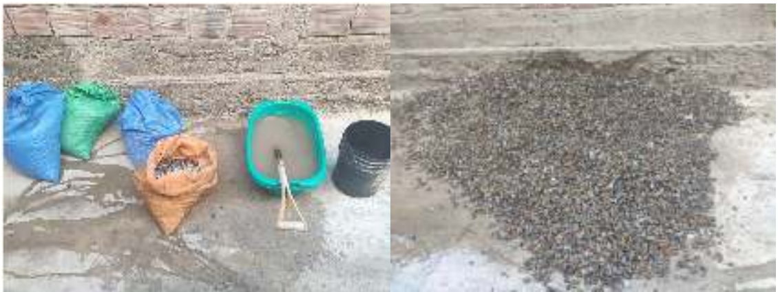
Ilustración N° 26 Proceso de lavado del material
