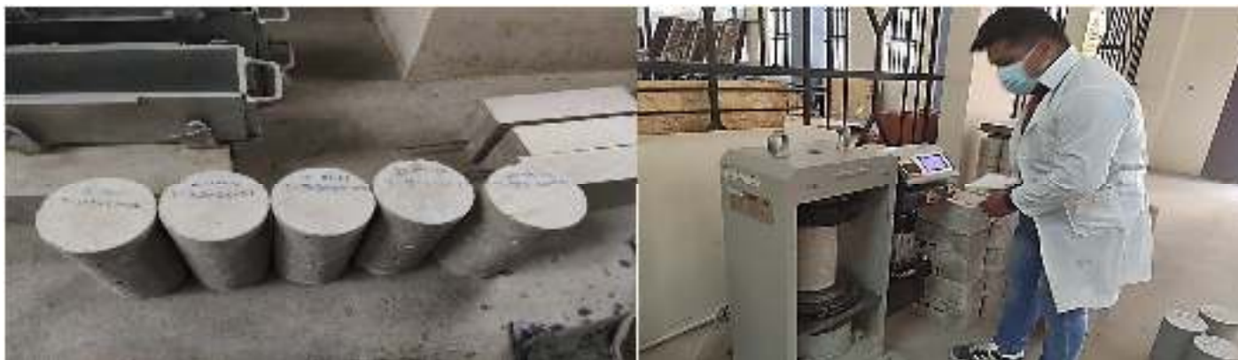
Ilustración N° 63 Rotura de cilindros con hormigón convencional
