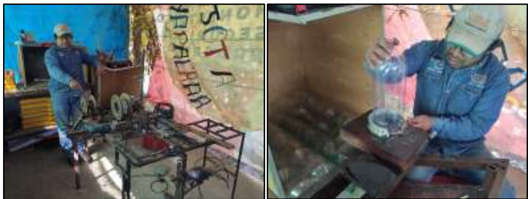
Ilustración N° 15 Proceso de fileteado y obtención de hilo de PET.
