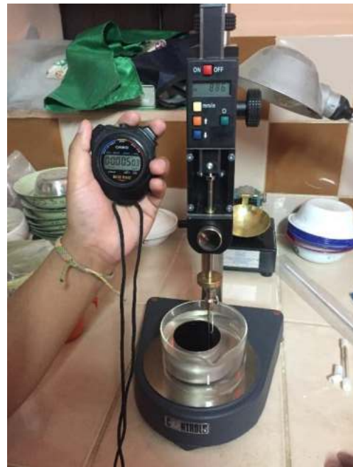
Ensayo de Penetración, Lectura de la penetración en dmm. en 5 segundos.
