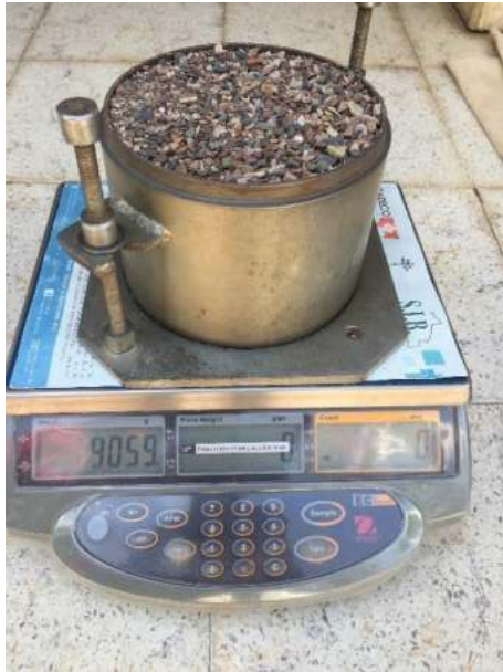
Peso unitario compactado del agregado tipo "E"
