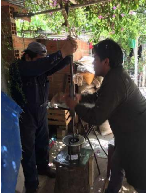
Compactando con el martillo Marshall.
