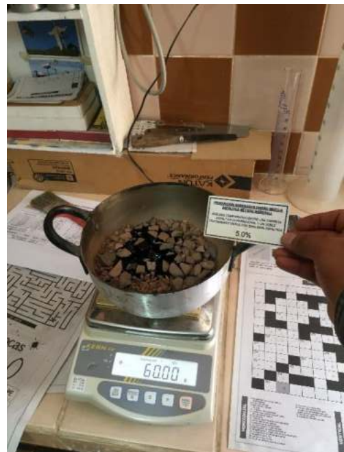
Peso del cemento asfáltico agregado para la mezcla del 5%.
