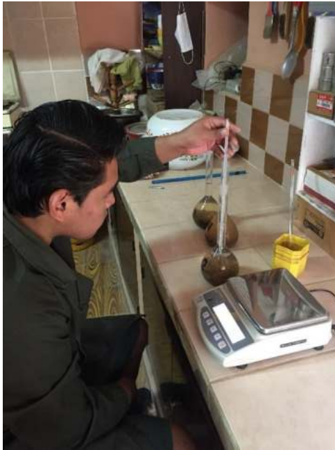
Peso específico de la arena triturada retiene N°200. Control de temperatura del matraz aforado.
