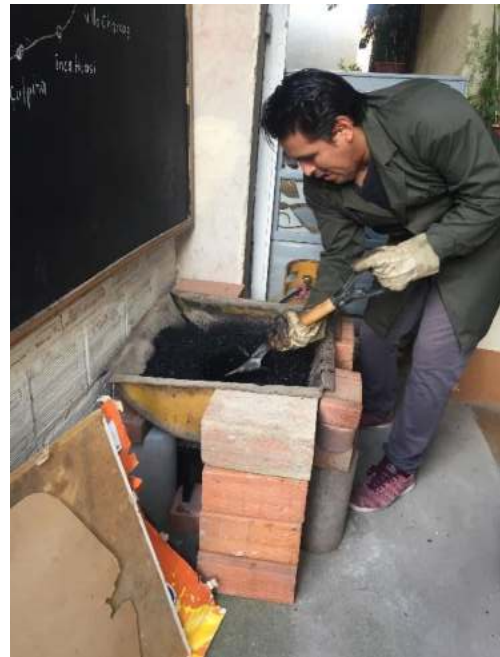
Mezclado de los agregados pétreos junto con el cemento asfáltico controlando la temperatura.
