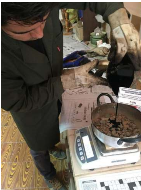
Agregando cemento asfáltico para la mezcla.
