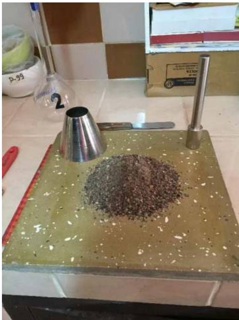
Peso específico de la arena triturada retiene N°200. Peso Superficialmente seco.
