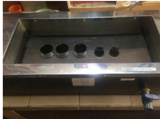
Ensayo de Peso Específico, acondicionamiento de temperatura de los picnómetros con el asfalto a 25°C.
