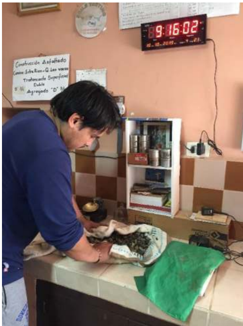
Peso Especifico de la grava, secado para obtener el valor de peso superficialmente seco.
