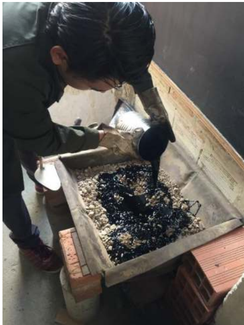
Colocado del cemento asfáltico al 5.8% según diseño.
