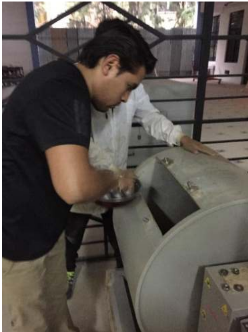
Desgaste de Los Ángeles, colocado de las 11 esferas (gradación B).
