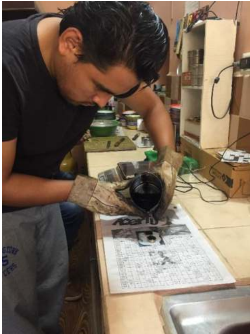
Ensayo de Punto de Ablandamiento, colocando asfalto a los anillos.
