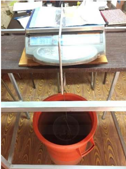
Peso Específico de la Grava, peso de la muestra sumergida.
