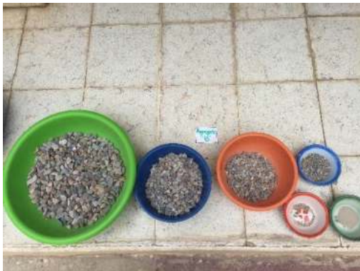
Gradación de agregado pétreo tipo "B" después de realizar el tamizado.
