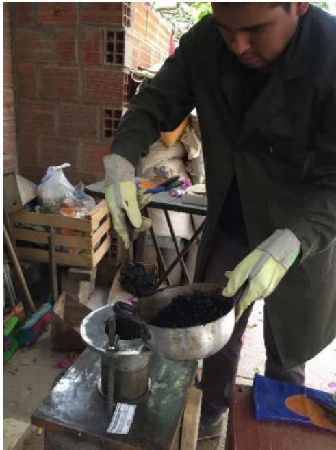
Colocando la mezcla asfáltica a los moldes Marshall.
