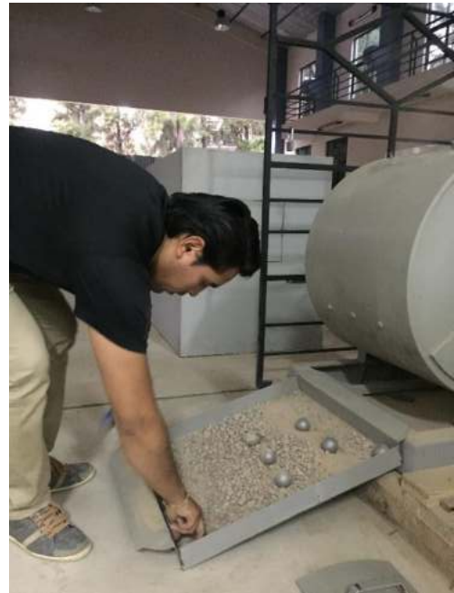
Desgaste de Los Ángeles, retirado del material de la maquina de Los Ángeles.
