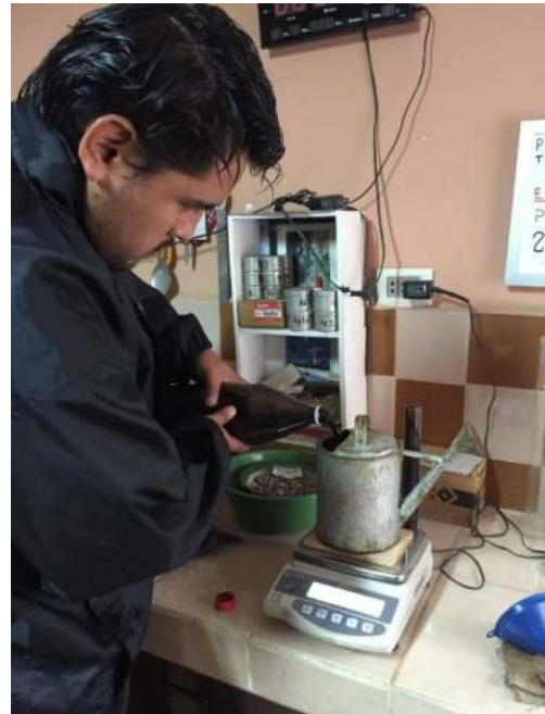
Pesaje de la emulsión asfáltica para la primera tasa de riego.
