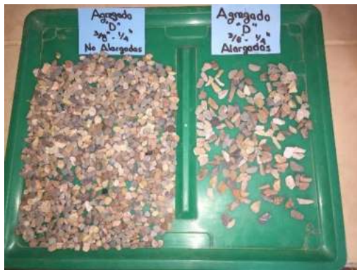
Ensayo de partículas alargadas, agregado pétreo "D"
