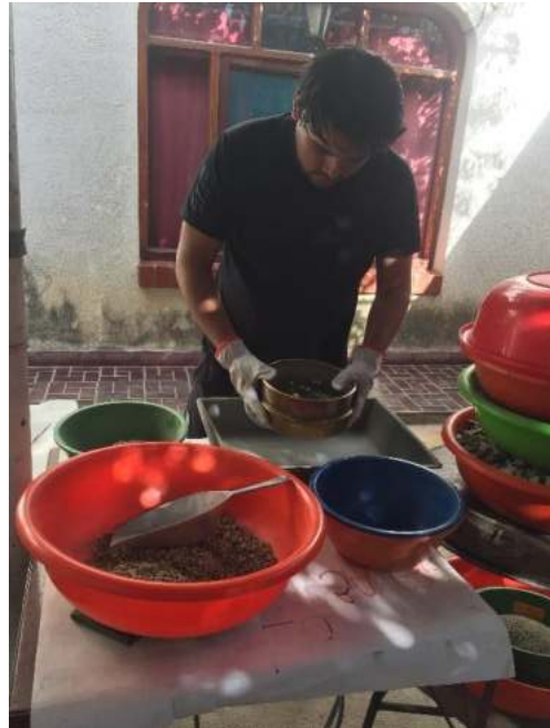
Tamizando el agregado pétreo tipo "D"
