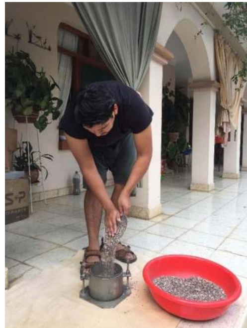
Peso unitario suelto del agregado pétreo tipo “E”
