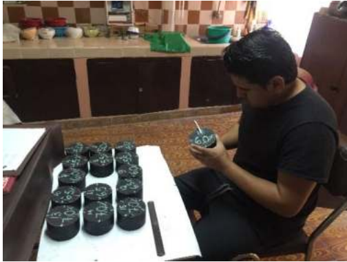
Midiendo las alturas de las briquetas con vernier.
