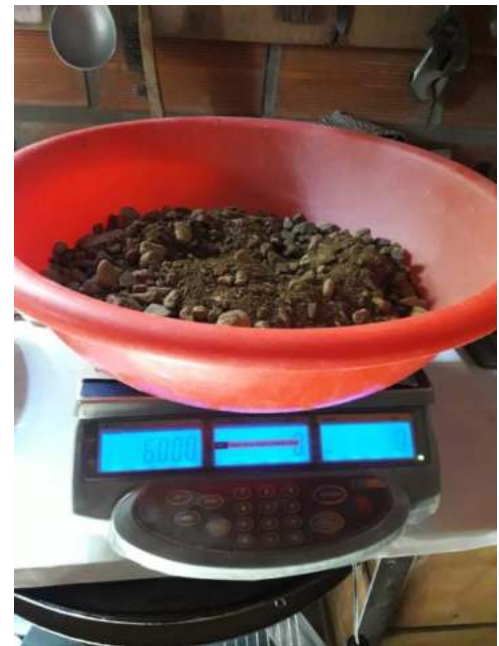
Ensayo de Proctor T180, para capa Base con materiales seleccionado.
