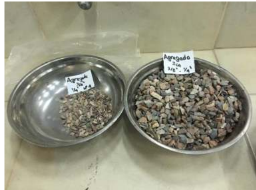
Cortes de agregado pétreo tipo "B" para ensayo de partículas alargadas.
