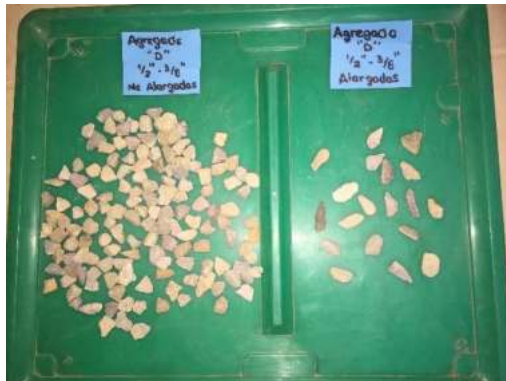
Ensayo de partículas alargadas, agregado pétreo "D"
