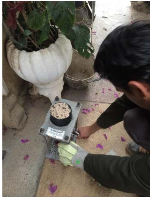
Extracción de la briqueta con gato hidráulico.
