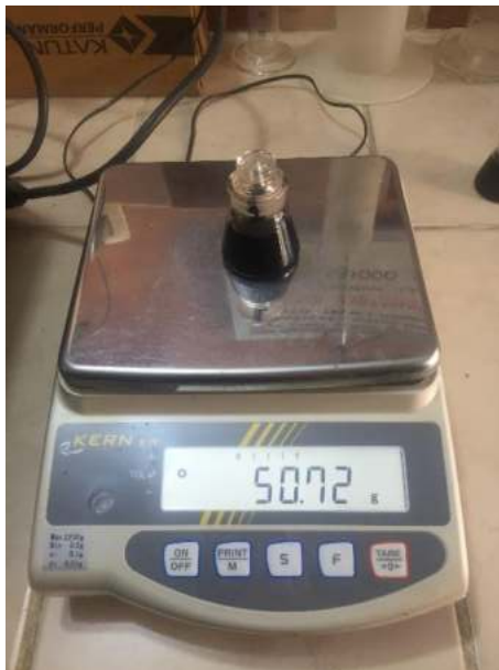
Ensayo de Peso Específico, peso de picnómetro + asfalto + agua.
