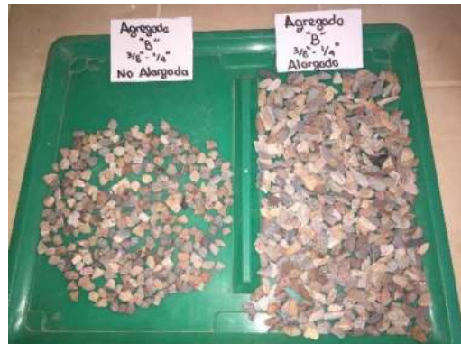
Ensayo de partículas alargadas, agregado pétreo "B"
