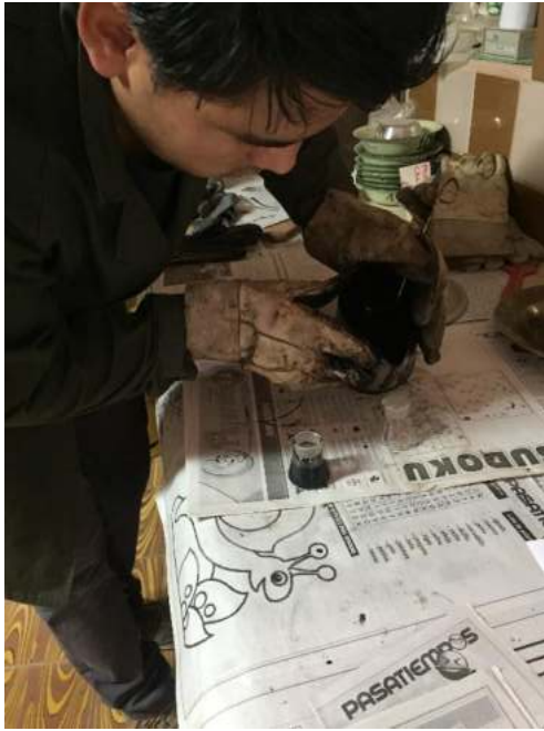
Ensayo de Peso Específico, colocando asfalto en los picnómetros.
