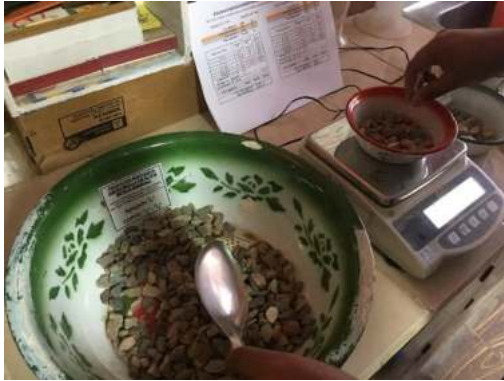
Preparación de la mezcla asfáltica en caliente.
