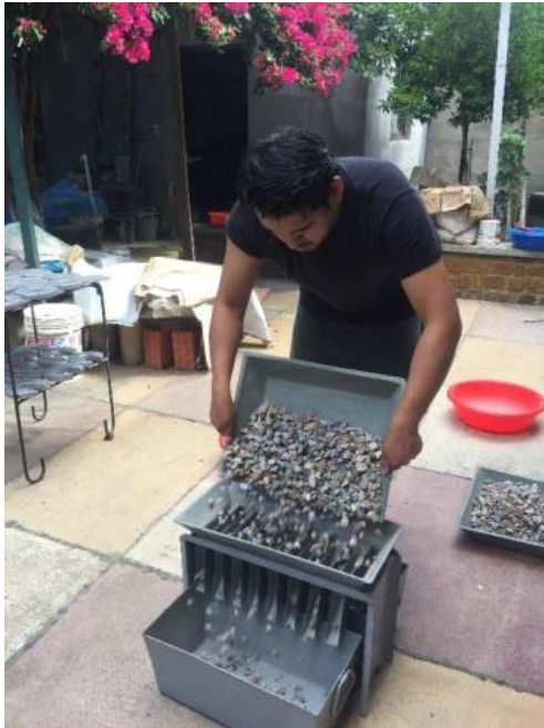
Cuarteo de los agregados pétreos para realizar ensayo de granulometrías.
