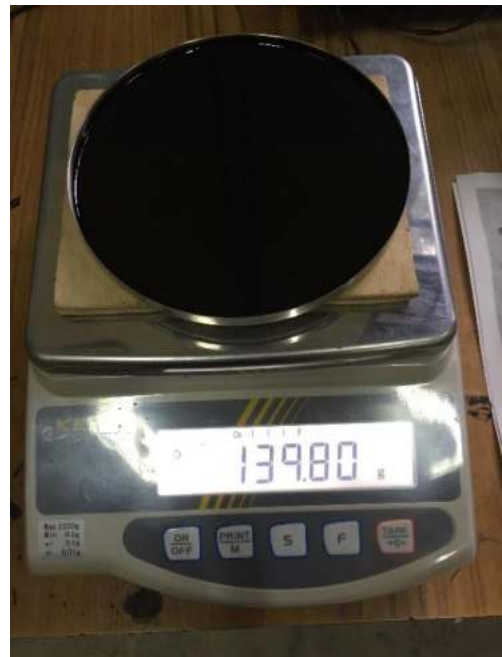
Ensayo de película delgada, pesaje de las taras después de las 5 horas en el horno.
