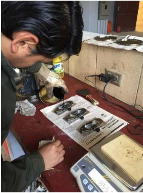
Ensayo de Ductilidad, colocando asfalto a las briquetas.
