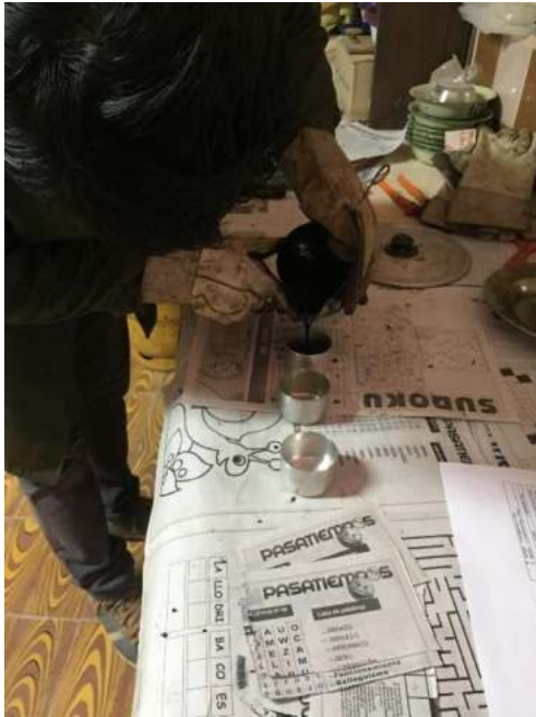
Ensayo de Penetración, colocando el cemento asfáltico en las capsulas.
