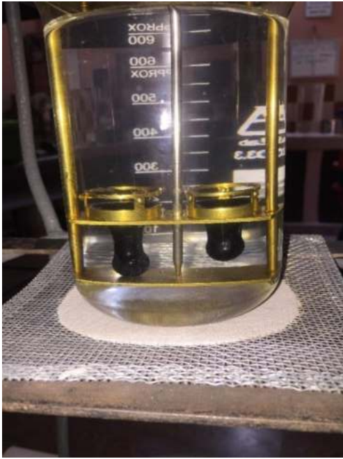
Punto de ablandamiento del residuo, de la emulsión asfáltica.
