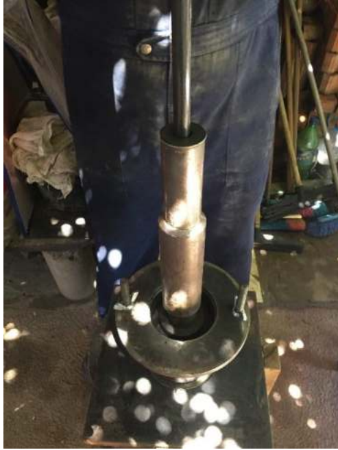
Compactando a 75 golpes por cara con el martillo Marshall.
