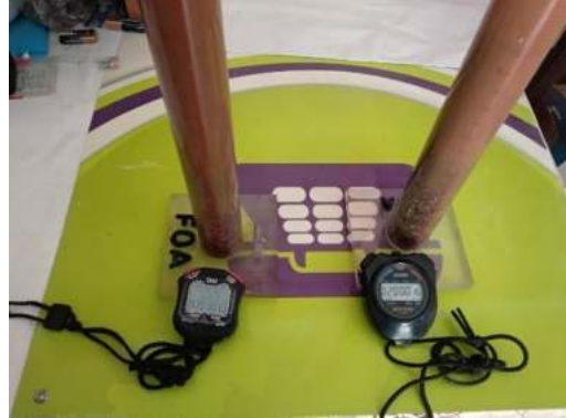
Equivalente de Arena, control de tiempo para las probetas que son analizadas.
