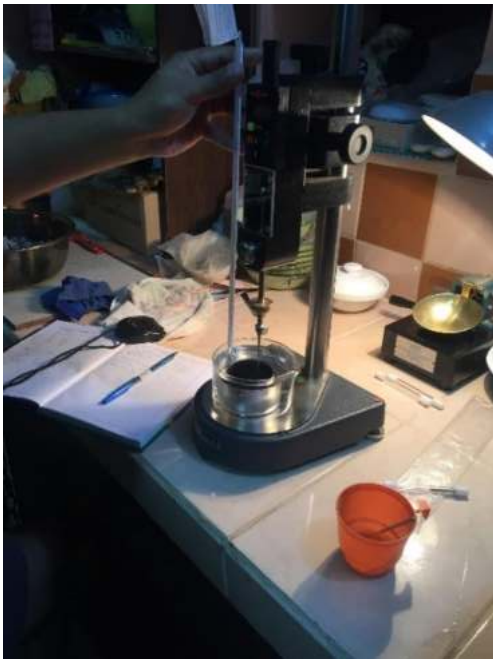
Penetración del residuo, de la emulsión asfáltica.
