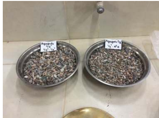
Agregado pétreo "B" separado por cortes.
