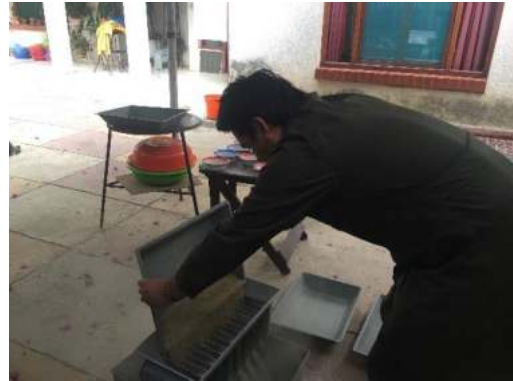
Cuarteo de Arena Triturada + Filler para Granulometría.
