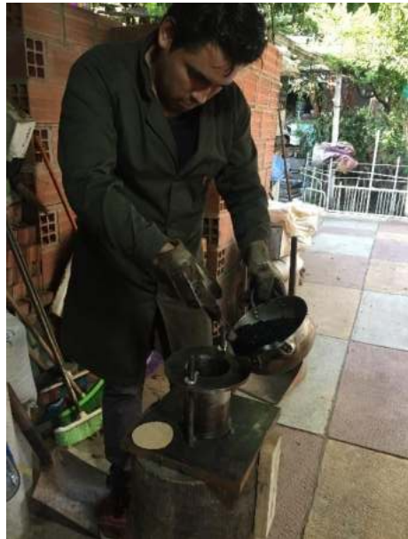
Realizando briquetas para controlar la mezcla asfáltica que se pretende colocar en el área de trabajo.
