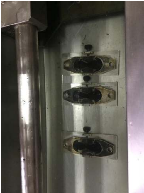
Ensayo de Ductilidad, briquetas y asfalto acondicionándose a una temperatura de 25°C.
