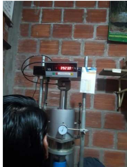
Lectura de la Fuerza – Penetración para Ensayo de CBR de Capa Base.
