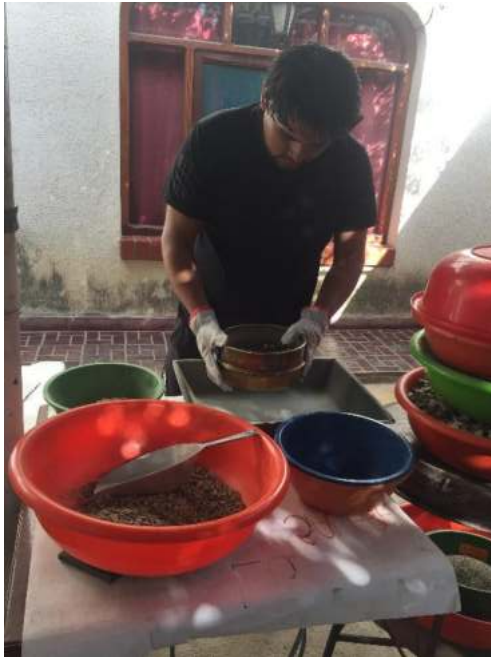
Granulometría de Agregado Pétreo 3/8", para mezcla asfáltica en caliente.
