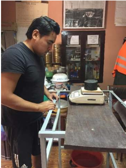
Peso superficialmente seco de las briquetas.
