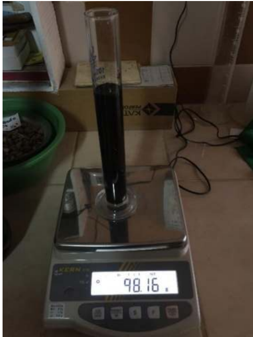
Peso específico de la emulsión asfáltica, EMULEX RR1C-E
