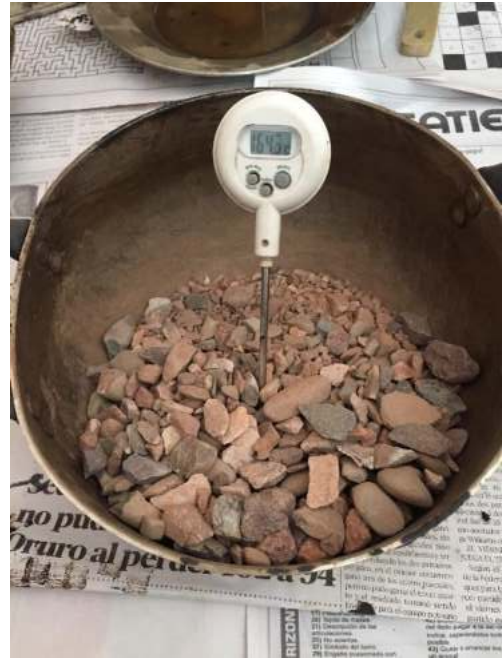
Calentado los agregados pétreos para la mezcla asfáltica.
