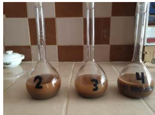
Peso Especifico de Filler, muestra sacada del horno para sacar las burbujas de aire.
