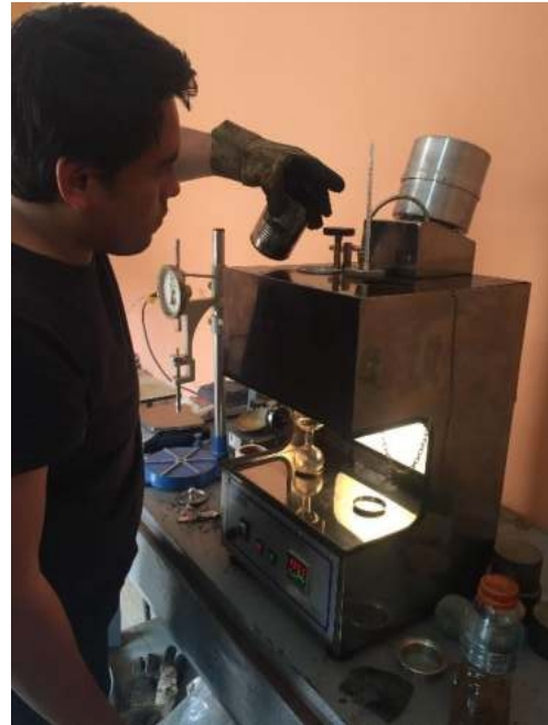
Ensayo de Viscosidad Saybolt Furol, Colocando el asfalto en la cámara de acondicionamiento del asfalto a 135°C.
