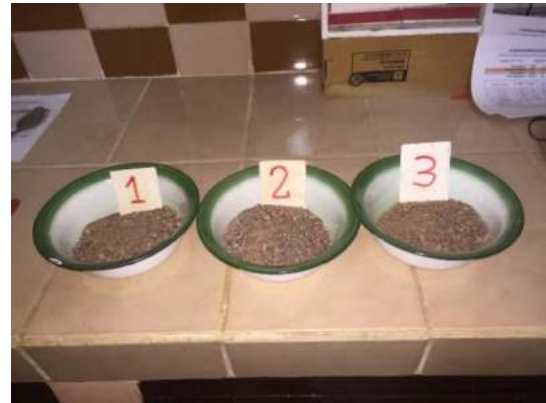
Peso específico de la arena triturada retiene N°200. Muestra secada en horno.
