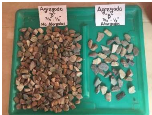
Ensayo de partículas alargadas, agregado pétreo "B"
