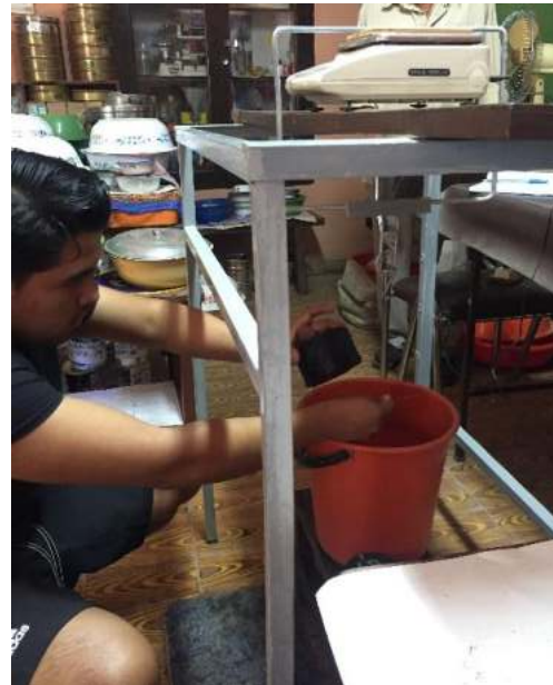
Peso sumergido de las briquetas.
