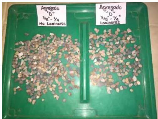
Ensayo de partículas laminares, agregado pétreo "D"
