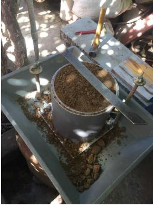
Enrasando el molde para ensayo de Proctor T180.
