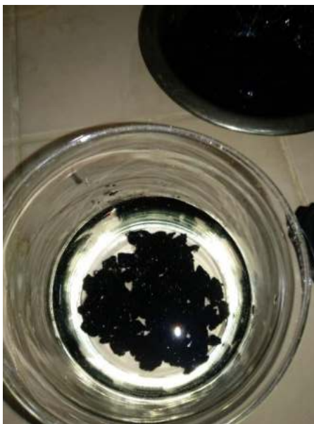
Adherencia de agregado – cemento asfáltico, residuo de la emulsión asfáltica.
