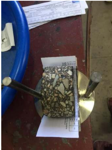
Corrida de Marshall de los núcleos extraídos.
