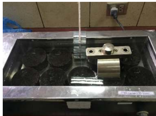
Baño María con las briquetas y la mordaza para su acondicionamiento de temperatura.
