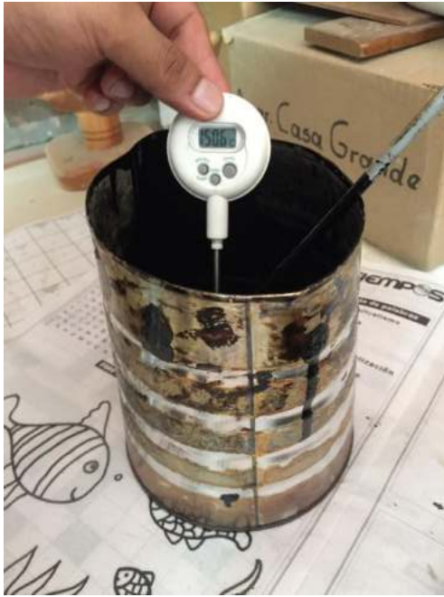
Calentando el asfalto mediante la carta de Temperatura – Viscosidad.
