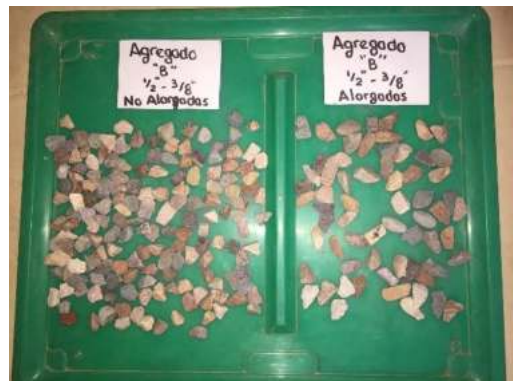
Ensayo de partículas alargadas, agregado pétreo "B"
