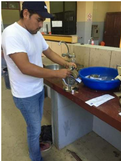
Corrida de Marshall de los núcleos extraídos.
