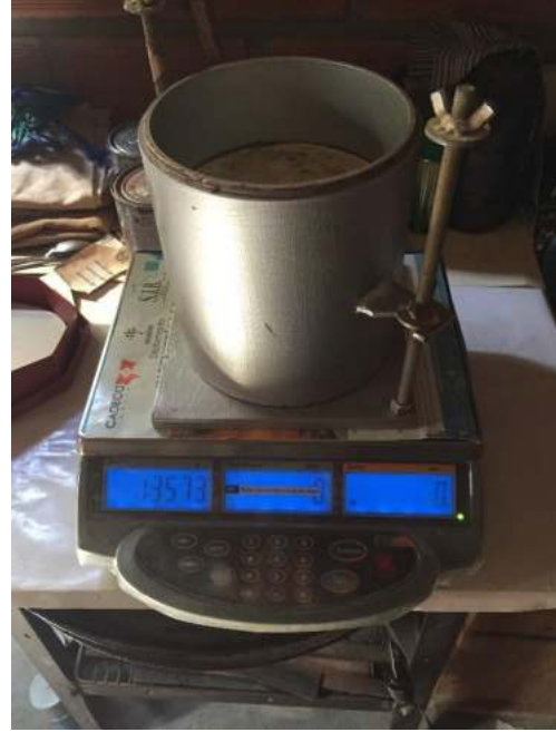
Peso de molde + agregado compactado para CBR.
