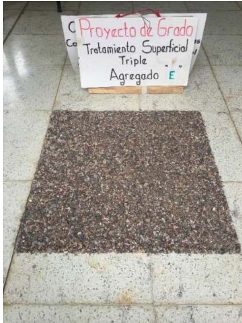
Método práctico de obtener pesos de agregado pétreo por metro cuadrado.
