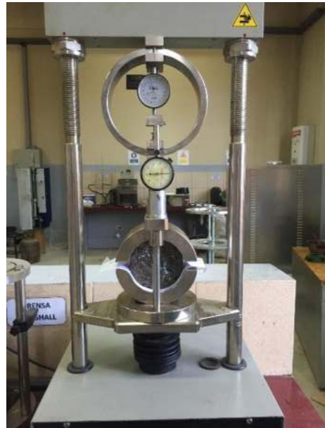
Corrida de Marshall de los núcleos extraídos.
