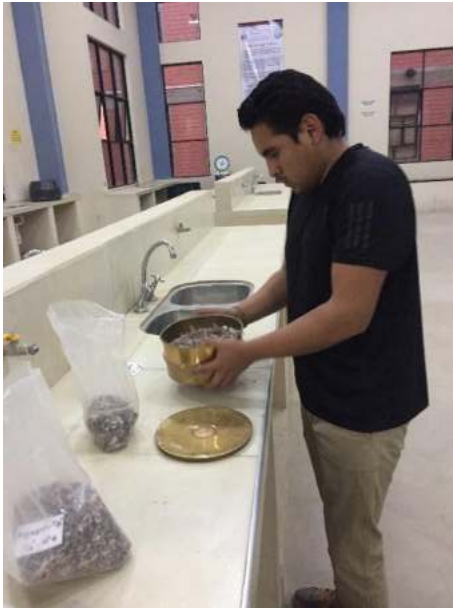
Ensayo de partículas laminares, tamizando para generar los cortes de cada agregado pétreo.
