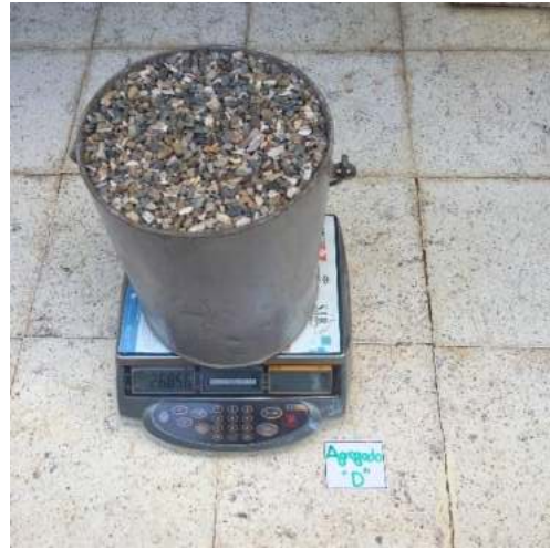
Peso unitario, Peso de agregado tipo “D”
