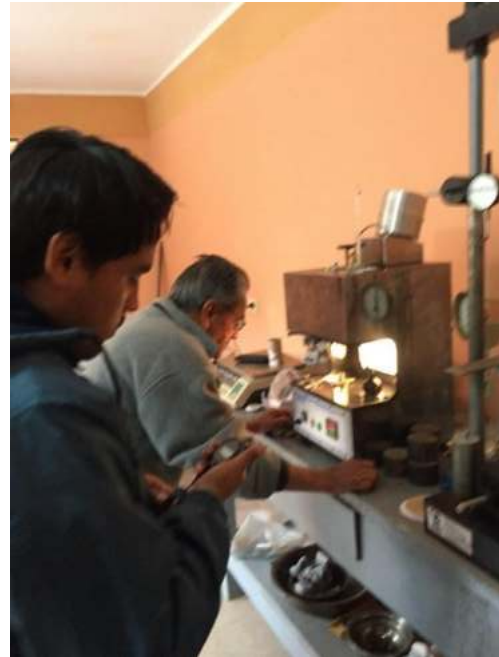
Viscosidad Saybolt Furol de la emulsión asfáltica. EMULEX RR1C-E
