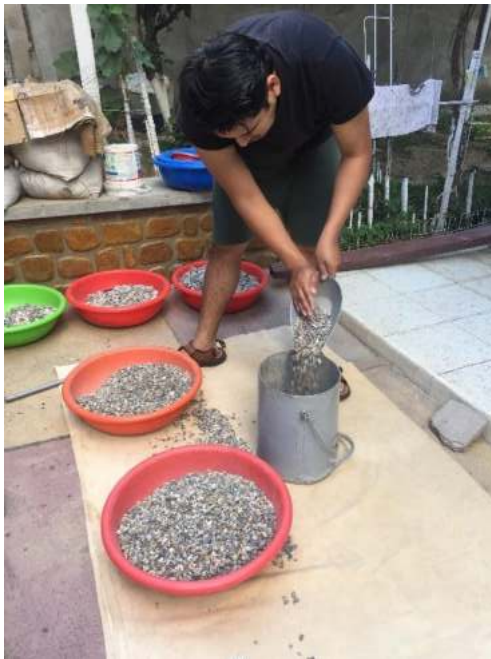
Peso unitario suelto del agregado pétreo tipo “D”
