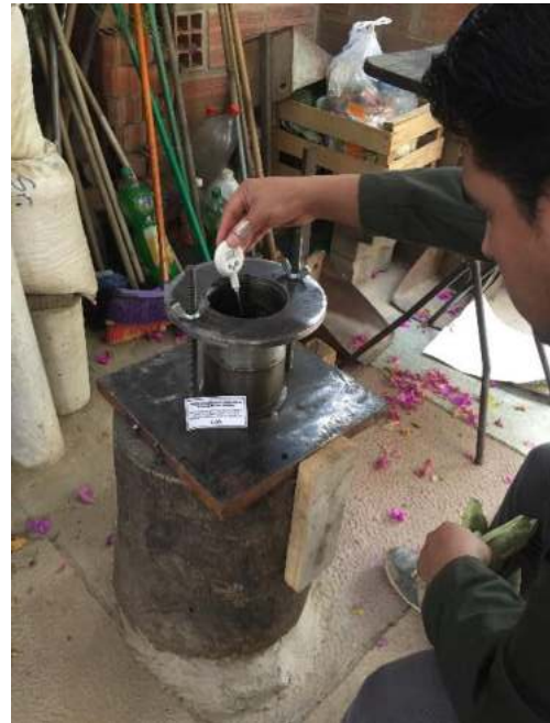
Controlando la temperatura de compactación.
