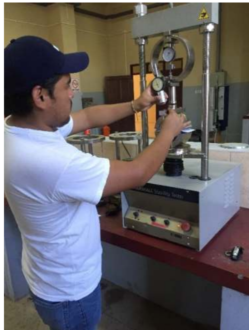
Corrida de Marshall de los núcleos extraídos.
