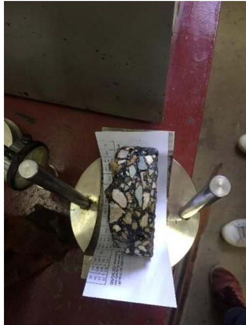
Vista de perfil de un núcleo del DTST.
