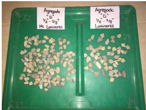
Ensayo de partículas laminares, agregado pétreo "D"
