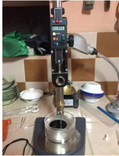
Penetración del residuo, de la emulsión asfáltica.
