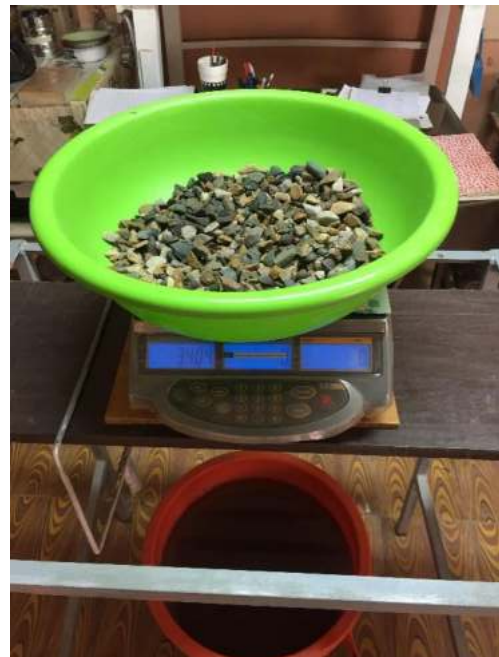
Peso Especifico de la grava, peso superficialmente seco.
