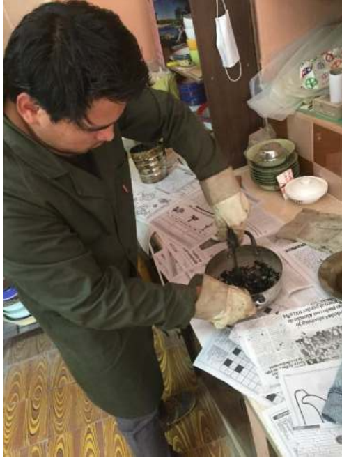
Mezclando los agregados con el cemento asfáltico.
