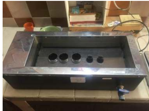
Ensayo de Penetración, Condicionando las muestras a una temperatura de 25°C en baño María.
