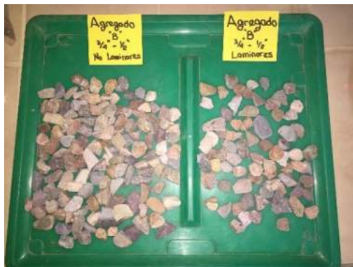
Ensayo de partículas laminares, agregado pétreo "B"
