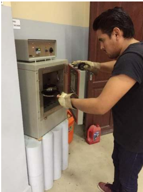
Ensayo de película delgada, colocado de las taras al horno giratorio.
