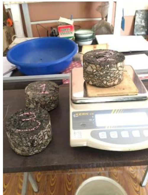
Núcleos de la carpeta asfáltica.
