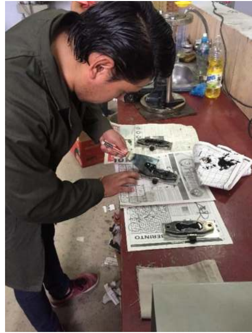
Ensayo de Ductilidad, enrasando el exceso de asfalto en las briquetas.
