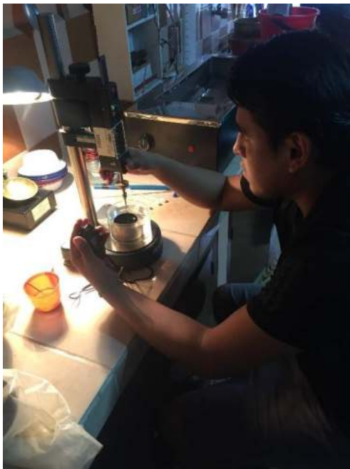
Ensayo de Penetración, Lecturando la penetración de la aguja en la muestra.
