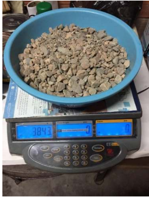
Desgaste de Los Ángeles, peso de agregado retiene N°12.
