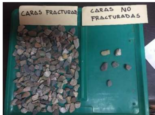
Ensayo de Caras Fracturadas, partículas con una cara fracturada.
