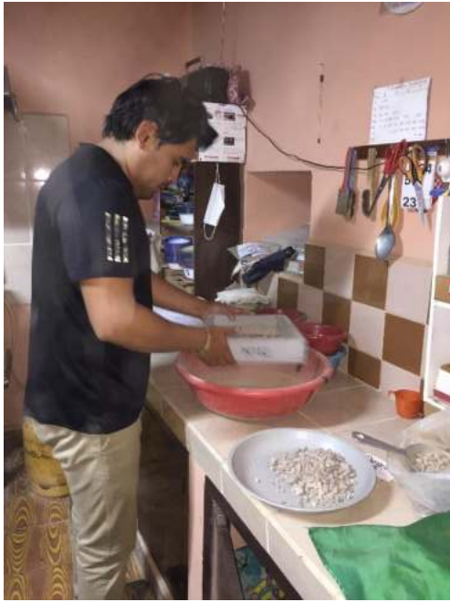
Desgaste de Los Ángeles, Tamizado (N°12) de la muestra
