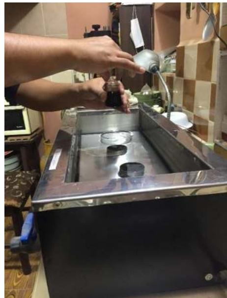
Ensayo de Peso Específico, enrase de agua al picnómetro.
