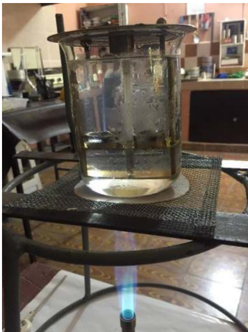
Ensayo de Punto de Ablandamiento, control de temperatura con mechero.
