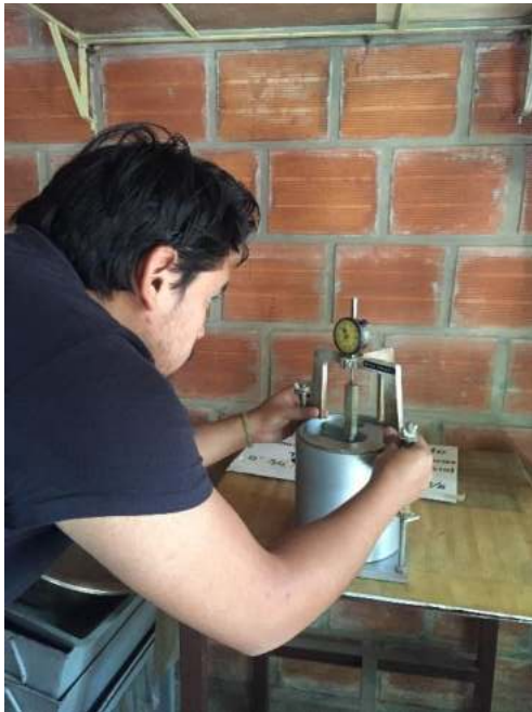
Observando la Expansión inicial para ensayo de CBR.
