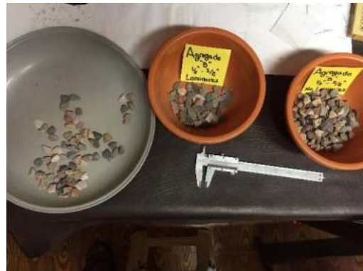
Ensayo de partículas laminares, agregado pétreo "B" controlando con el vernier.
