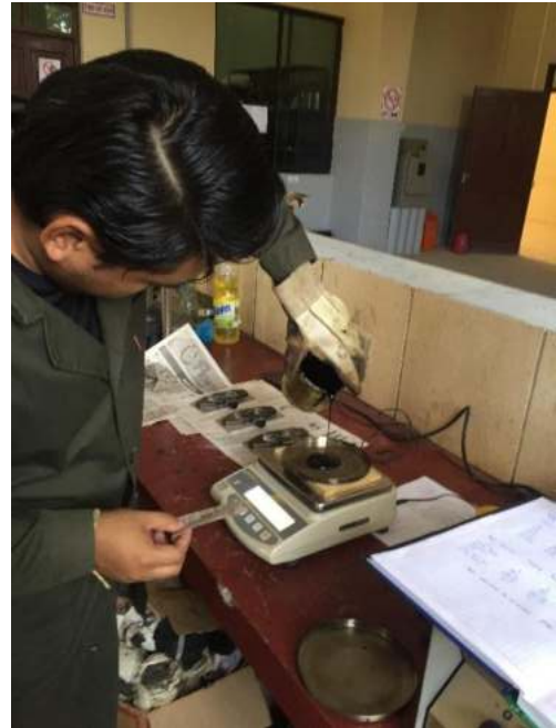
Ensayo de película delgada, pesaje de asfalto antes de entrar al horno.
