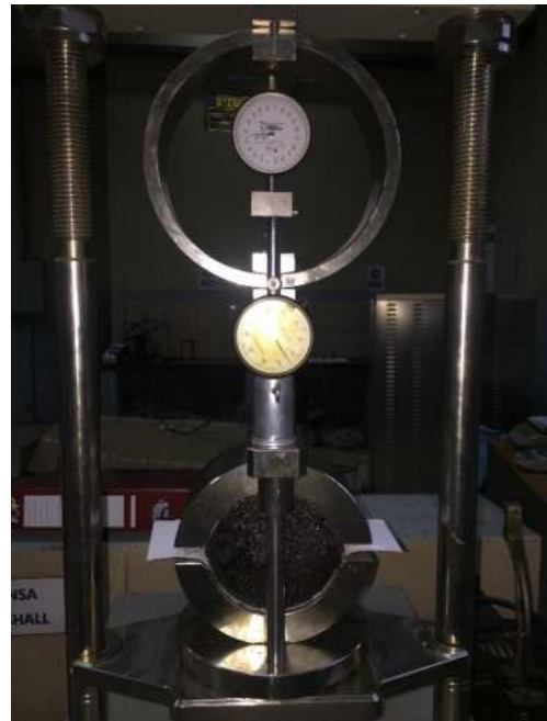
Prensa Marshal con la briqueta.
