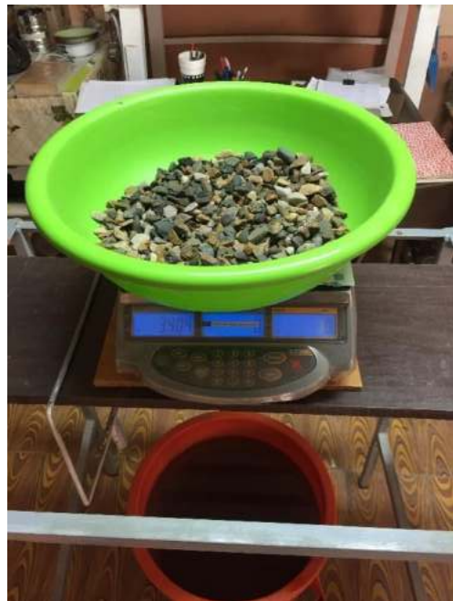
Peso específico del Agregado pétreo "B"
