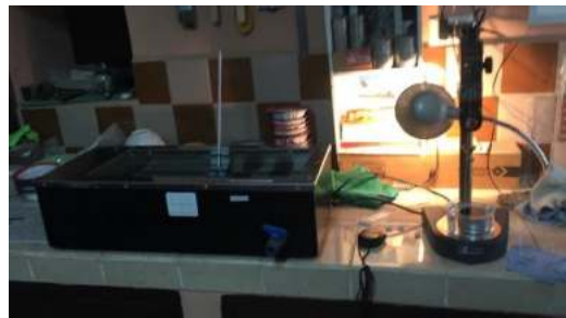
Equipo de penetración y el baño María para acondicionar las muestras a 25°C.
