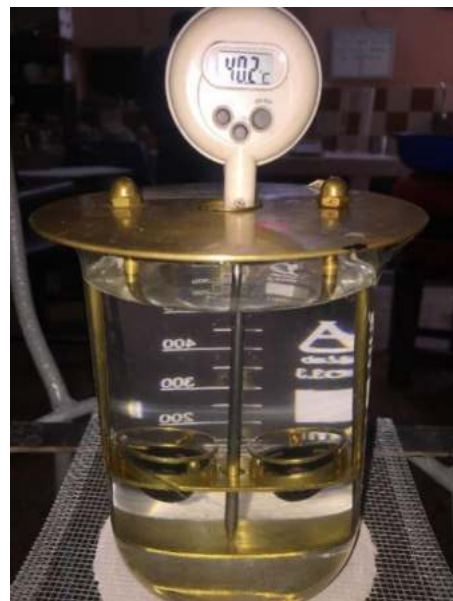
Punto de ablandamiento del residuo de la emulsión asfáltica, EMULEX RR1C-E
