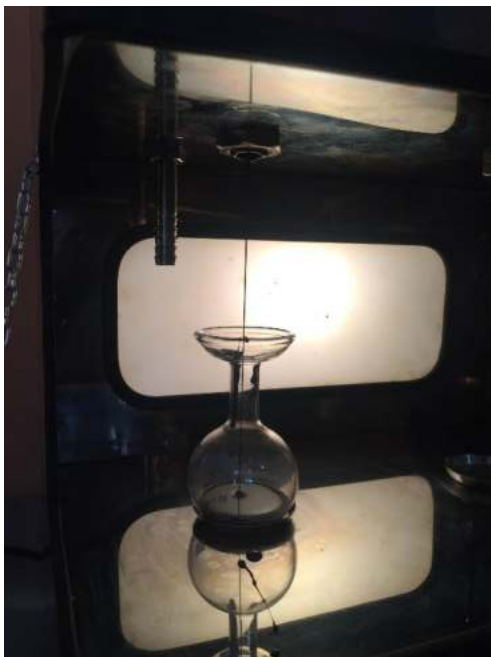
Cemento asfáltico fluyendo hacia la copa calibrada de 60 ml.
