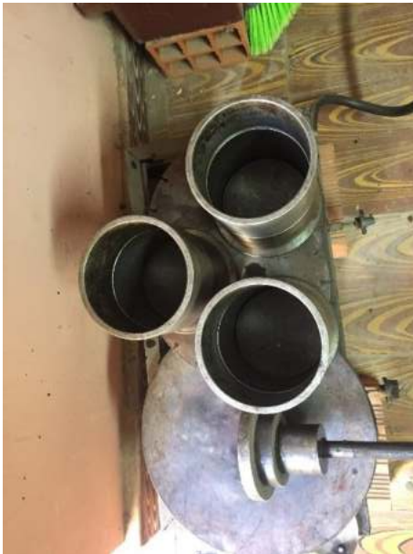
Calentando los moldes Marshall para realizar briquetas de control.
