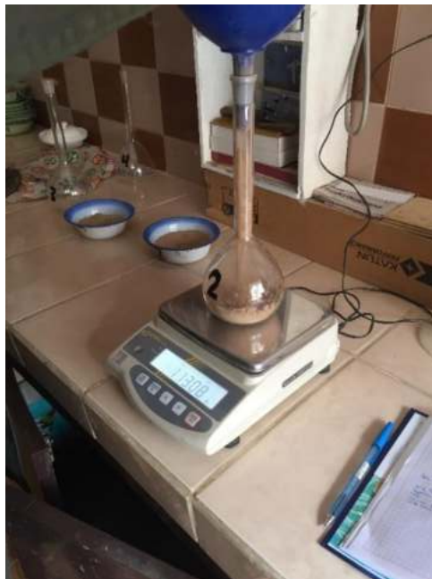
Peso Especifico de Filler, Coloca de muestra en matras.
