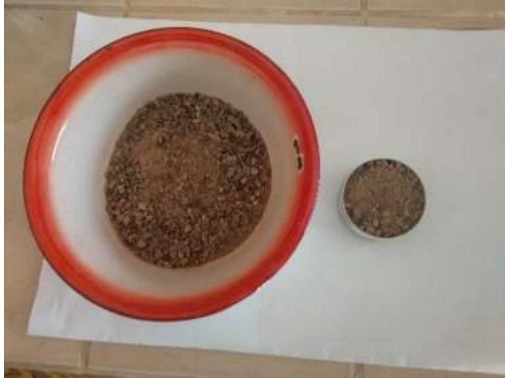
Equivalente de Arena, medida de muestra de arena para ser analizada.
