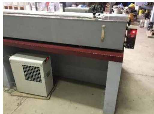
Equipo para realizar el ensayo de Ductilidad.
