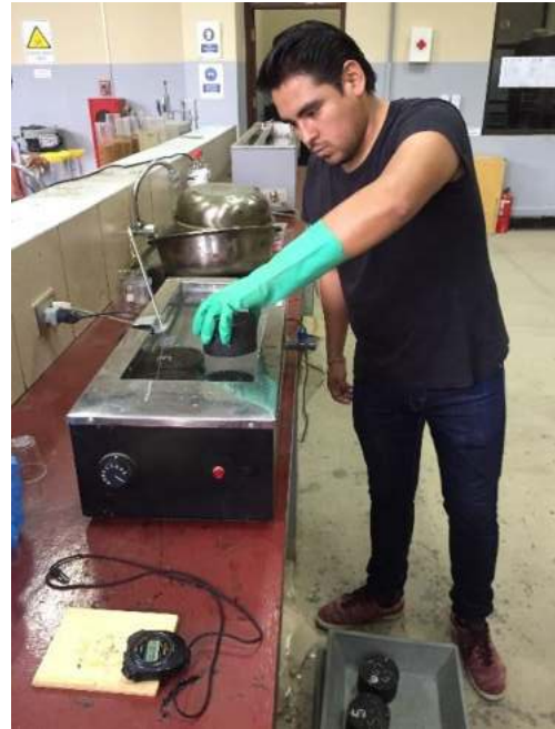
Acondicionamiento de las briquetas a 60°C para correr en la prensa Marshall.
