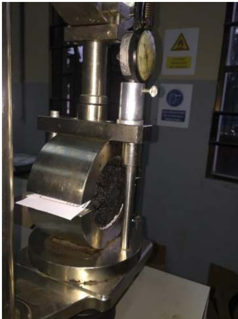
Prensa Marshal con la briqueta.
