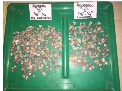
Ensayo de partículas laminares, agregado pétreo "D"
