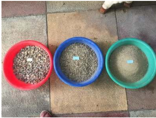
Preparación del agregado de la mezcla asfáltica en caliente para el área de trabajo.
