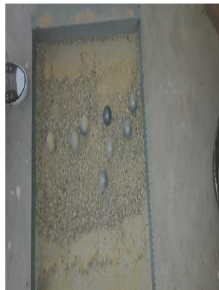
Figura 13. Colocado y el retiro del agregado en la máquina de los ángeles y las esferas.
