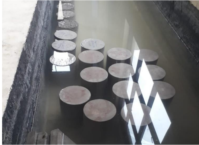
Figura 15. Curado de las probetas.
