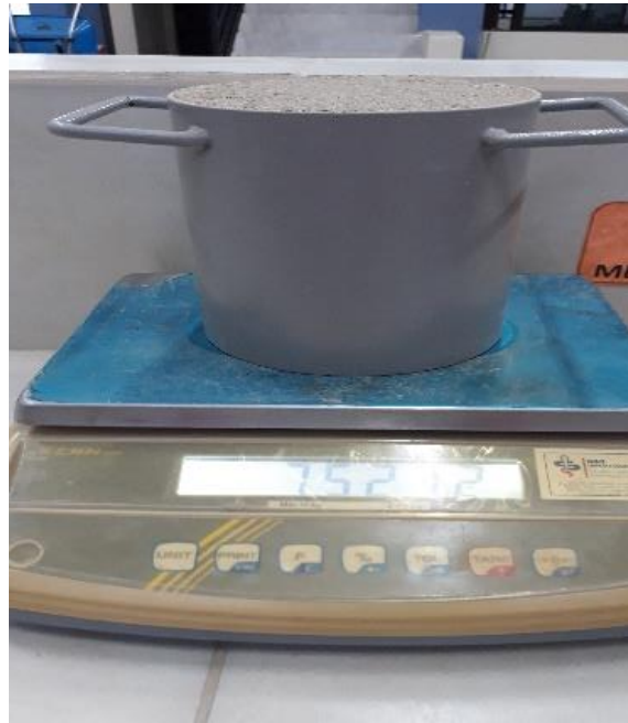
Figura 12. Peso del agregado suelto y varillado más el molde.
