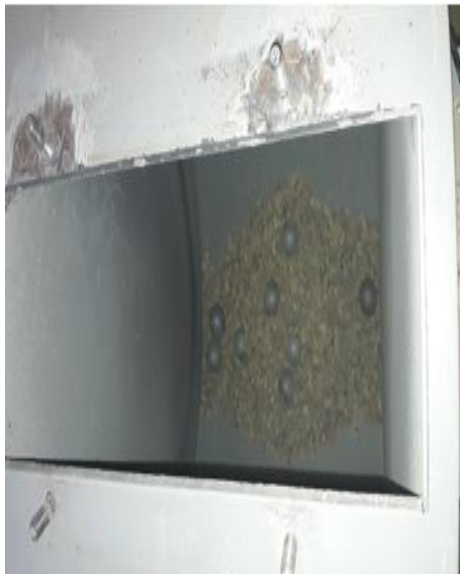
Figura 13. Colocado y el retiro del agregado en la máquina de los ángeles y las esferas.
