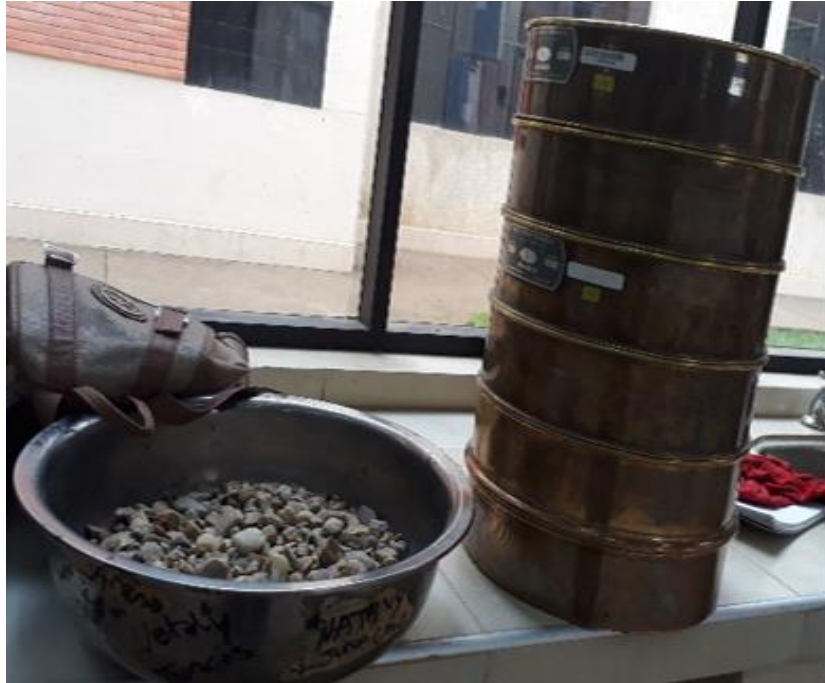
Figura 11. Secado superficialmente del agregado grueso para el peso específico.
