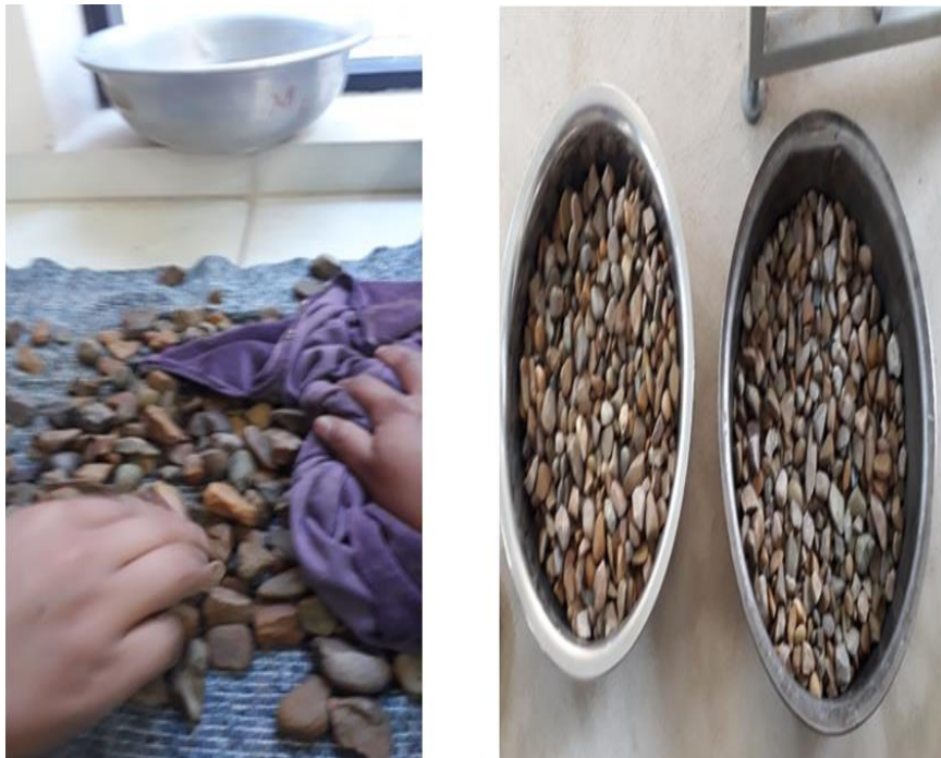
Figura 11. Secado superficialmente del agregado grueso para el peso específico.
