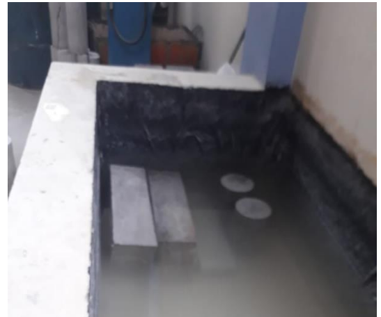
Figura 17. Curado de vigas.
