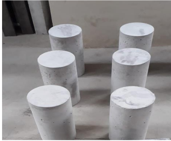
Figura 15. Curado de las probetas.
