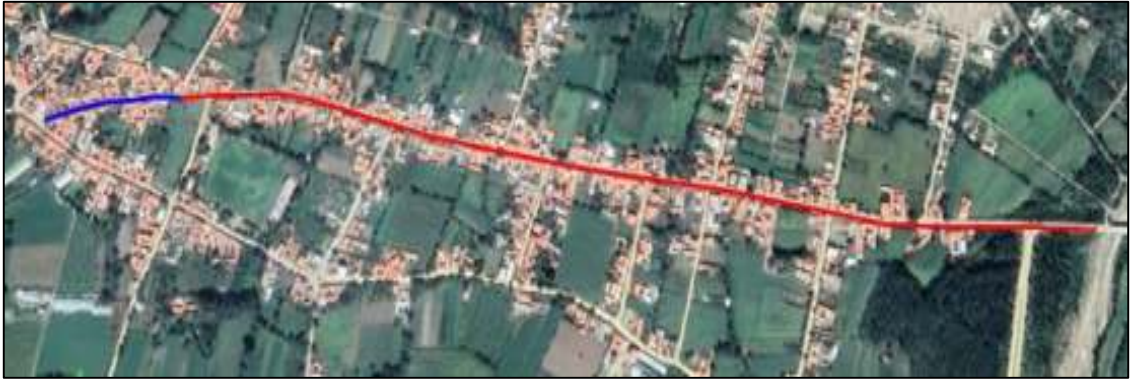
Imagen 2. Tramo de adoquín y tramo de Tratamiento Superficial doble
