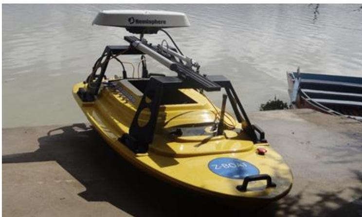
**Figura 1.** *Equipo para la medición batimétrica Z – Boat.*
