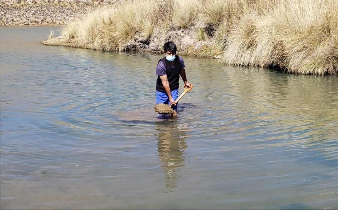
**Imagen 17.** Extracción de muestras de sedimento de uno de los puntos de entrada hacia el embalse.
