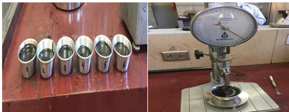
Figura 28. Medición de la penetración del cemento asfáltico
