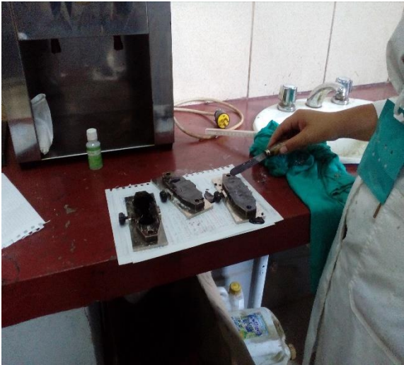
Enrasado del material asfaltico
