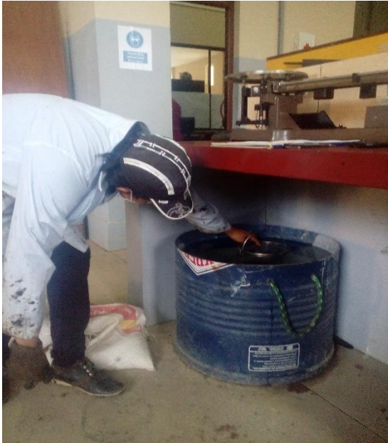
Medición de estabilidad y flujo en la prensa Marshall
