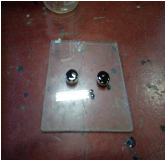
Anillos con material asfáltico
