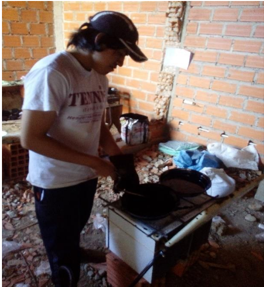
Mezclado de los agregados con el asfalto
