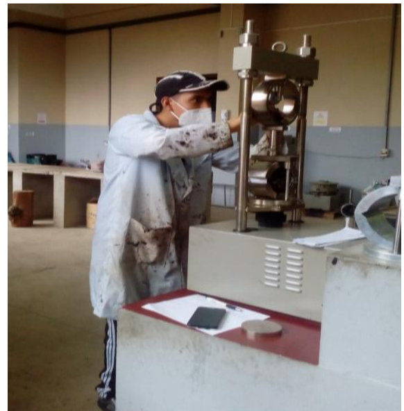
Medición de estabilidad y flujo en la prensa Marshall
