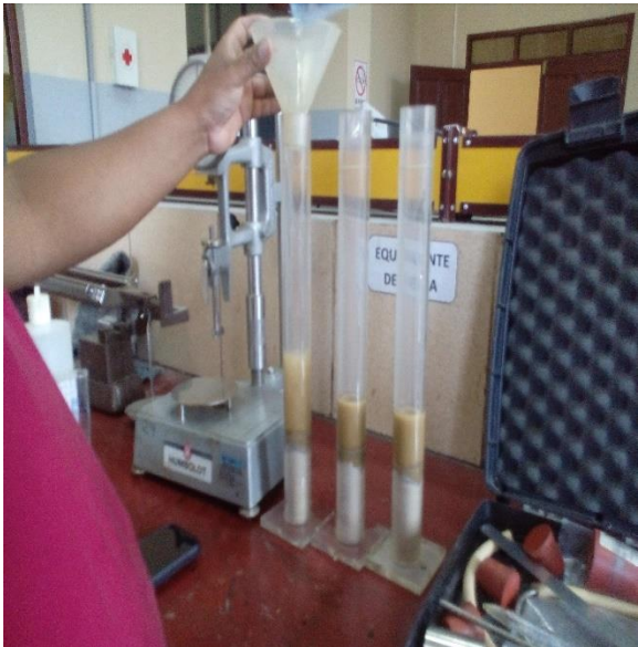
Probeta con arena, agua destilada y cloruro de calcio
