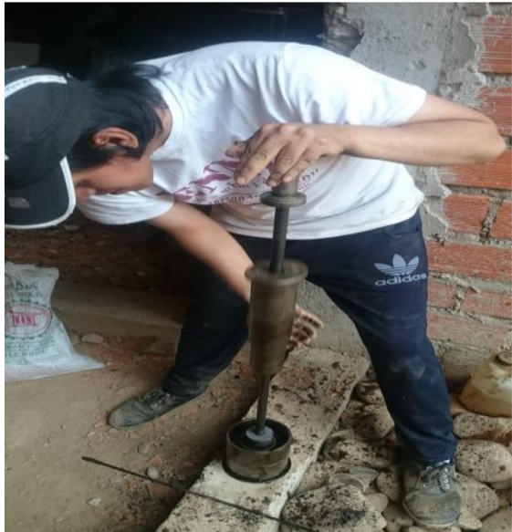
Compactado de briquetas
