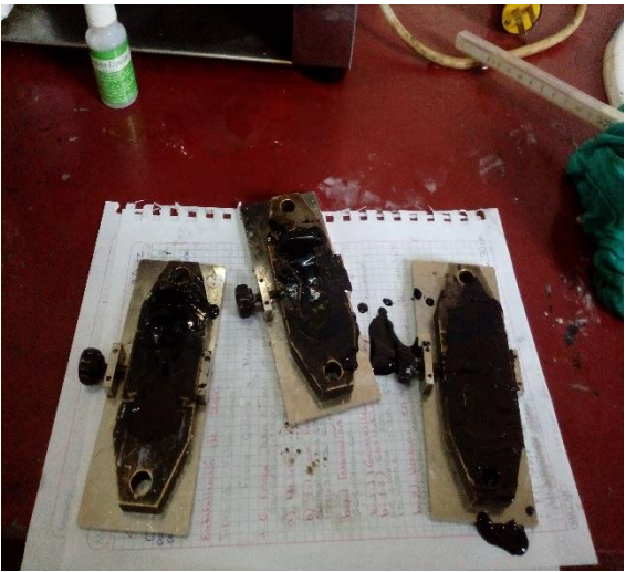
Moldes con material asfaltico
