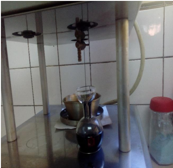
Filtración del asfalto de la máquina de los ángeles en probeta
