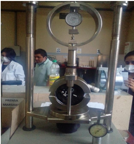
Medición de estabilidad y flujo en la prensa Marshall
