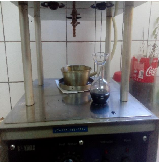
Filtración del asfalto de la máquina de los ángeles en probeta
