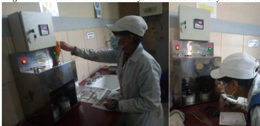
Fig. 4.14. Procedimiento del ensayo de Viscosidad Saybolt Furol.
