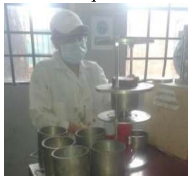
Fig. 4.37. Extracción de briquetas de los moldes.
