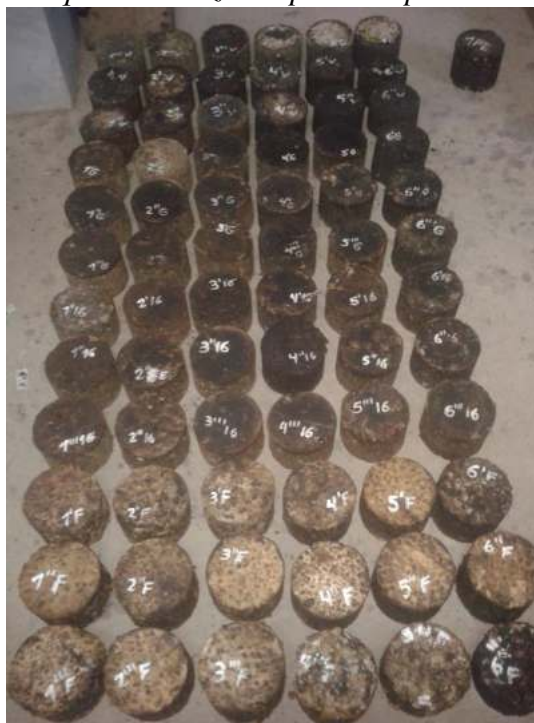
Fig. 4.39. Totalidad de briquetas realizadas para el óptimo de asfalto residual.
