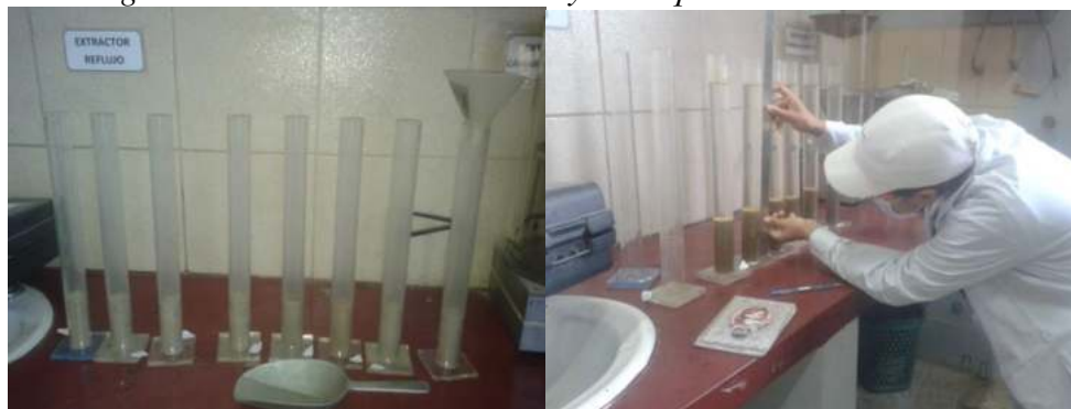
Fig. 4.10. Procedimiento del ensayo de equivalente de arena.
