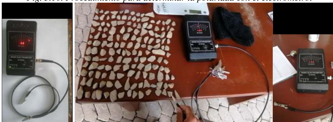
Fig. 3.10. Procedimiento para determinar la polaridad con el electrómetro.
