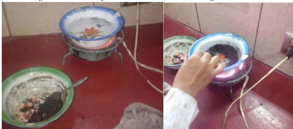
Fig. 4.33. Hervido y remoción de la mezcla en agua destilada.
