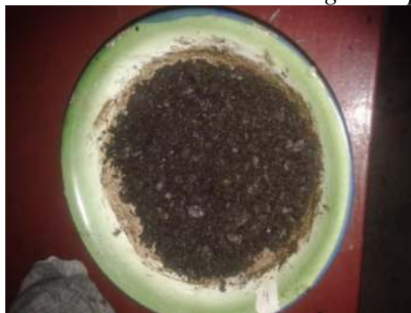
Fig. 4.31. Cubrimiento del árido con 4% de agua de premezcla.
