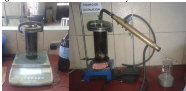
Fig. 4.16. Procedimiento del ensayo de destilación.
