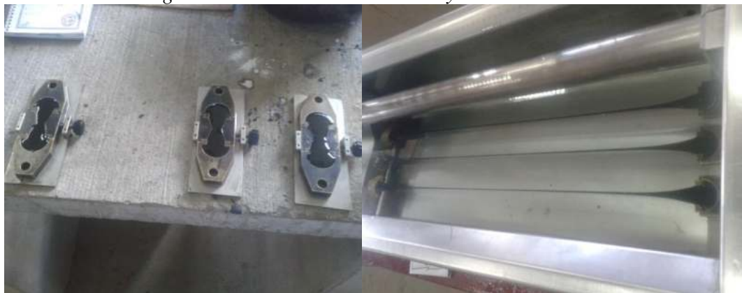
Fig. 4.18. Procedimiento del ensayo de ductilidad.
