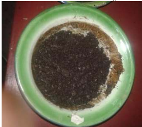
Fig. 4.30. Cubrimiento del árido con 3% de agua de premezcla.
