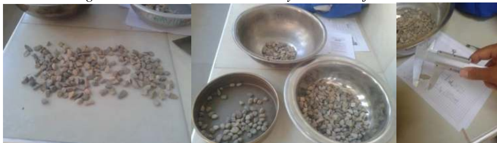
Fig. 4.11. Procedimiento del ensayo de caras fracturadas.
