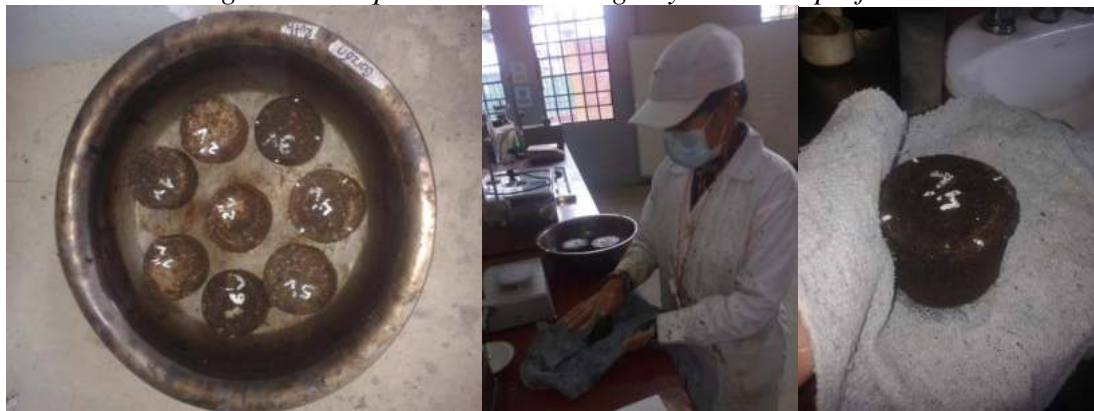
Fig. 4.41. Briquetas dentro del agua y secado superficial.
