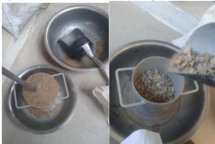
Fig. 4.6. Procedimiento del ensayo de peso unitario.
