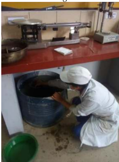
Fig. 4.42. Peso sumergido de las briquetas.
