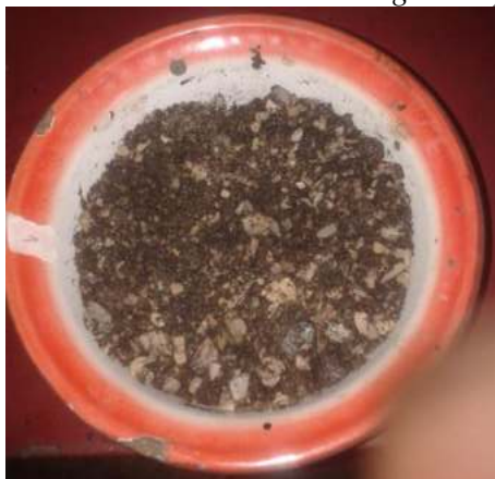
Fig. 4.28. Cubrimiento del árido con 1% de agua de premezcla.
