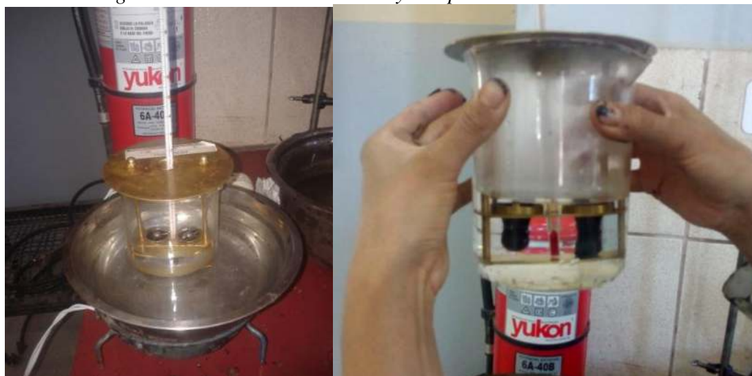
Fig. 4.20. Procedimiento del ensayo de punto de ablandamiento.
