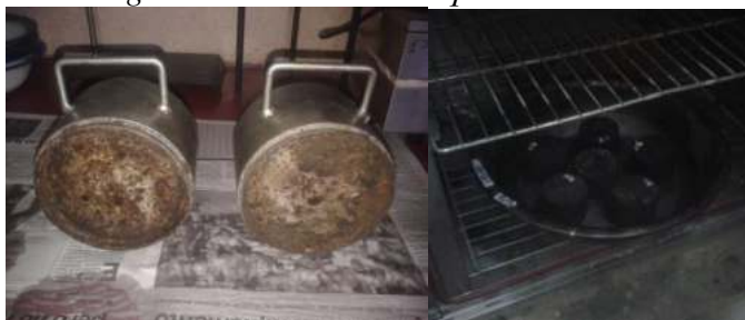
Fig. 4.38. Curado de briquetas.
