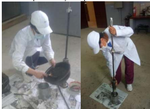
Fig. 4.36. Preparación y compactación de la mezcla.
