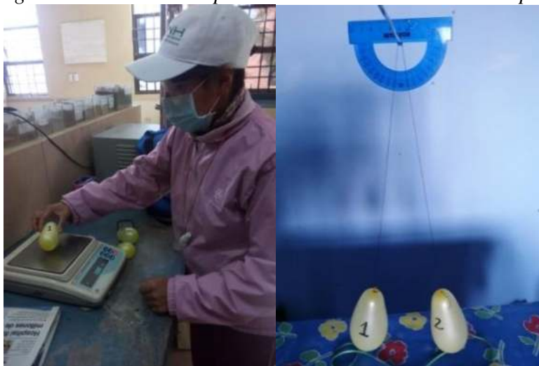
Fig. 3.6. Toma de datos para la calibración del electroscopio.
