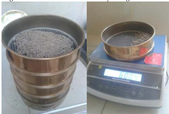
Fig. 4.5. Procedimiento del ensayo de granulometría.
