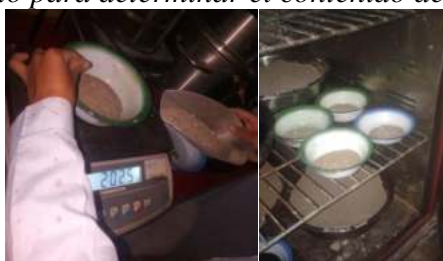
Fig. 4.25. Procedimiento para determinar el contenido de humedad.
