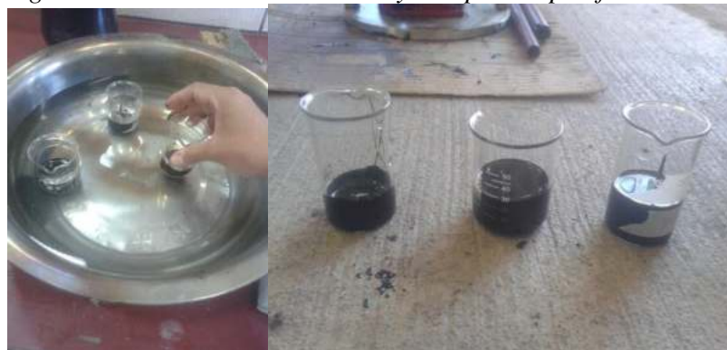
Fig. 4.19. Procedimiento del ensayo de peso específico.
