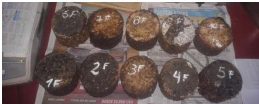
Fig. 4.77. Briquetas realizadas con óptimo de asfalto residual: Áridos "Fernández".
