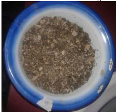
Fig. 4.27. Cubrimiento del árido con 0% de agua de premezcla.
