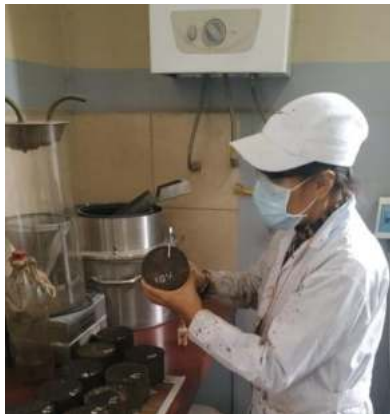
Fig. 4.40. Medición de la altura de las briquetas.
