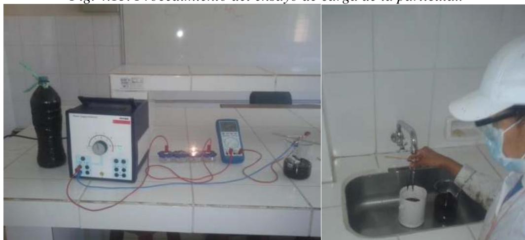
Fig. 4.13. Procedimiento del ensayo de carga de la partícula..
