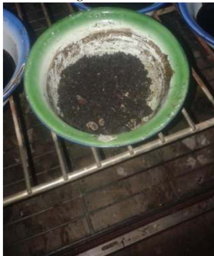
Fig. 4.32. Curado de 100 gr de mezcla en el horno, por 24 hrs.
