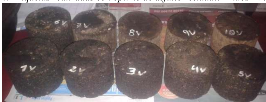
Fig. 4.78. Briquetas realizadas con óptimo de asfalto residual: Áridos "Vargas".
