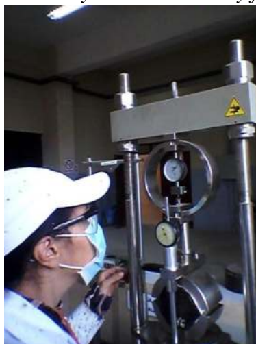
Fig. 4.44. Ensayo de estabilidad y fluencia.
