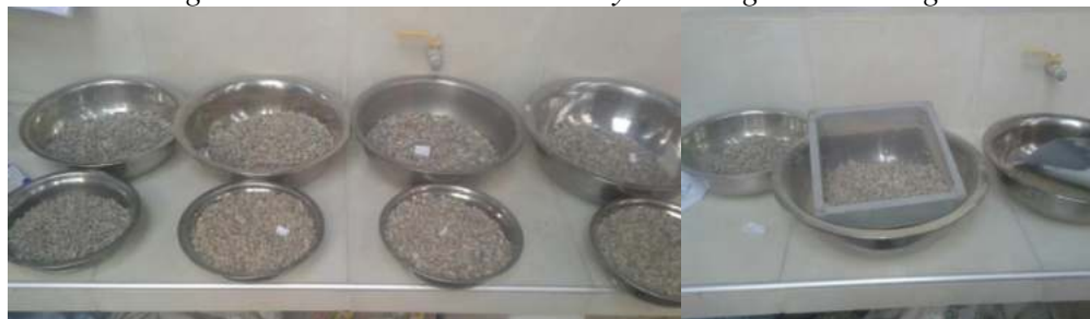
Fig. 4.9. Procedimiento del ensayo de desgaste Los Ángeles.
