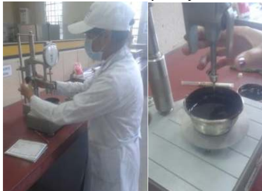
Fig. 4.17. Procedimiento del ensayo de penetración.
