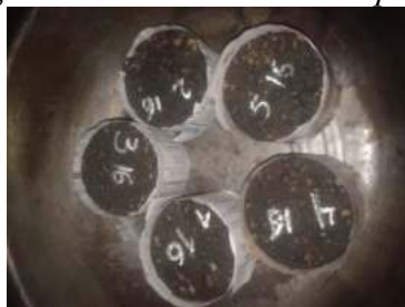
Fig. 4.43. Forrado de las briquetas.
