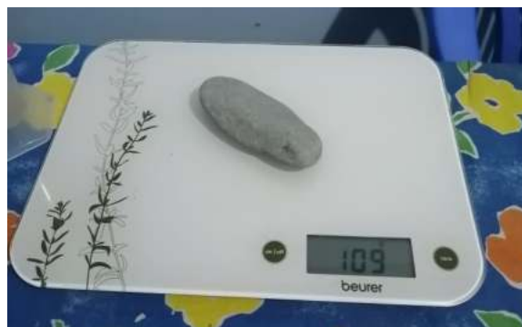
Fig. 3.12. Obtención del peso de los agregados.
