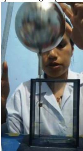
Fig. 3.9. Procedimiento para cargar positivamente al electroscopio.
