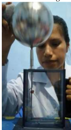
Fig. 3.11. Determinación de la carga eléctrica del agregado.
