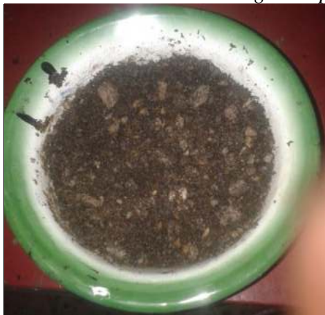
Fig. 4.29. Cubrimiento del árido con 2% de agua de premezcla.
