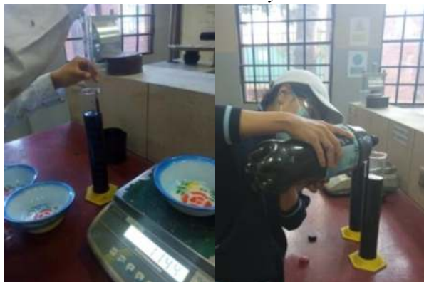
Fig. 4.15. Procedimiento del ensayo de sedimentación.
