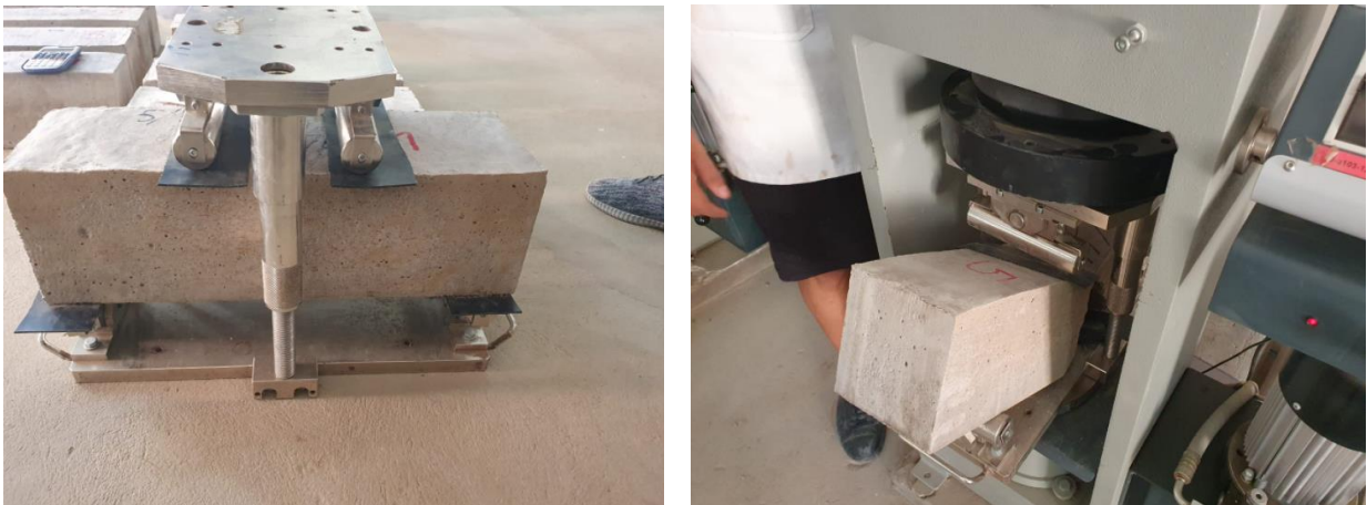
Figura 12: Ensayo a Flexotracción
