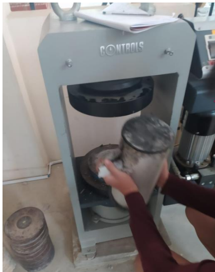
Figura 10: Ensayo de Rotura a Compresión
