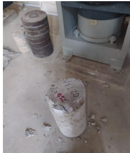
Figura 10: Ensayo de Rotura a Compresión
