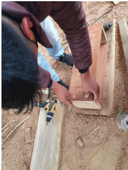
Figura 9: Elaboración de los Moldes para las Probetas Prismáticas
