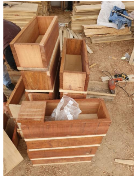
Figura 9: Elaboración de los Moldes para las Probetas Prismáticas
