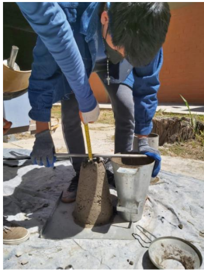
Figura 8: Ensayo de Revenimiento
