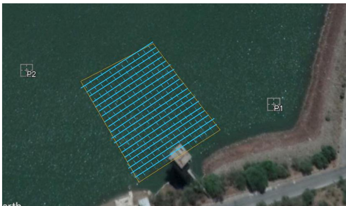
Figura 27. Líneas de sondeo longitudinales y transversales.
