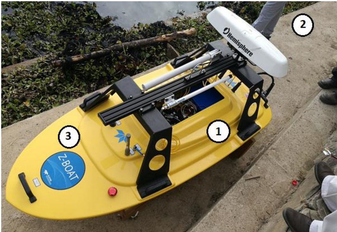
Figura 26. Componentes del equipo para medición batimétrica Z-BOAT 1800.
