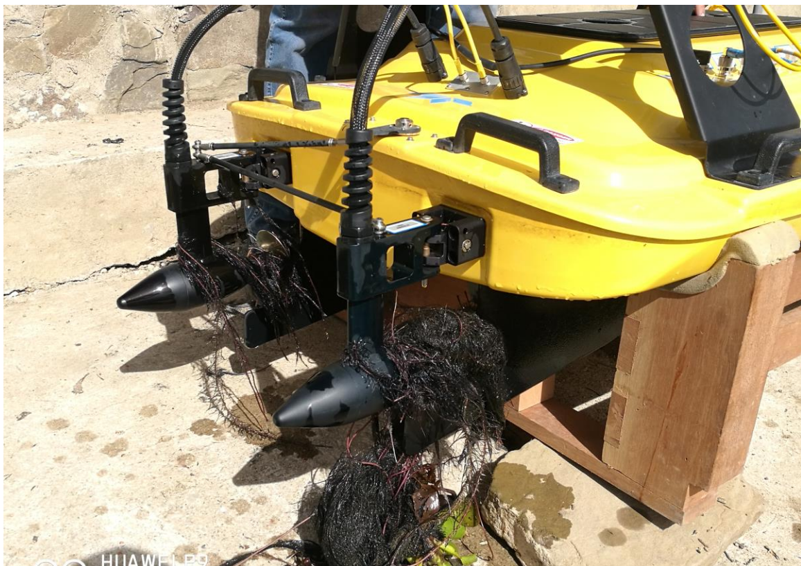
Anexo II. 4. Raíces de “Jacintos” atascadas en las hélices del Z-Boat.
