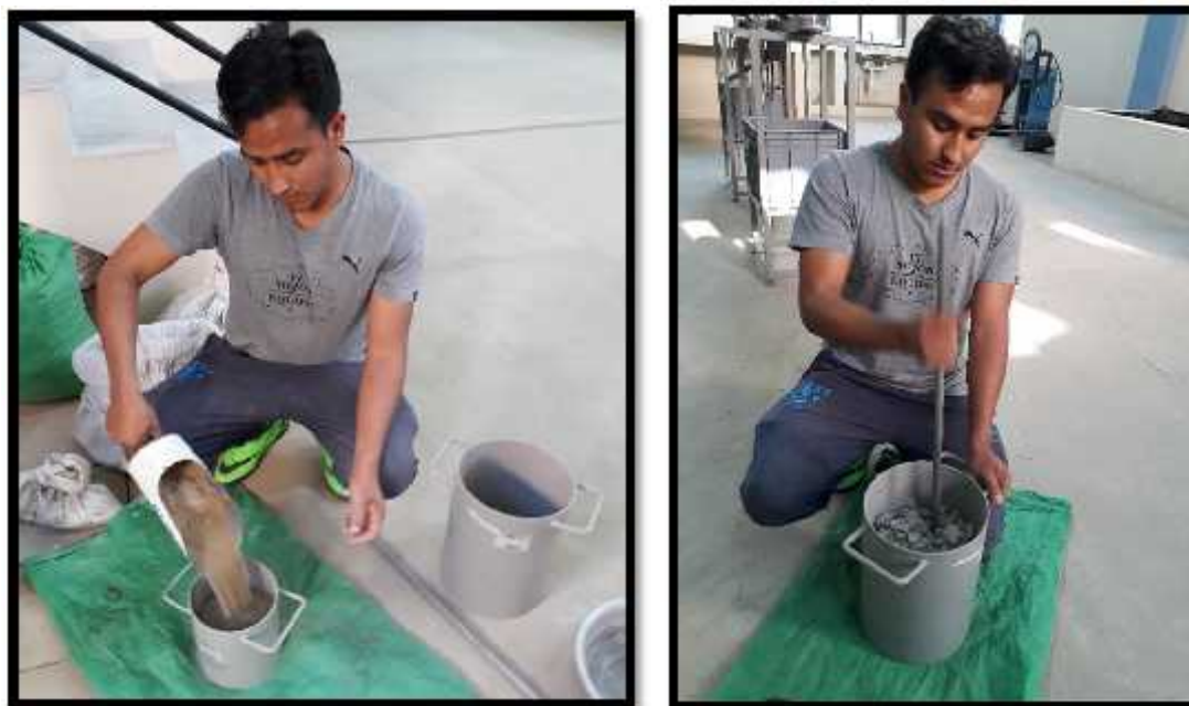
Figura 3.14 Ensayo del peso unitario del agregado grueso y fino.
