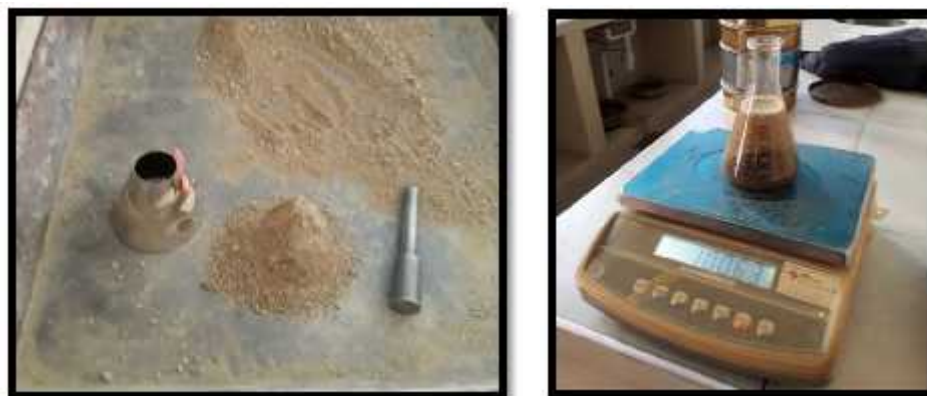
Figura 3.13 Determinando el peso específico de la arena.
