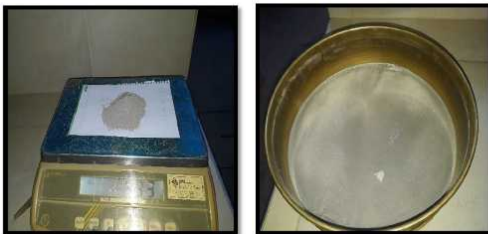
Figura 3.16 Ensayo de la finura del cemento portland.
