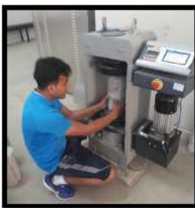
Figura 4.9 Prensa hidráulica para ensayo de compresión de probetas.
