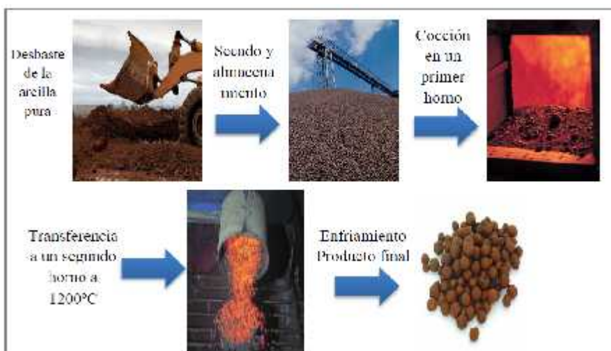
Figura 2.3 Proceso de fabricación de la arcilla expandida
