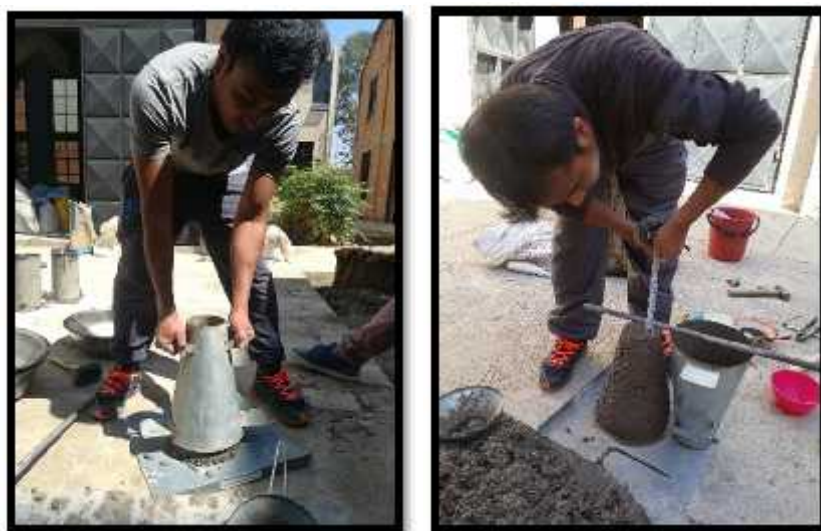
Figura 4.4 Proceso para medir el asentamiento
