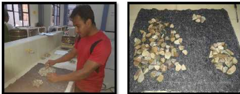
Figura 3.15 Ensayo del porcentaje de caras fracturadas.
