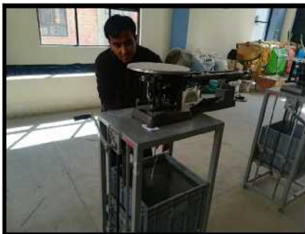
Figura 3.12 Proceso del peso sumergido.
