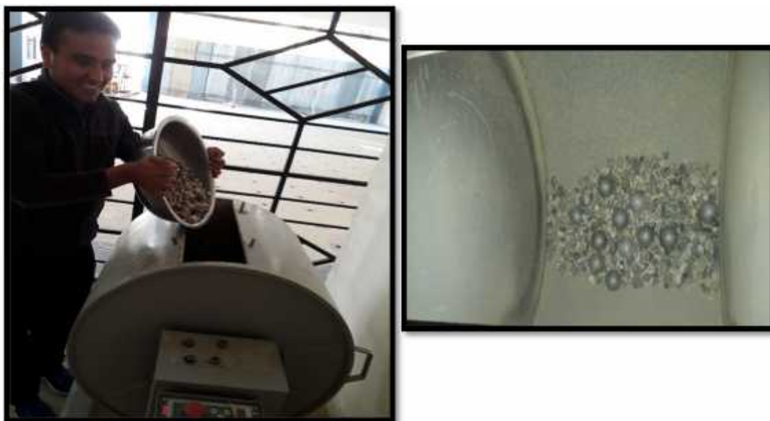
Figura 3.10 Desgaste por medio de la máquina de los Ángeles.
