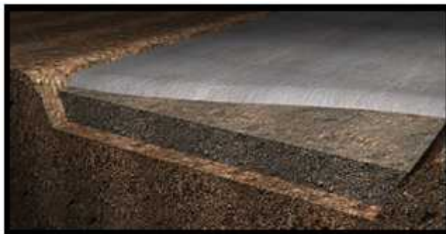
Figura 2.11 Pavimento rígido simple
