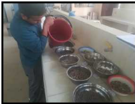
Figura 3.11 Preparación de la muestra con la solución de sulfato de sodio.
