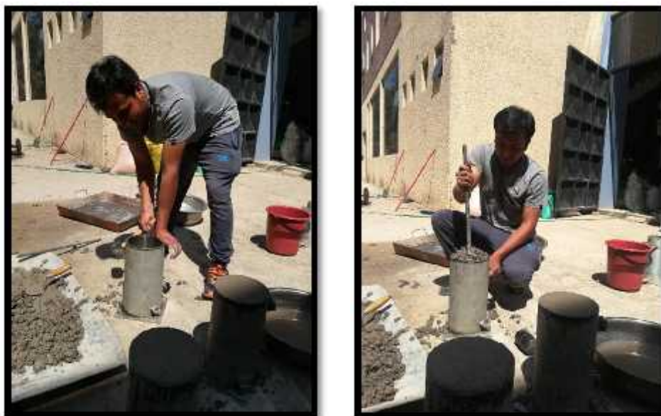
Figura 4.5 Proceso para el llenado de los moldes
