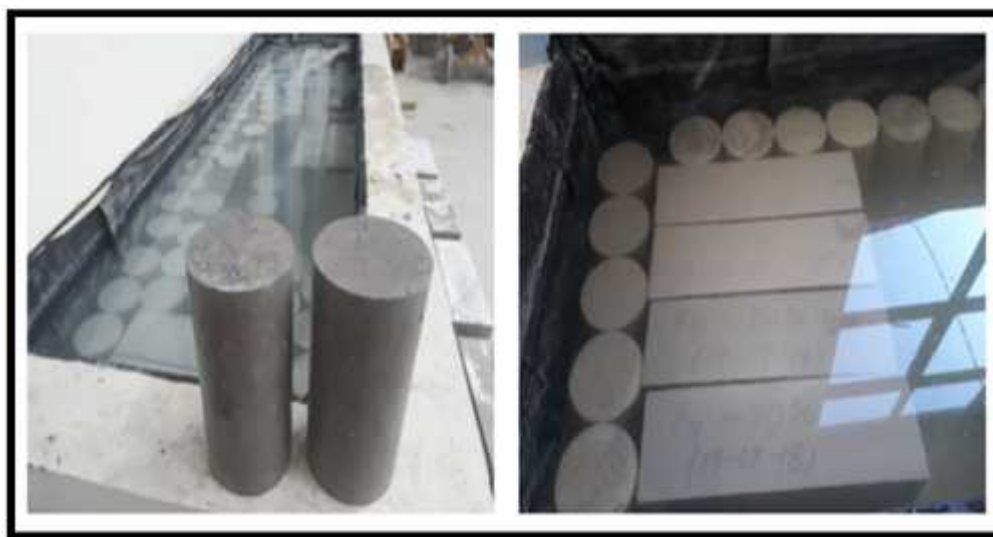
Figura 4.8 Proceso de curado de las probetas
