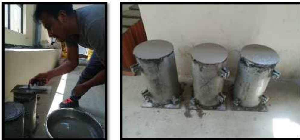
Figura 4.6 Proceso de enrase y su posterior fraguado
