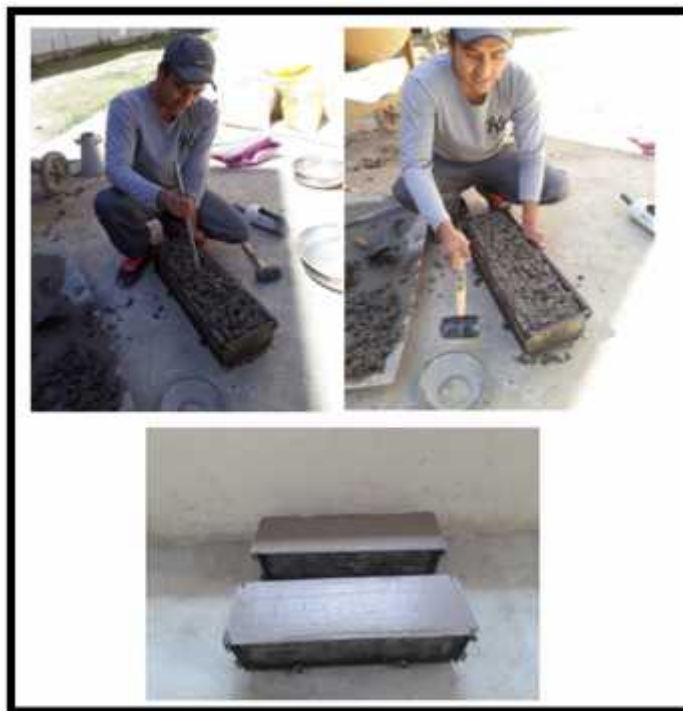
Figura 4.7 Proceso de elaboración de probetas prismáticas (Vigas)
