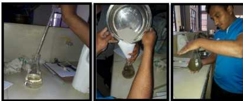
Figura 3.17 Ensayo del peso específico del cemento portland.
