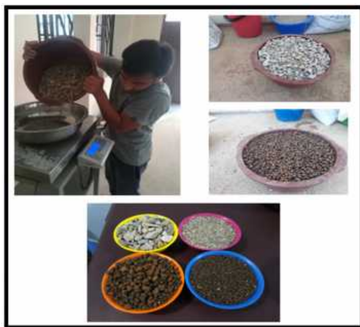
Figura 4.1 Muestra del reemplazo en volumen de los agregados con arcilla expandida
