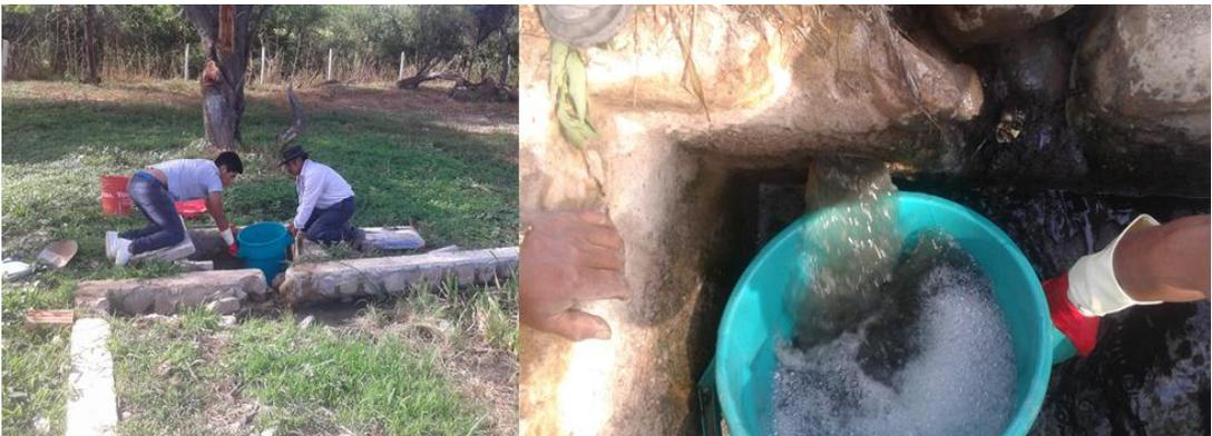
**Tomas de muestras de agua (afluente, efluente de la PTAR y cuerpo receptor río Camacho)**
