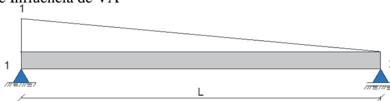
$$V_{1, \text{ Camión}} = P_1(1) + P_2 \cdot \left(1 - \frac{a}{L}\right) + P_3 \cdot \left(1 - \frac{a+b}{L}\right) \rightarrow V_{1, \text{ Camión}} = 294,18 \text{ kN}$$
