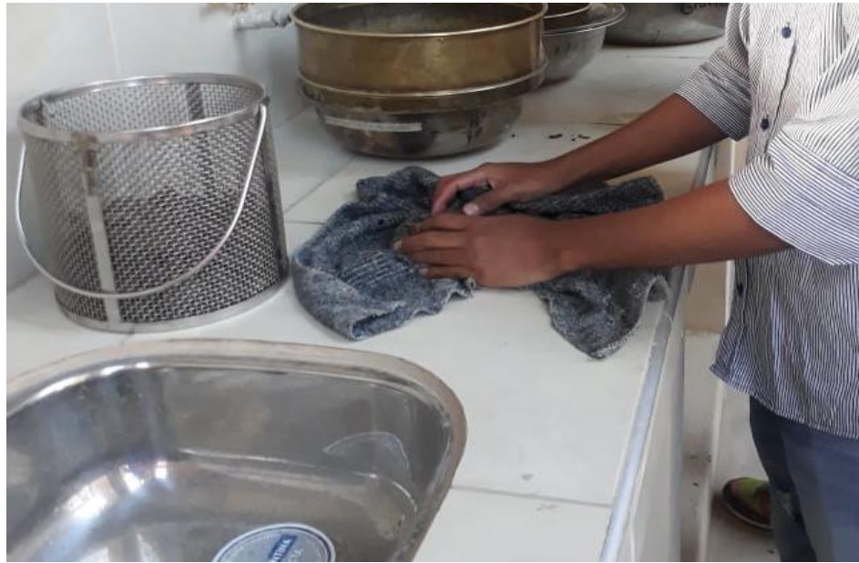
Imagen 3.28. Colocando la muestra al canastillo para realizar el peso totalmente saturado
