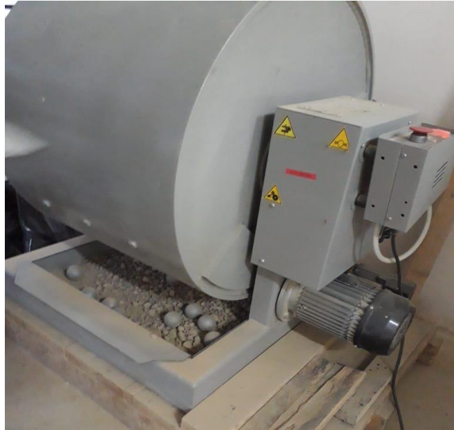
Imagen 3.31. Retiro del material de la máquina de los Ángeles después de las 500 revoluciones
