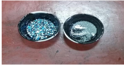
Imagen 4.8. Polímeros pesados para introducir a la emulsión asfáltica
