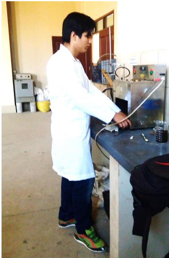
Imagen 3.36. Preparando el viscosímetro “Saybolt Furol” para la prueba
