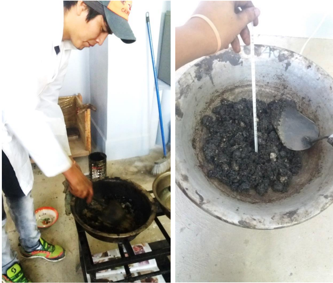
Imagen 4.3. Mezclando la mezcla asfáltica y controlando la temperatura
