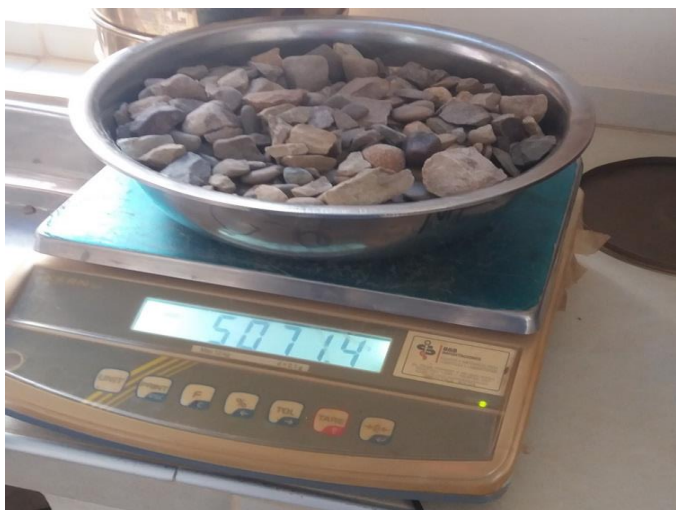
Imagen 3.25. Dejando muestra en horno de aproximadamente 5 kg durante 24 horas
