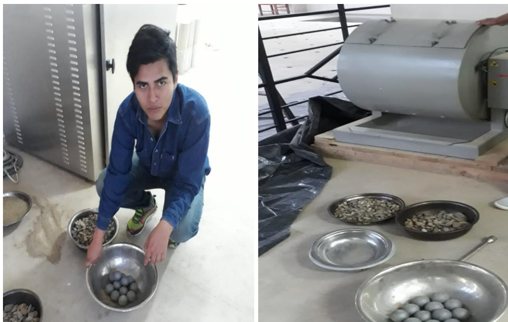
Imagen 3.30. Preparación y colocación de la muestra en la máquina de los ángeles con el número de esferas correspondiente de acuerdo a la gradación del material
