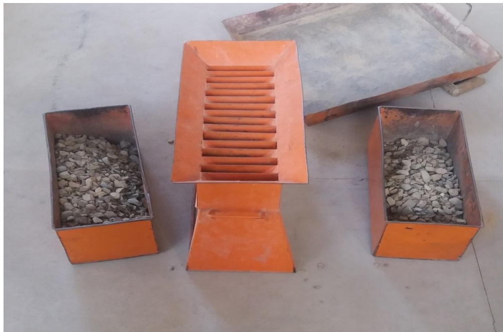
Imagen 3.11. Muestra después de ser cuarteada
