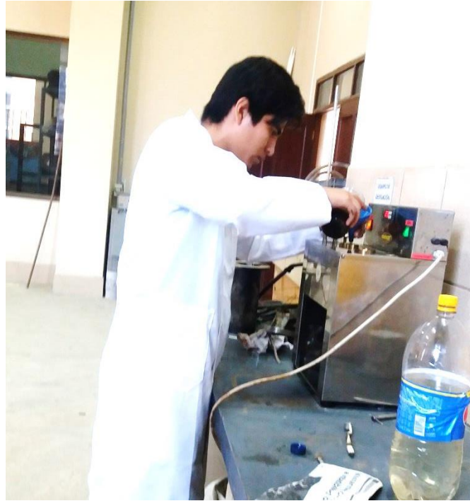
Imagen 3.37. Introduciendo la emulsión al orificio “Furol” con tapones en la parte del fondo
