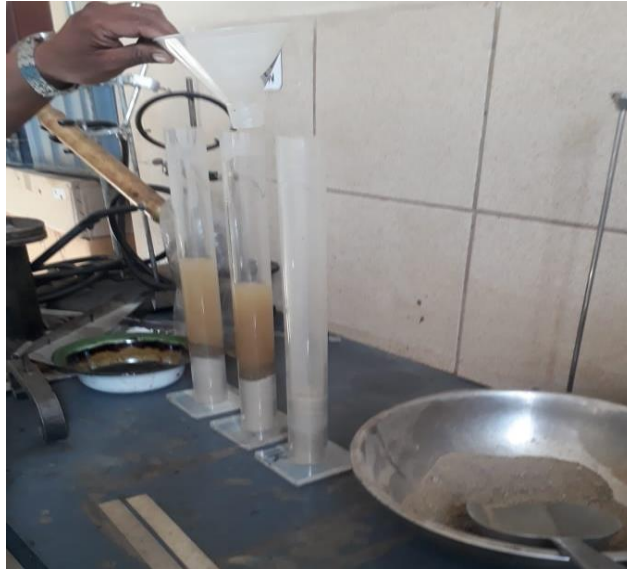
Imagen 3.34. Colocación de la muestra con solución dentro de la probeta
