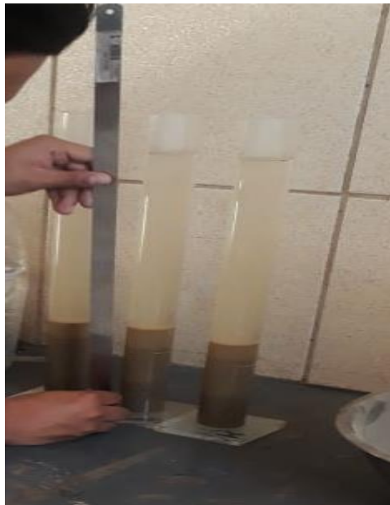
Imagen 3.35. Obtención de las lecturas H1 y H2 en la muestra después del ensayo
