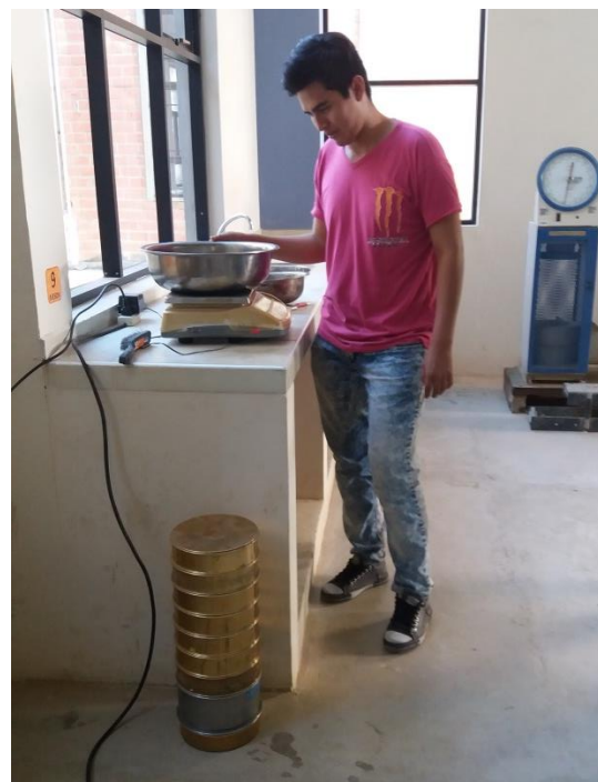
Imagen 3.16. Peso del material para la granulometría en este caso arena
