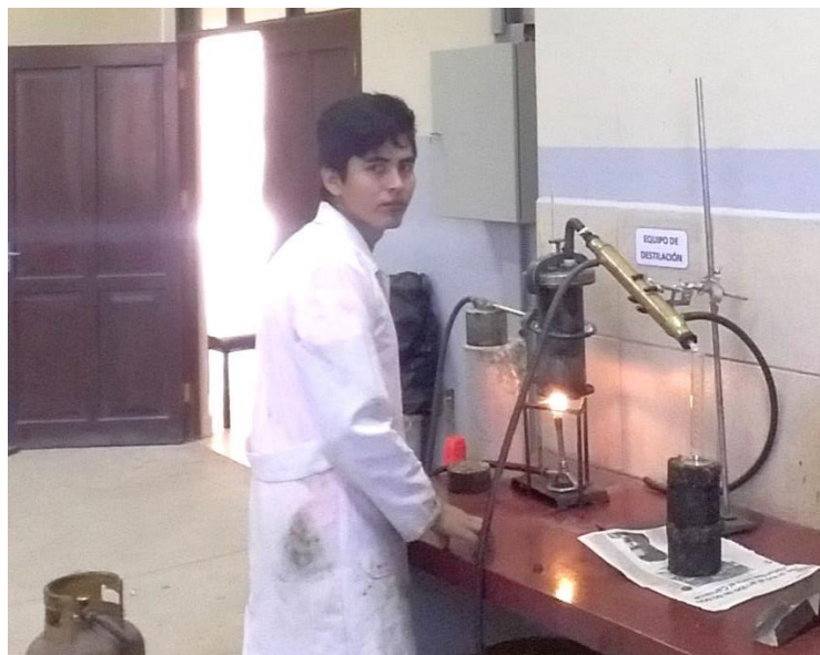
Imagen 3.40. Equipo de destilación armado y en funcionamiento
