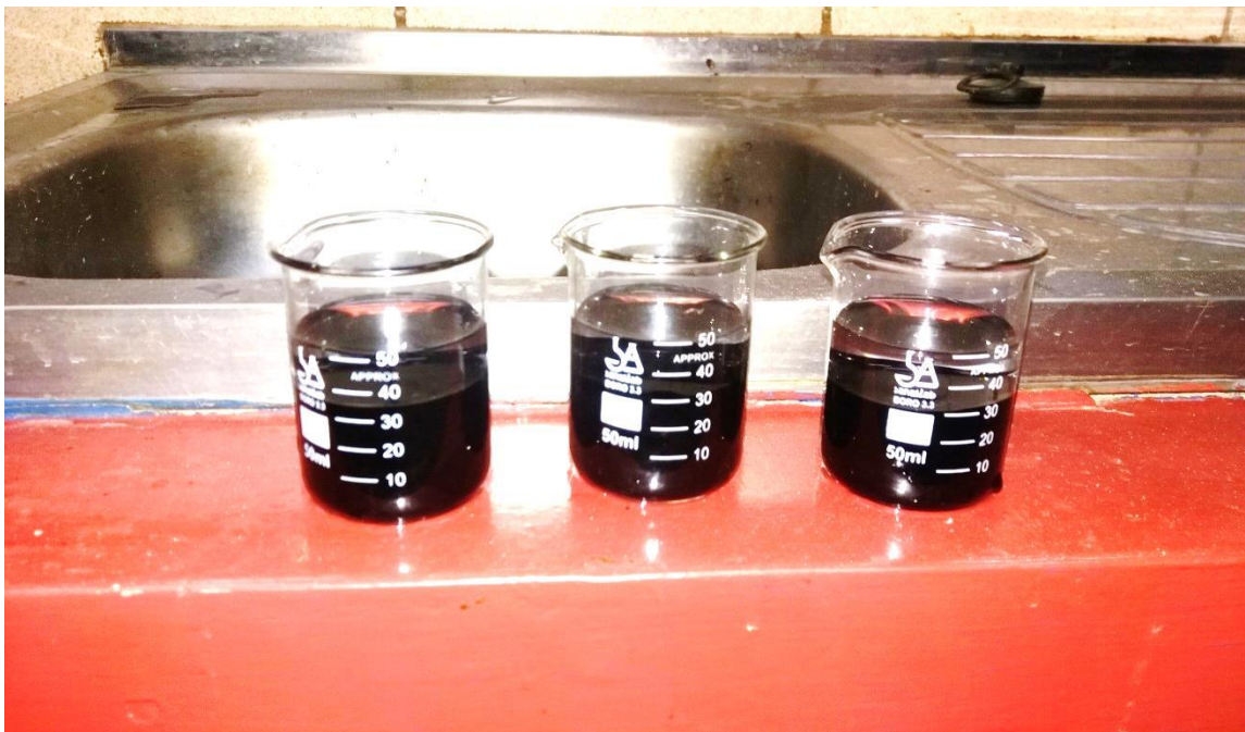
Imagen 3.43. Residuo de la emulsión asfáltica más agua destilada para colocarlos en un baño María a 25°C
