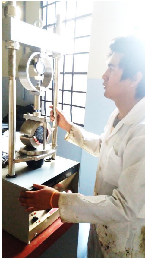
Imagen 4.14. Leyendo la “Estabilidad y Fluencia” en el momento de la ruptura
