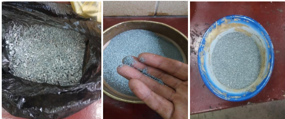
Imagen 4.6. Fibras extraídas después de la trituración y tamizadas por el tamiz N°200
