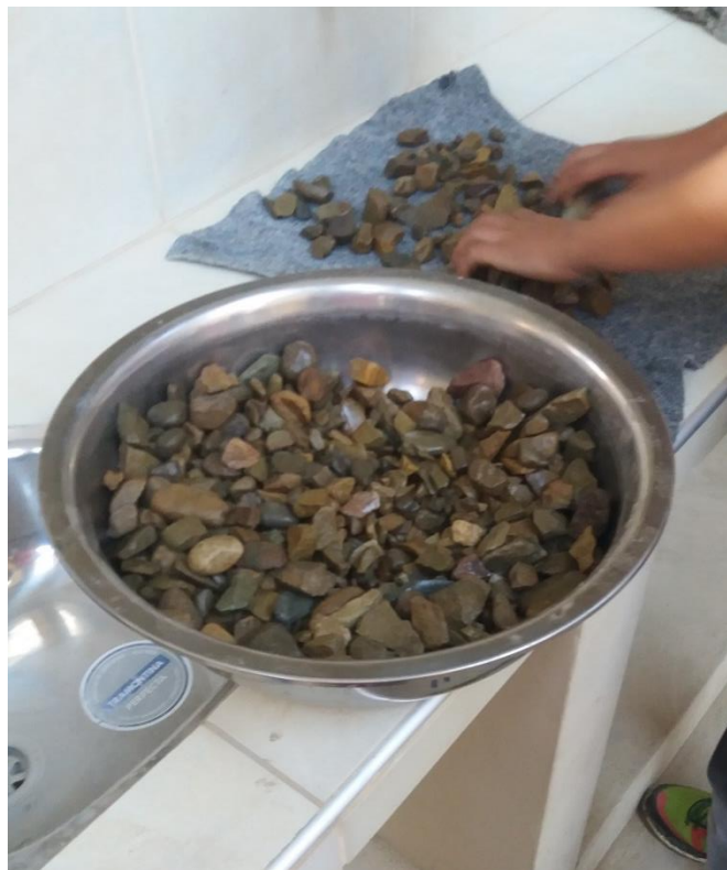
Imagen 3.27. Secando la muestra externamente para su peso superficialmente seco
