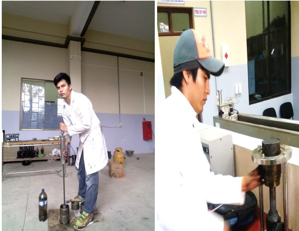
Imagen 4.5. Compactación y extracción de las briquetas
