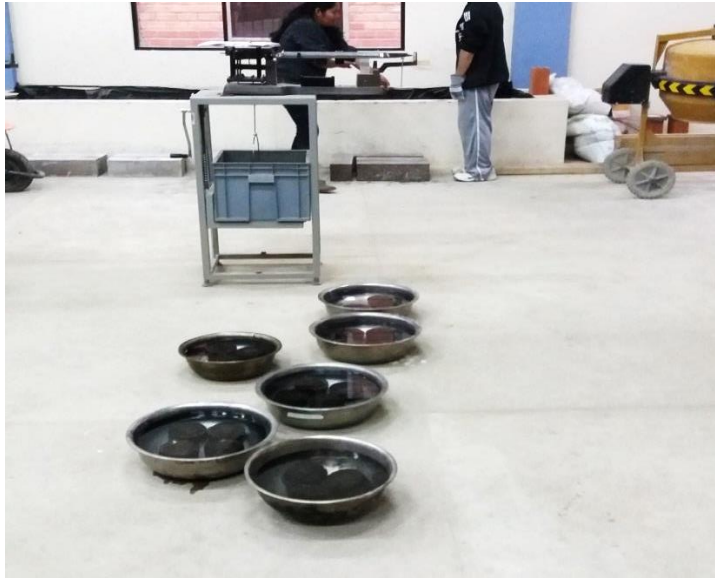
Imagen 4.11. Briquetas sumergidas en agua a 25°C
