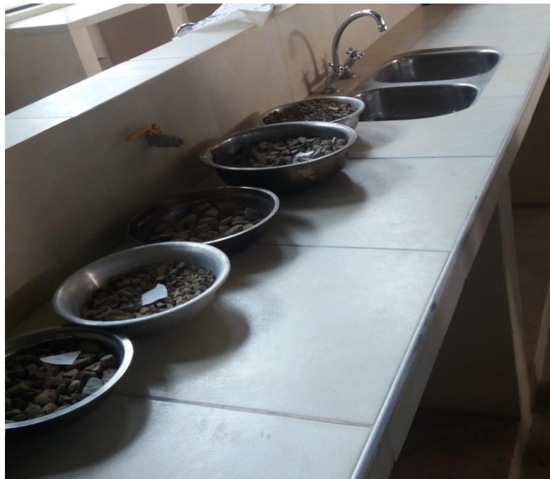
Imagen 3.32. Lavado y tamizado del material por el tamiz N°12
