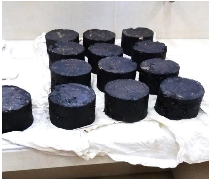
Imagen 4.12. Secando superficialmente las briquetas
