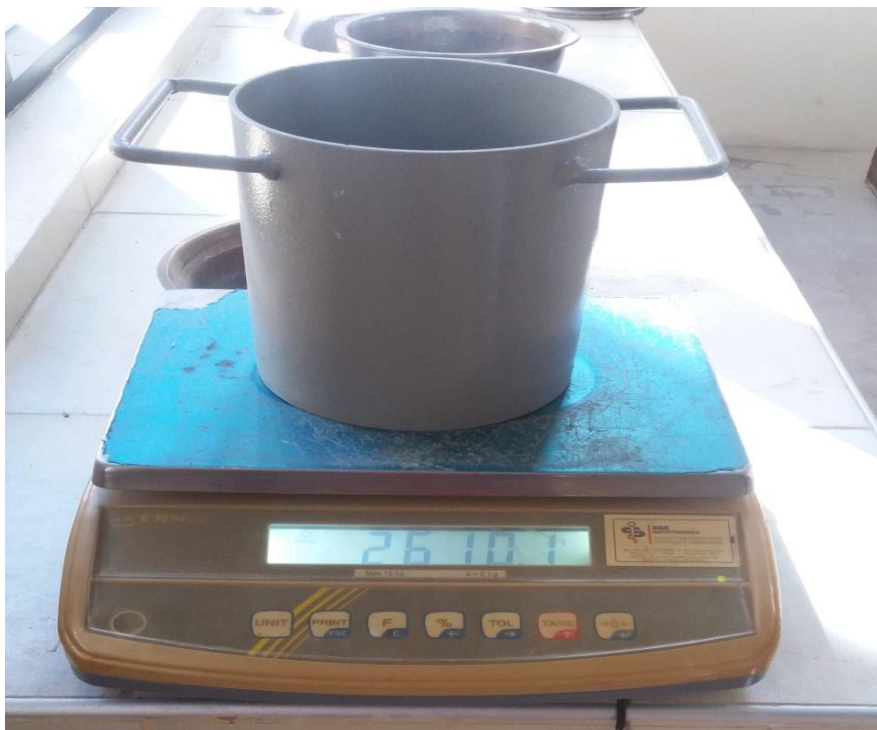
Imagen 3.12. Pesando los moldes vacíos para realizar la práctica
