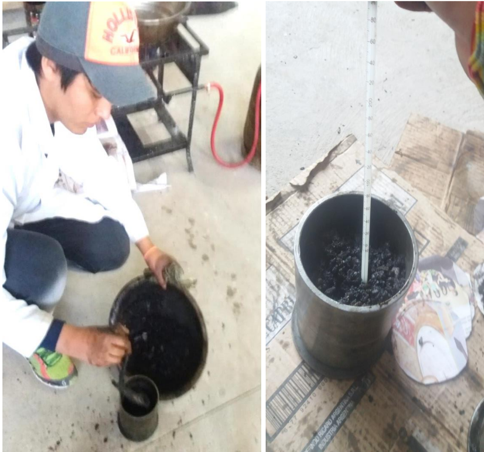
Imagen 4.4. Introduciendo al molde la mezcla en 3 capas y controlando la temperatura de compactación
