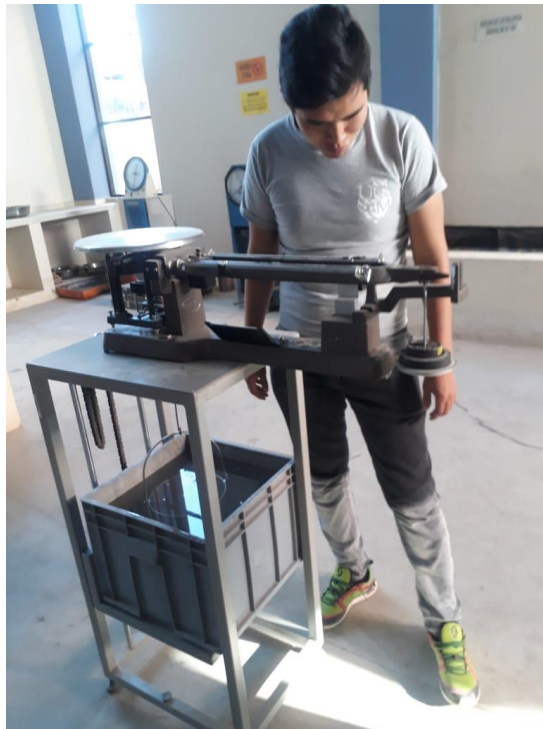
Imagen 3.29. Pesando la muestra totalmente saturada
