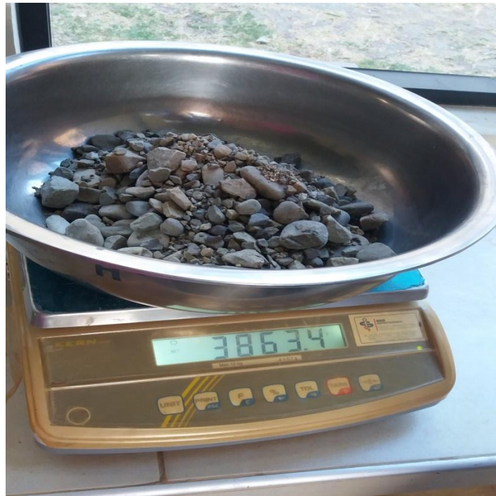
Imagen 3.33. Pesado del material después del lavado y secado en horno (24 horas)
