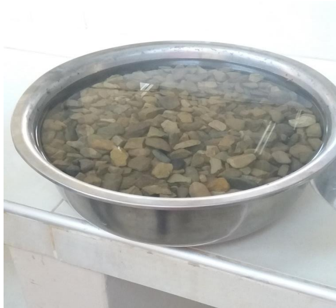
Imagen 3.26. Dejando la muestra en agua durante 24 horas
