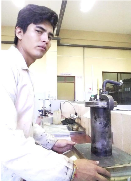
Imagen 3.39. Pesando el equipo de destilación más los 200 gramos de emulsión
