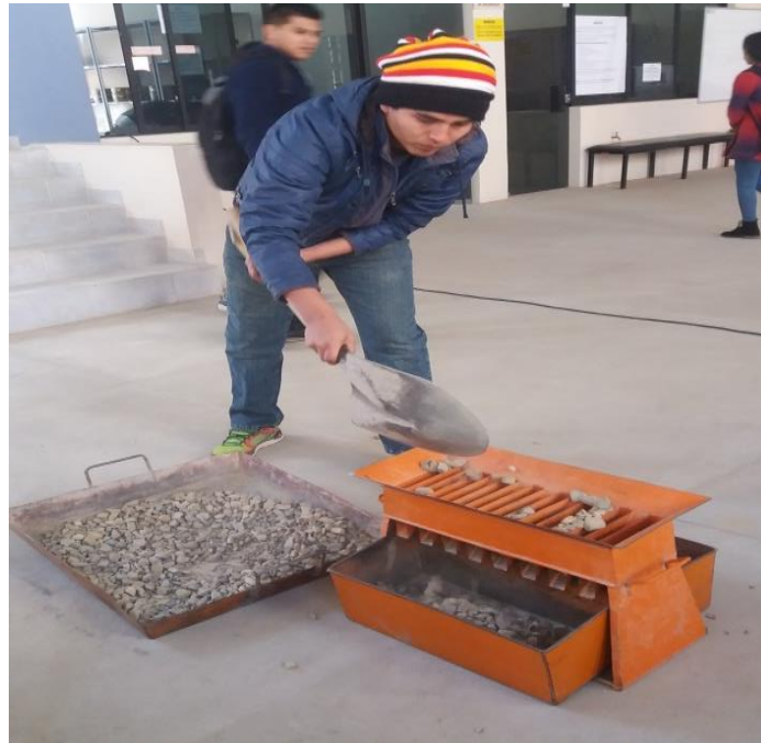
Imagen 3.10. Distribuyendo la muestra seleccionada en el cuarteador mecánico
