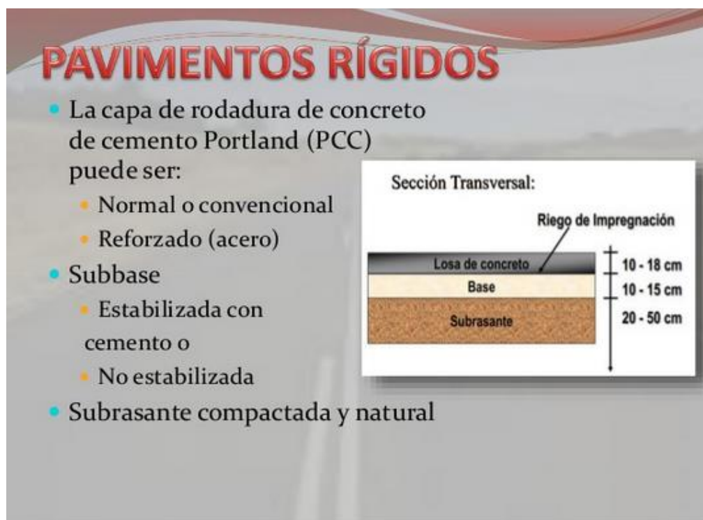
Figura N° 2: Capas del pavimento rígido
