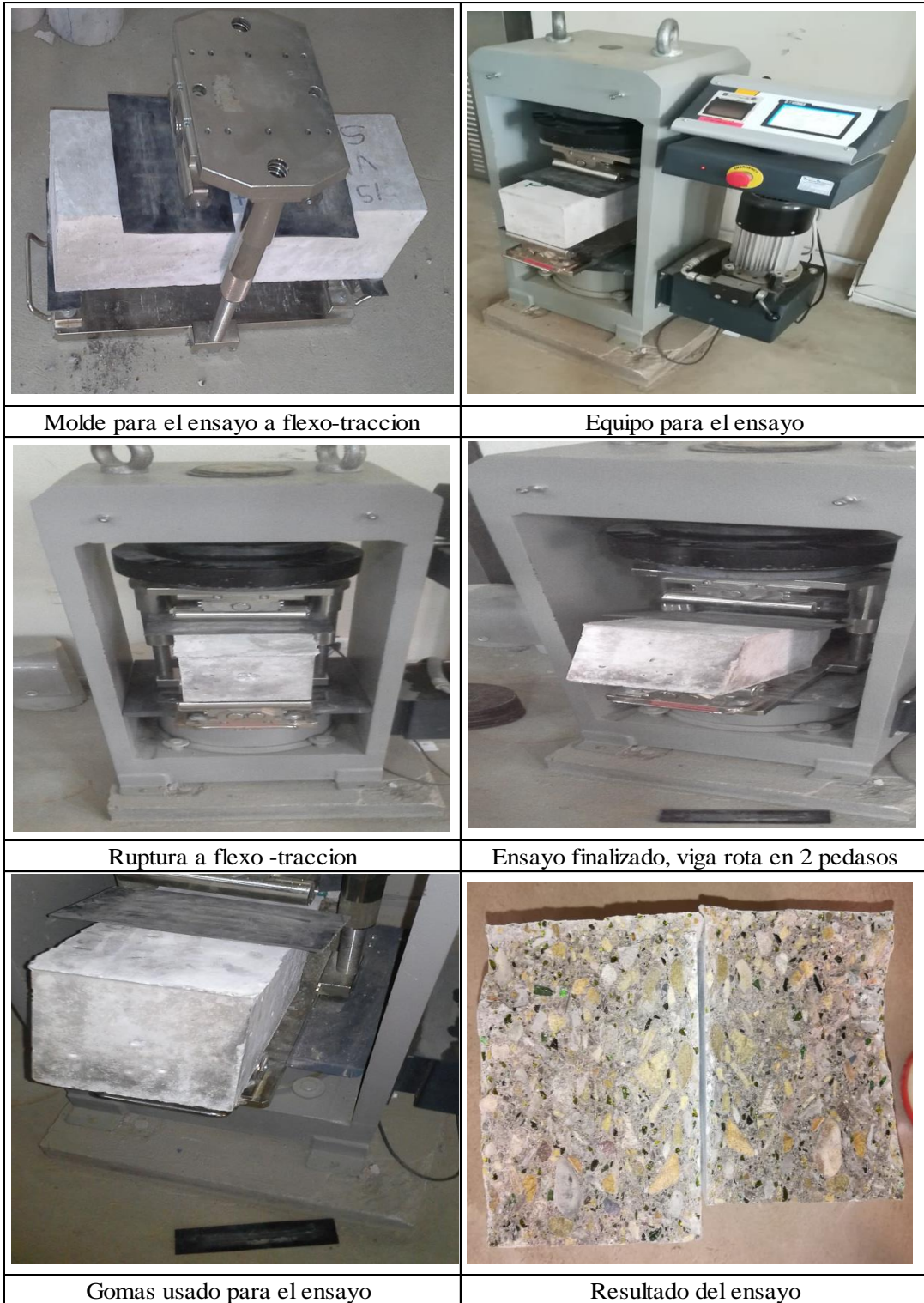
Figura N° 34: Ensayo Flexo – Tracción
