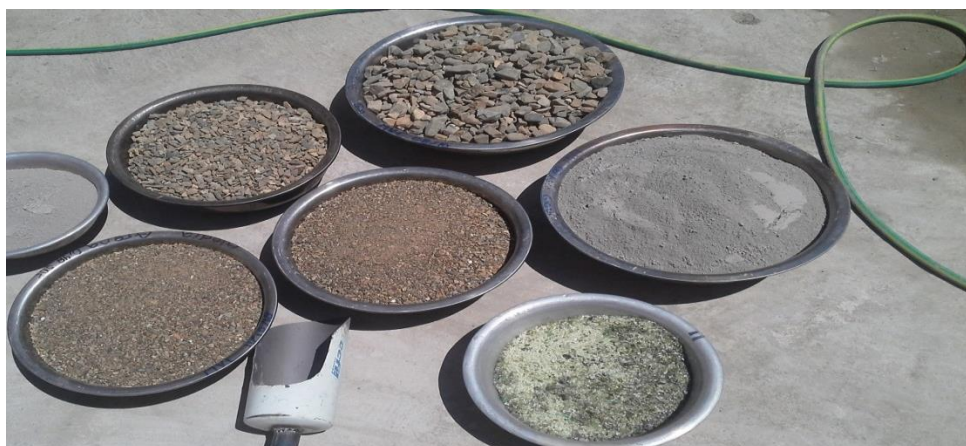
Figura N° 27: Materiales pesados para la respectiva mezcla
