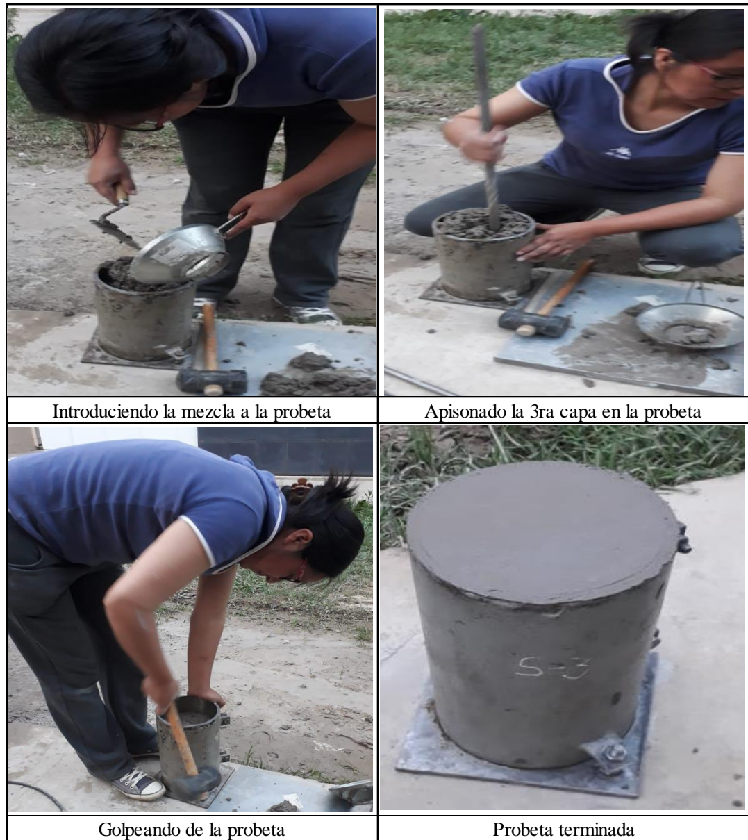
Figura N° 30: llenado de la probeta de hormigón
