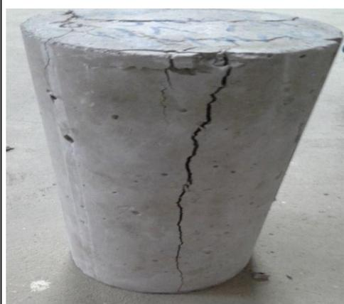
Fisura de la probeta
