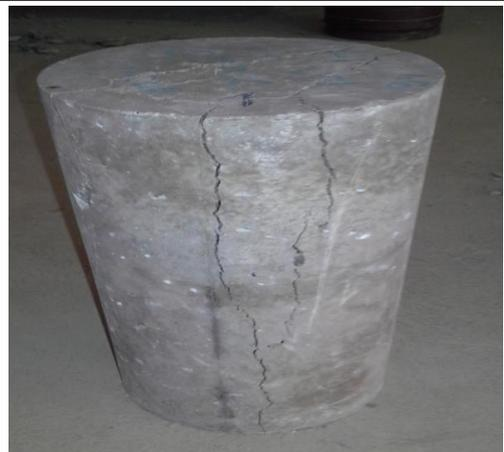
Fisura del ensayo a compresión
