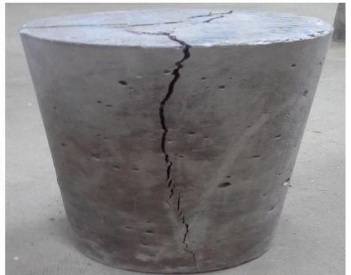
Fisura del ensayo a compresión
