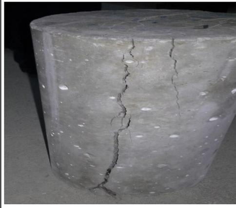
Fisura de la probeta
