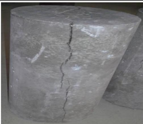
Fisura del ensayo a compresión
