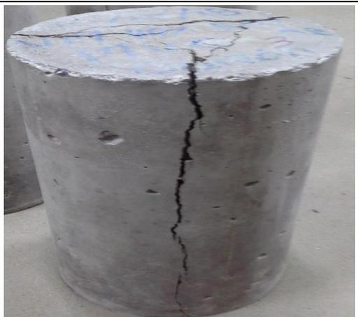
Fisura del ensayo a compresión
