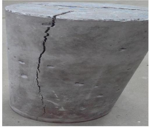
Fisura del ensayo a compresión
