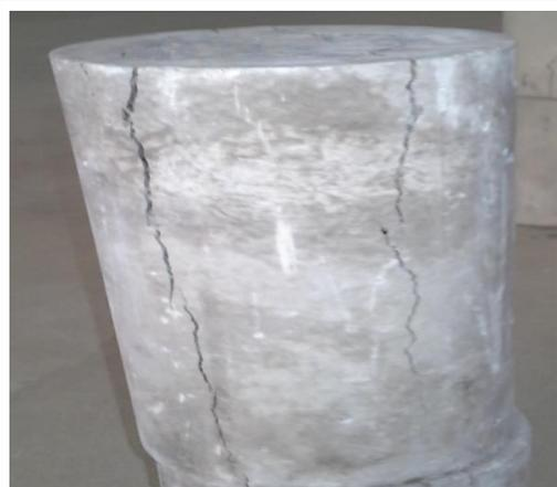
Fisura del ensayo a compresión
