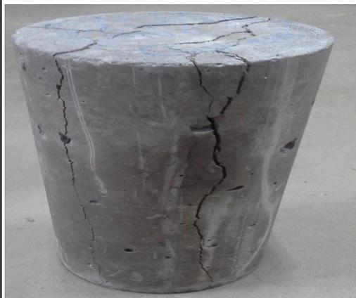
Fisura del ensayo a compresión
