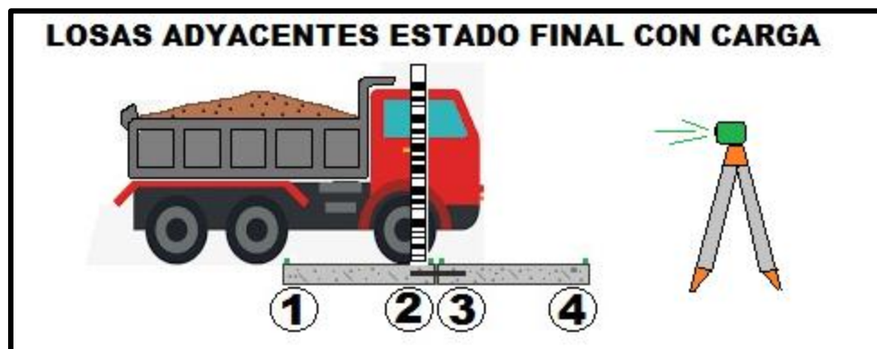
Figura 3. 16. Estado final de medición
