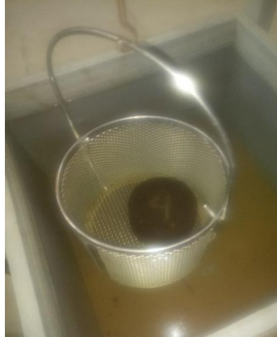
Imagen 3. 13 Peso de la muestra sumergida
