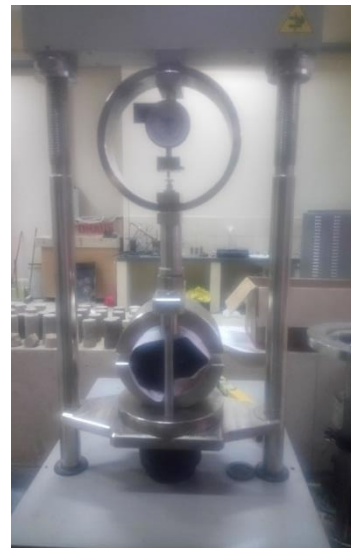
Imagen 3. 14 Rotura de probetas en la máquina Marshall
