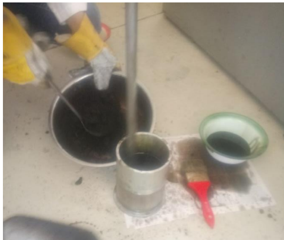
Imagen 3. 10 Vaciado de la mezcla en la probeta
