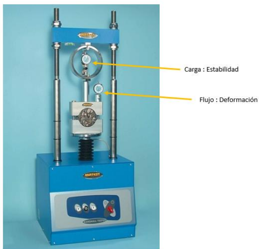
Dispositivo para el ensayo de estabilidad y fluencia Marshall
