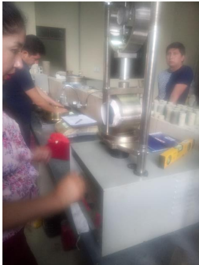
Imagen 3. 14 Rotura de probetas en la máquina Marshall
