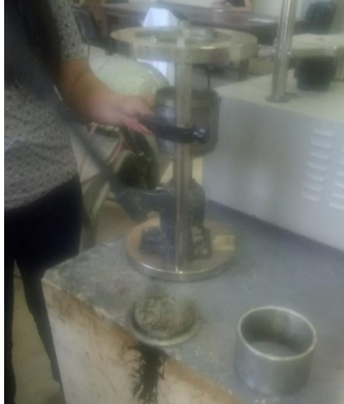
Imagen 3. 11 Desmoldado de las probetas
