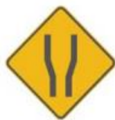
SP-41 ENSANCHE SIMÉTRICO DE LA CALZADA
