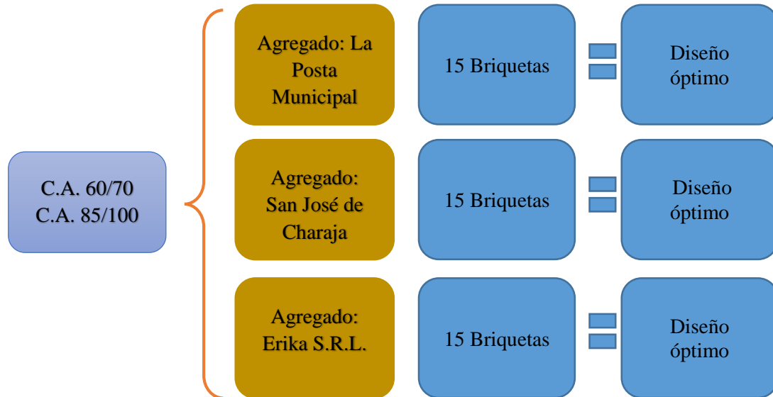
Figura 1.5: Elaboración de briquetas para encontrar el contenido óptimo de cemento asfáltico
