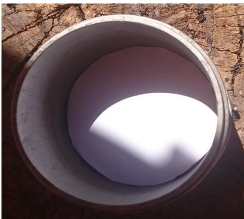
Figura 3.19: Molde cilíndrico con papel en la base
