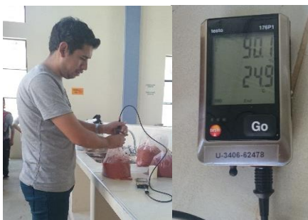
Figura 3.29: Midiendo el % de humedad de las briquetas
