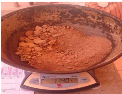
Figura 3.12: Pesando los agregados para preparar la mezcla asfáltica
