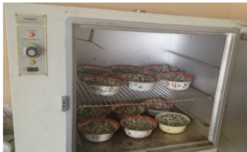
Figura 3.13: Agregado pesados calentando dentro del horno
