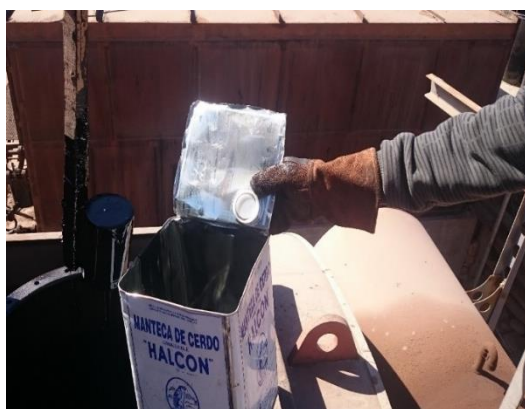
Figura 3.11: Recepción de muestras de C.A. 60/70
