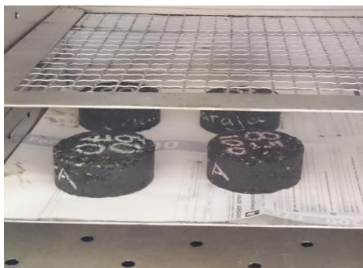
Figura 3.32: Probetas sometidas a calor para bajar la humedad
