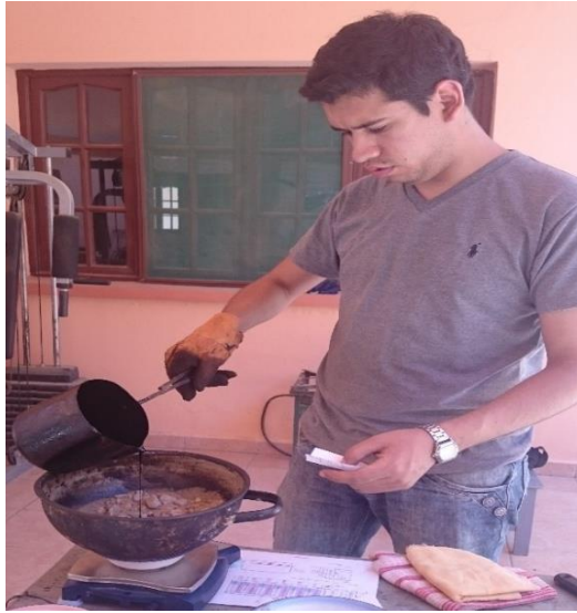
Figura 3.15: Agregando ligante asfáltico a la muestra de árido calentada y pesada
