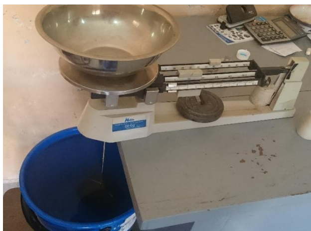
Figura 3.25: Briquetas pesadas sumergidas en agua a 25 °C.
