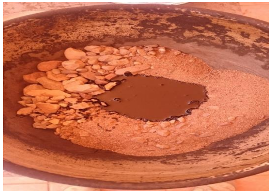
Figura 3.16: Árido con ligante asfáltico
