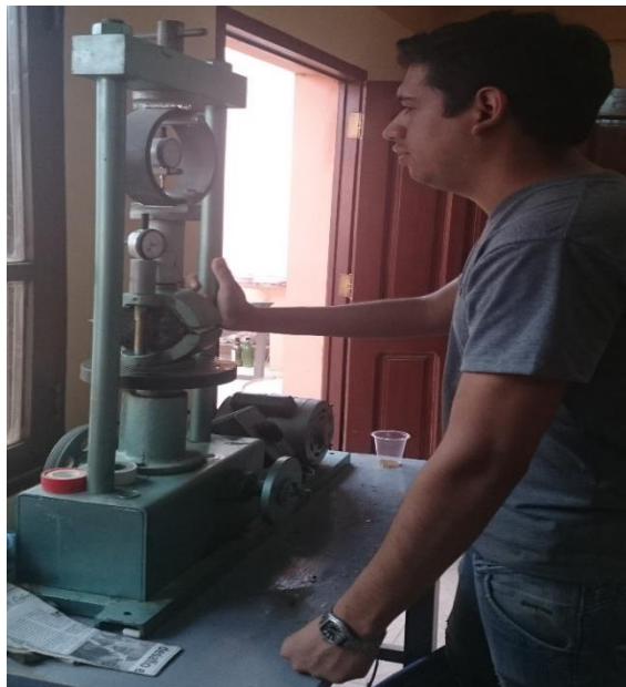
Figura 3.28: Lectura del dial de estabilidad (dentro del anillo Marshall) y el dial de deformación para el flujo.
