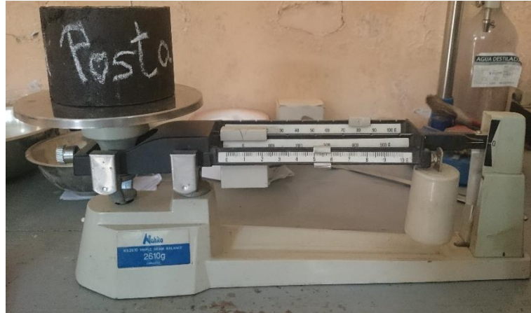
Figura 3.26: Briquetas pesadas condición saturada superficie seca
