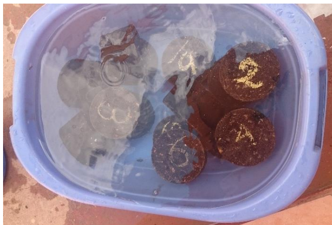
Figura 3.24: Briquetas sumergidas en agua a 25 °C.
