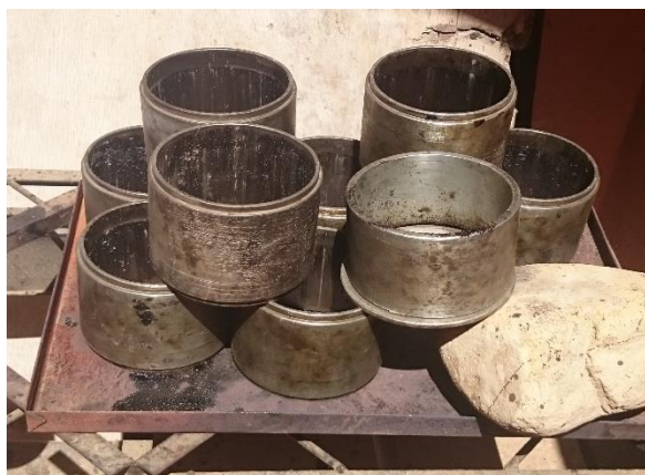
Figura 3.14: Moldes calentando antes del realizar los golpes
