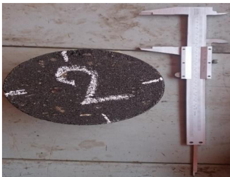
Figura 3.22: Midiendo alturas a briquetas
