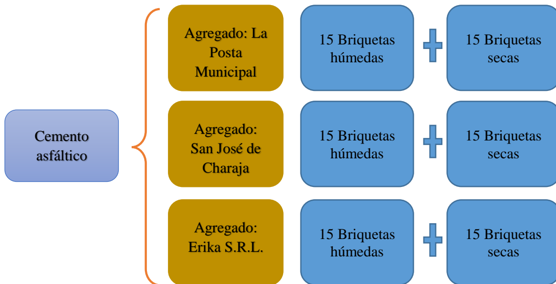
Figura 1.6: Elaboración de briquetas húmedas y secas
