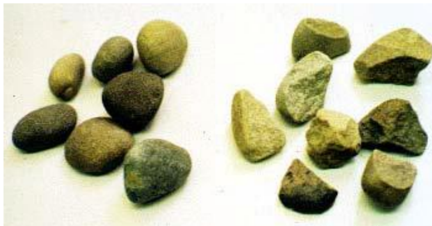
Figura 1.1: Angularidad de la fracción gruesa
