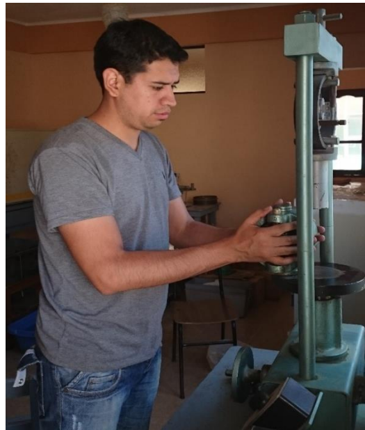
Figura 3.27: Colocado de briquetas en la mordaza Marshall
