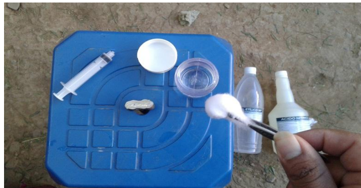
Foto 3.19. Dosificación para obtener Nital
