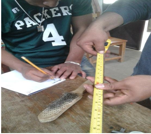
Foto 3.10. Medición de la longitud inicial
