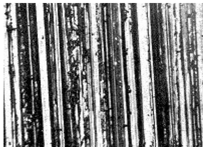
Fig. 2.14 Superficie obtenida luego de un desbaste grueso
