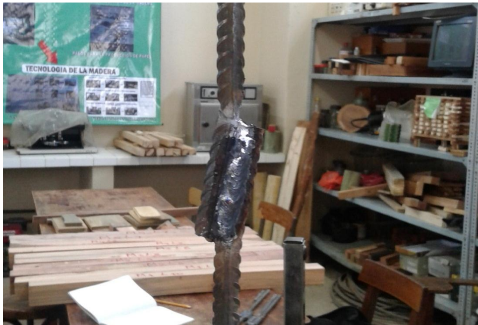
Foto 3.16. Ruptura de probeta soldado a solape
