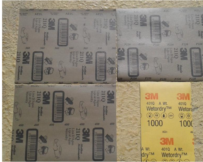
Foto 3.20. Lijas metálicas (N° 220, N° 360, N°400 y N°1000)
