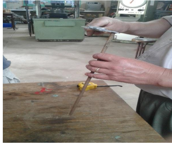
Foto 3.11. Medición del diámetro inicial
