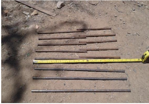
Foto 3.2. Empalme a solape
