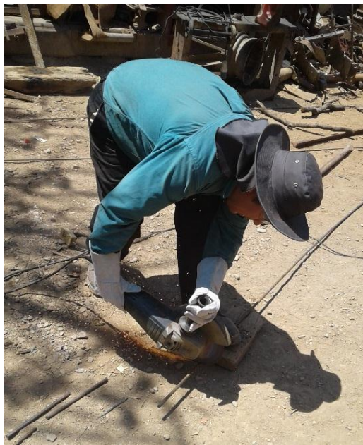
Foto 3.1. Cortado con amoladora Grande
