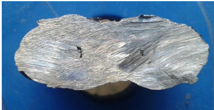
Foto 3.21. Sección transversal recién cortada con amoladora pequeña
