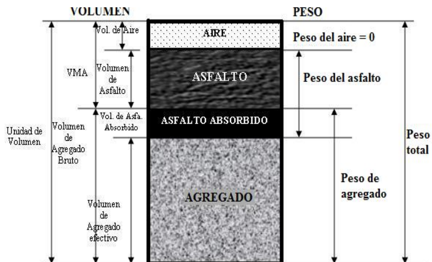
Figura 2.1. Diagrama de componentes de una mezcla asfáltica.
