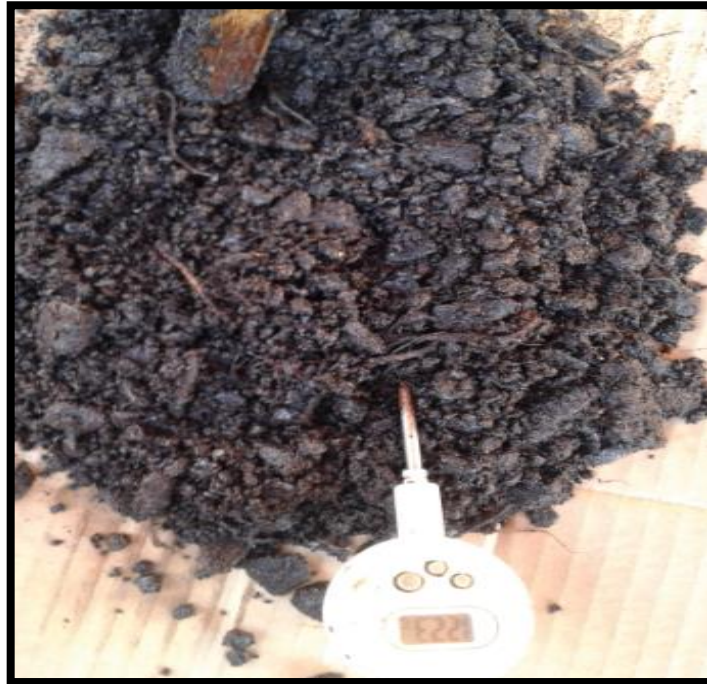
Cuadro B.28. Medición de la temperatura en la mezcla.
