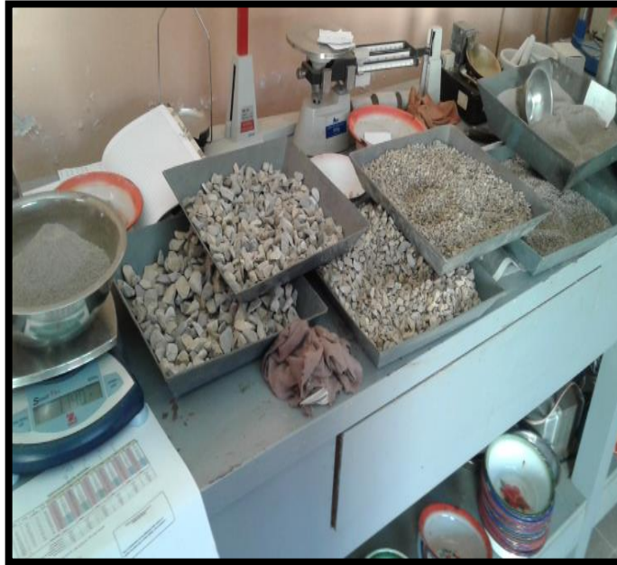
Cuadro B.26. Dosificación de los agregados para ensayo Marshall.
