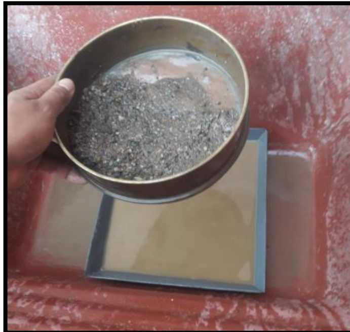
Cuadro B.6. Tamizado por lavado para arena con filler.
