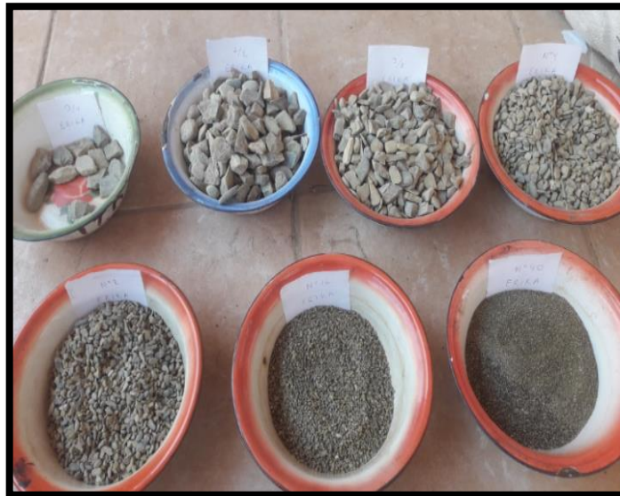
Cuadro B.16. Agregados sumergidos en solución con sulfato de sodio.
