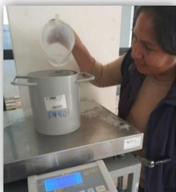
Imagen 3.24 Enrasado de molde con muestra suelta
