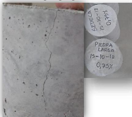
Imagen 3.50 Rotura de probeta cilíndrica con 1.00 % de fibra de polipropileno
