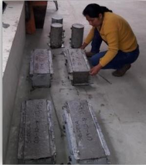
Imagen 3.45 Curado de probetas circulares
