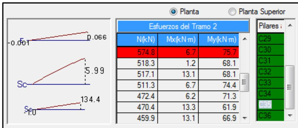
**Figura 3.20. Esfuerzos de diseño de la columna C35 (Fuente: CYPECAD 2016)**
