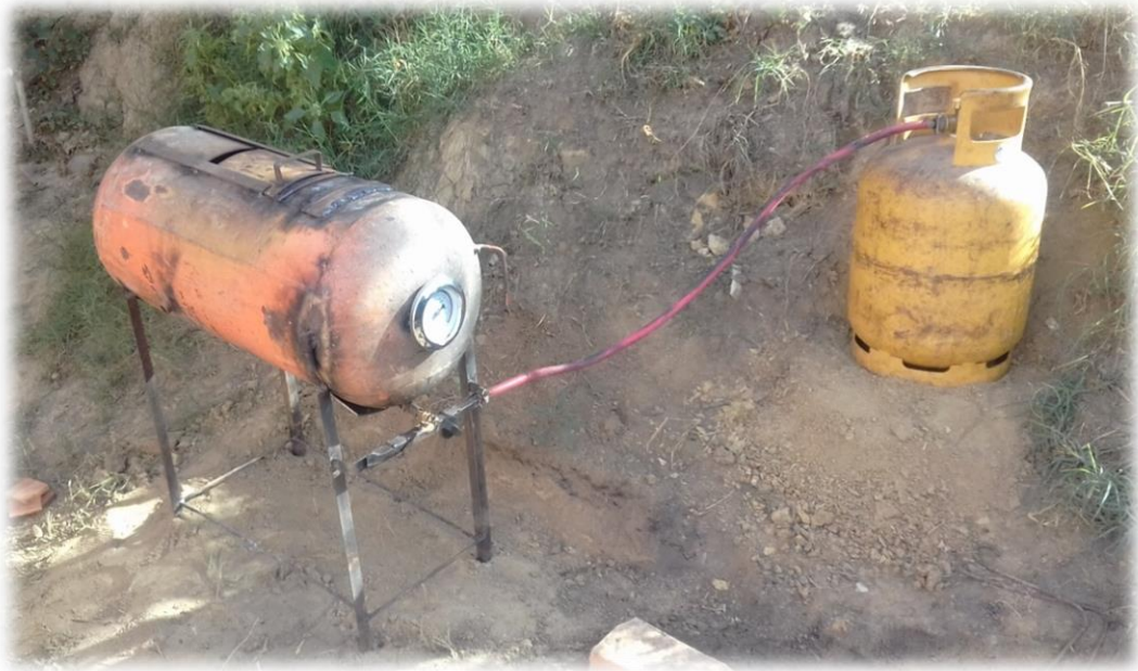
Instalación del horno y garrafa de GLP
