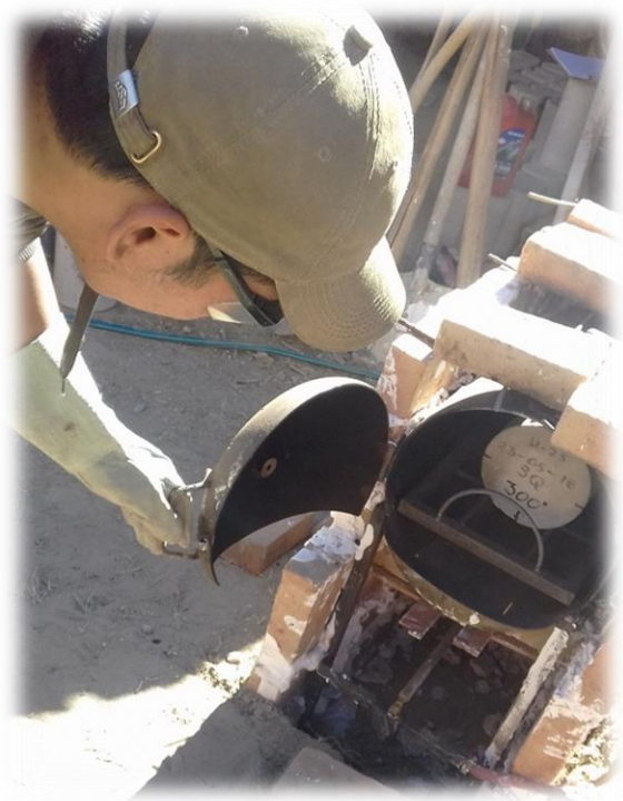
Extracción de la probeta del horno
