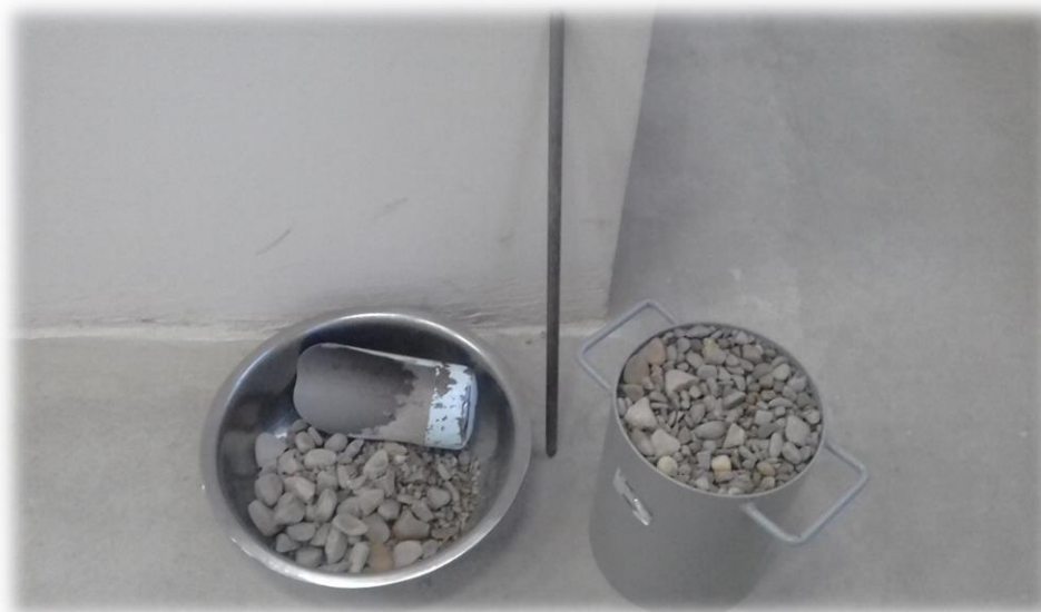
Llenado completo del material en el recipiente.
