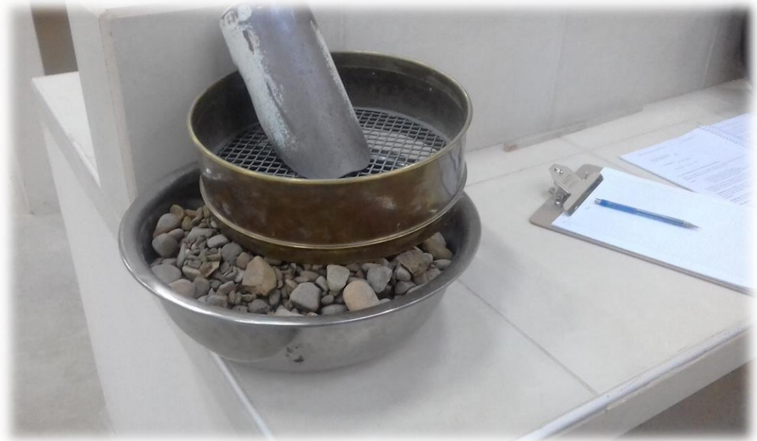
Preparación de la grava para el tamizado
