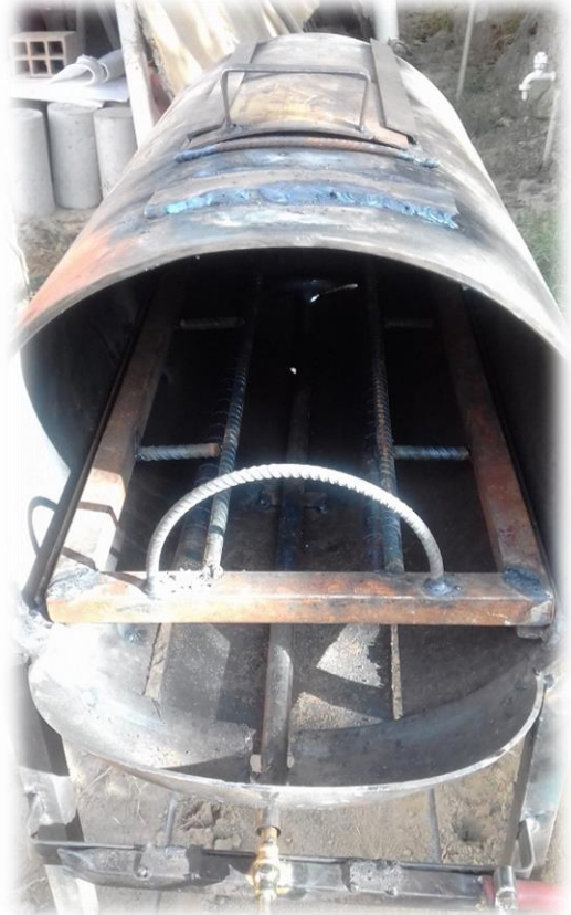
Interior del horno con los quemadores
