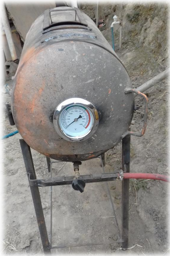
Reloj de lectura de temperatura (máx. 600°C)
