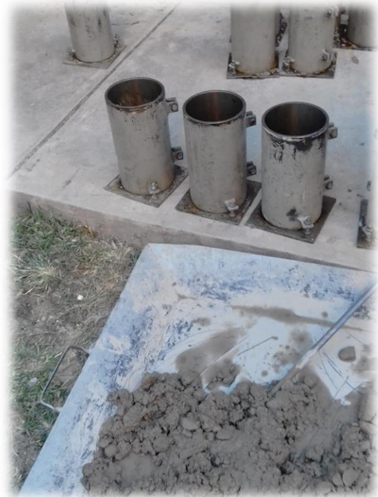
Colocado del hormigón en los moldes
