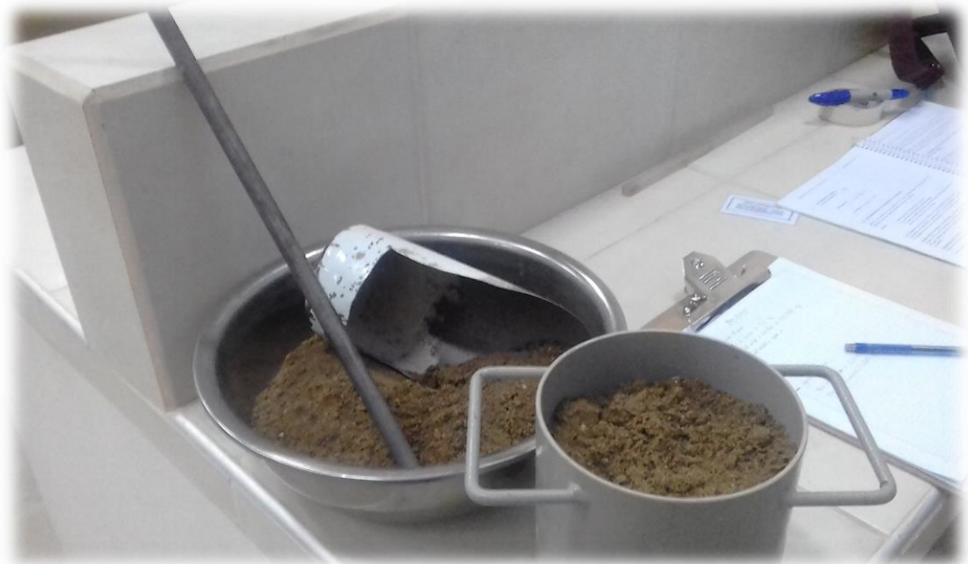
Llenado del molde con el agregado fino
