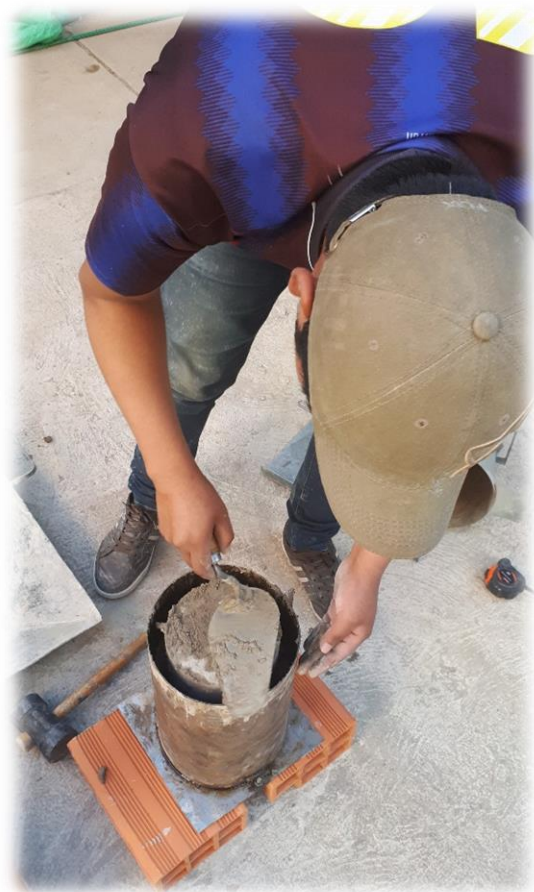
Llenado del material de encamisado en el molde
