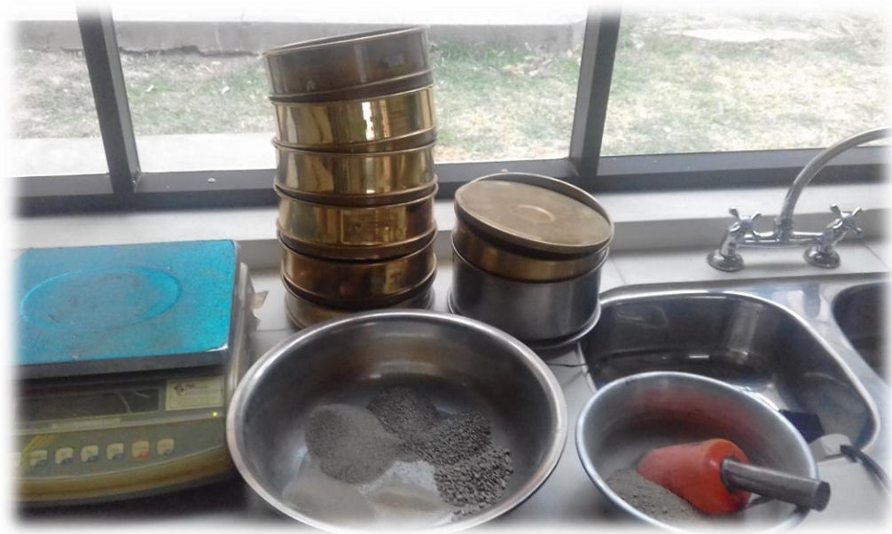
Pesado de la muestra retenida en cada tamiz.
