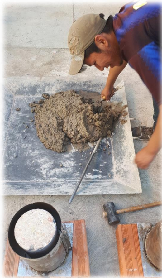
Llenado del material de encamisado en el molde
