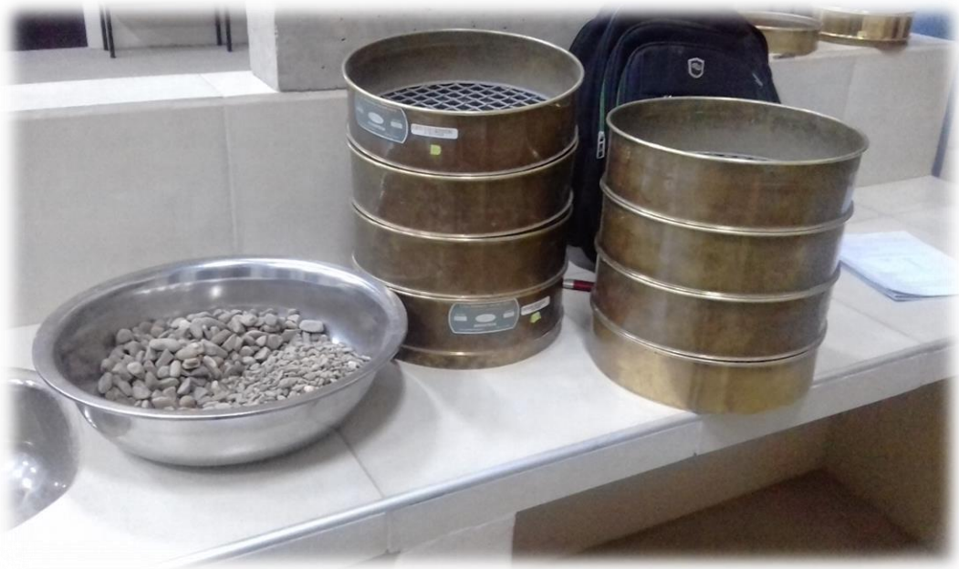
Realización del tamizado del material seleccionado
