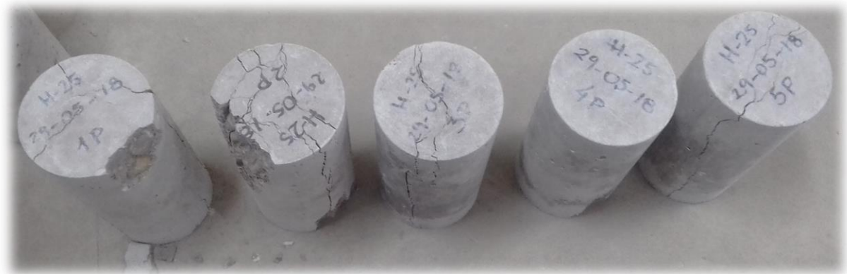
Vista superior de probetas después del ensayo (4P sin daños)
