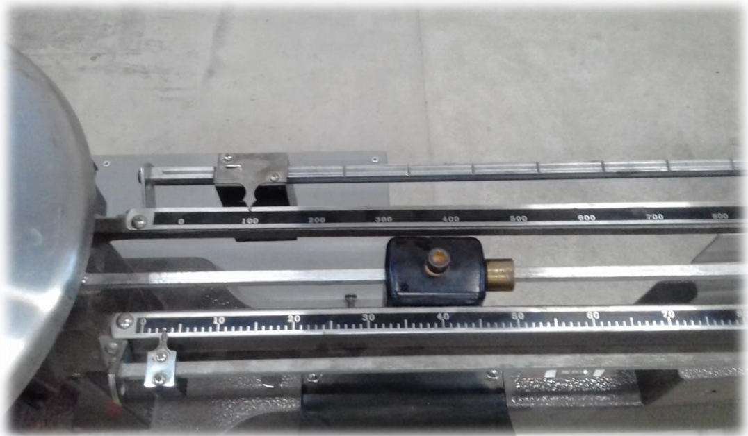
Lectura del peso de la muestra sumergida
