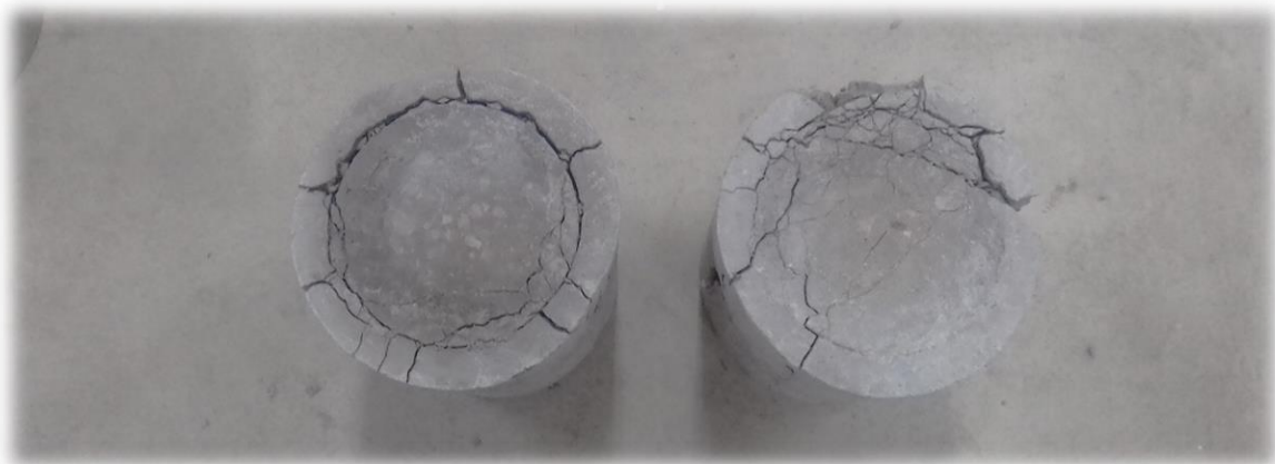
Vista superior de las probetas con fallo
