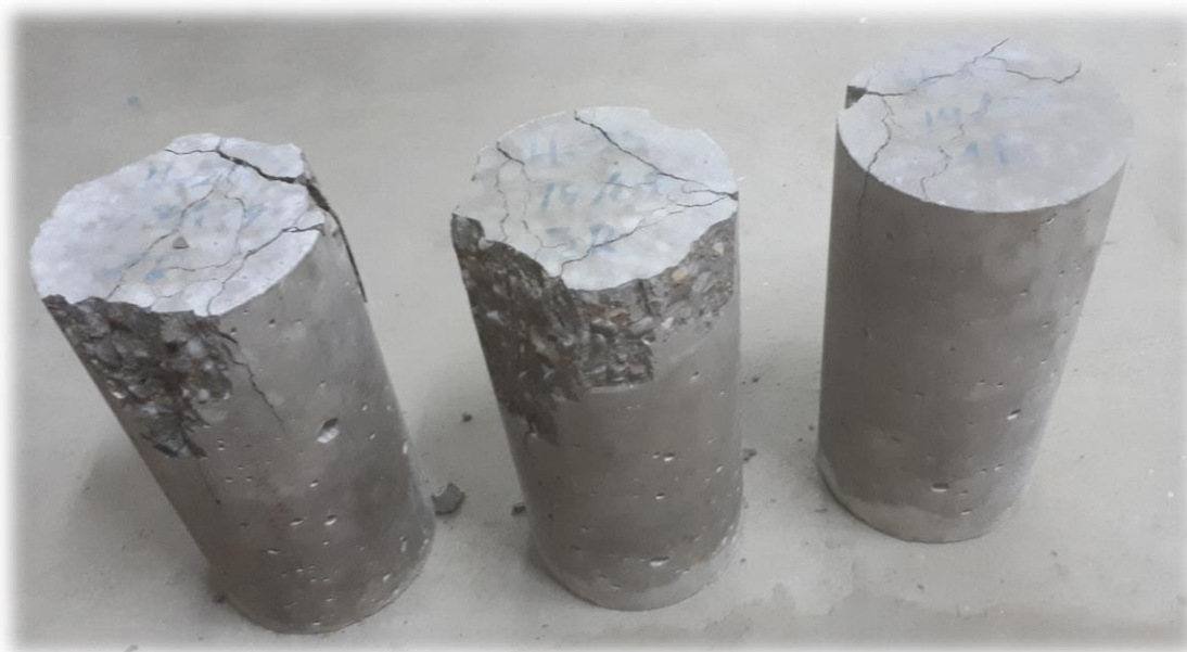
Vista lateral de las probetas (fallos en los bordes)
