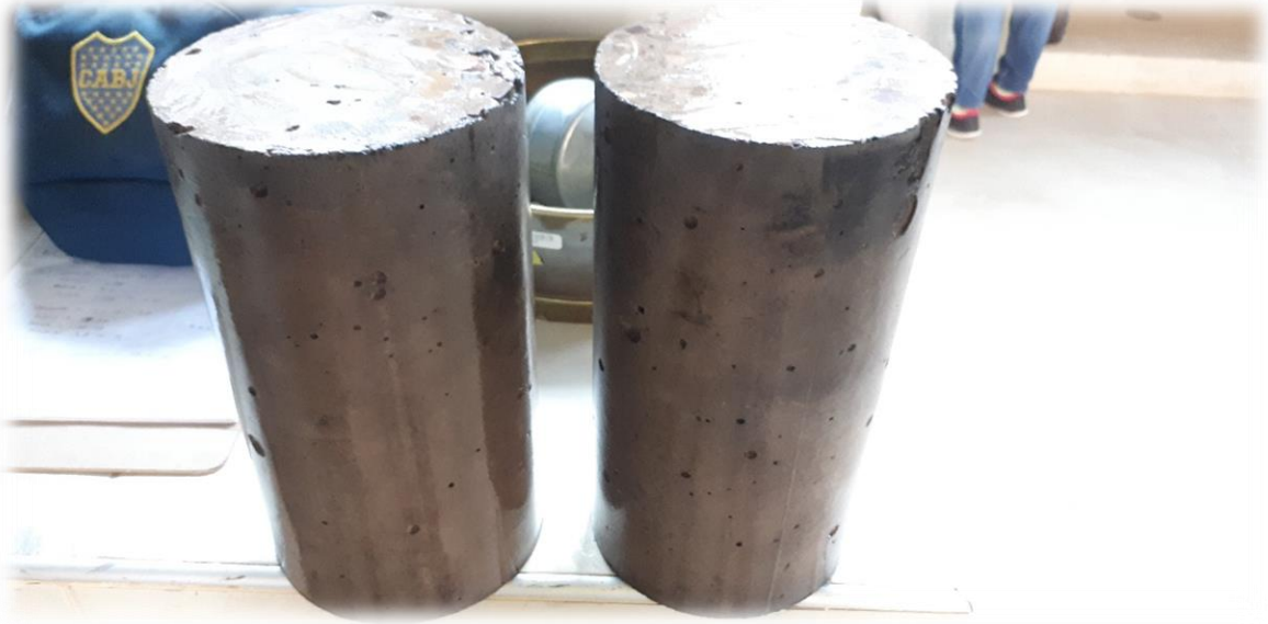
Preparado de probetas para el hormigonado
