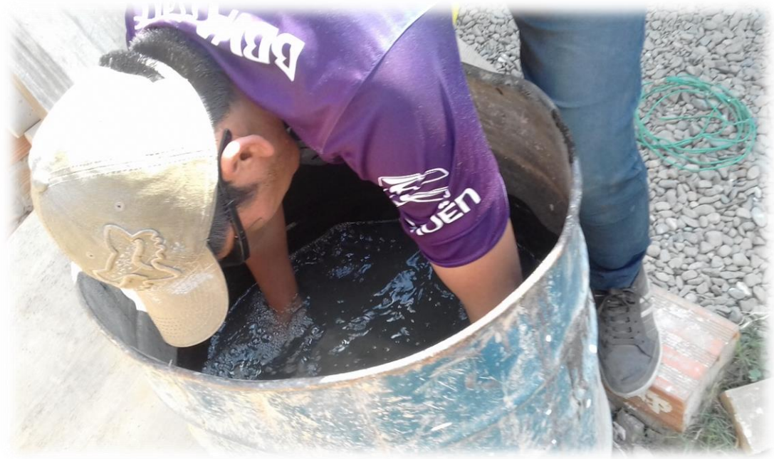
Extracción de la probeta del tanque de agua
