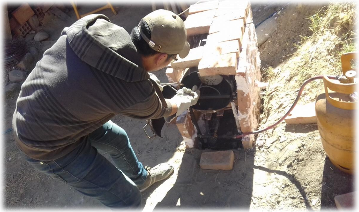
Extracción de la probeta con ganchos y guantes
