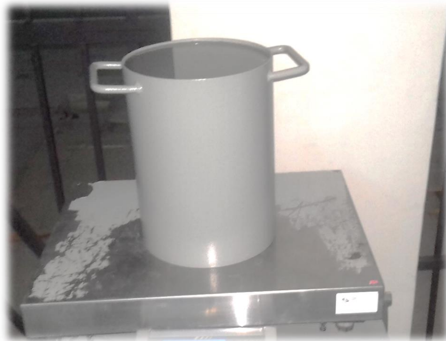
Calibración del molde con agua para determinar el volumen
