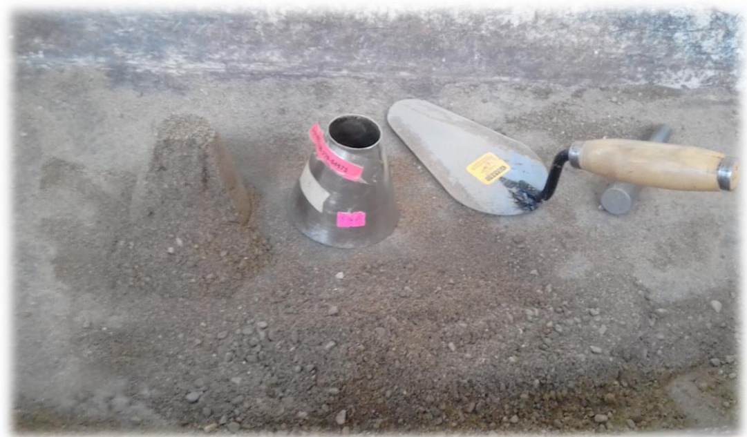
Secado del material hasta que se desmorone del cono
