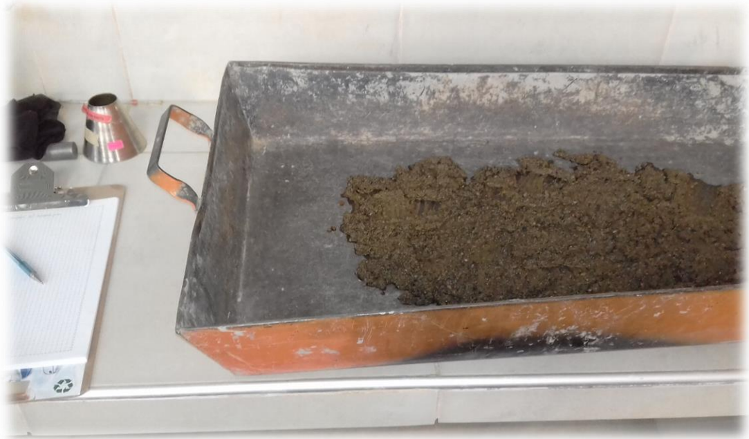
Preparación de la muestra para ser secada superficialmente
