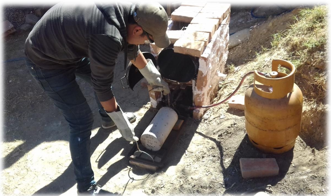
Manejo de la probeta con ganchos para evitar quemaduras
