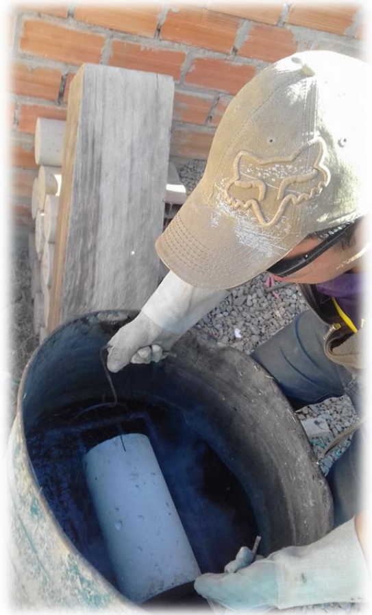
Probeta sometida al choque térmico
