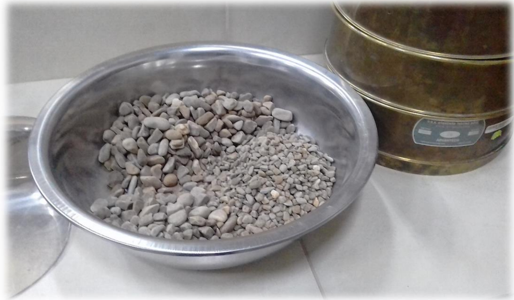
Pesado del material retenido en cada tamiz
