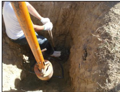
Figura 5: Ensayo de penetración estándar S.P.T.
