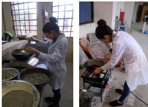
Imagen 3.32: Preparación de la dosificación para realizar una briketa
