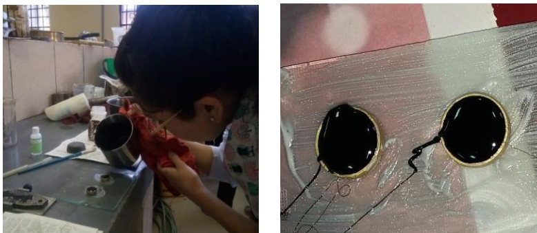
Imagen 3.26: Cemento asfáltico en los anillos
