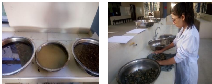
Imagen 3.12: Muestra saturada durante 24 hs.
