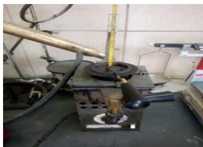
Imagen 3.24: Equipo de punto de inflamación
