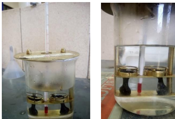
Imagen 3.27: Punto de ablandamiento del cemento asfáltico
