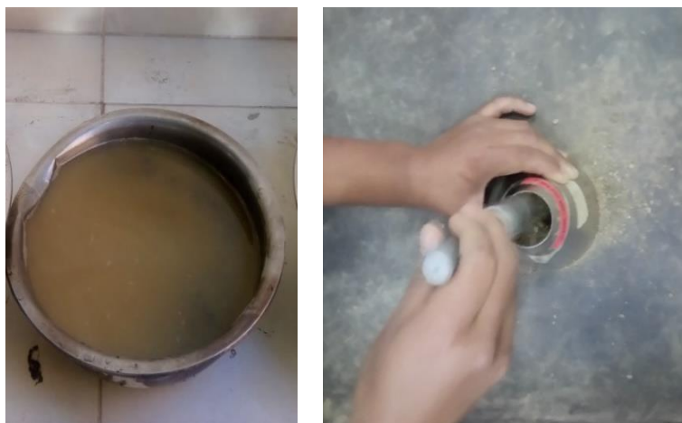
Imagen 3.15: Muestra saturada por 24 hs. y verificación de la condición de saturación
