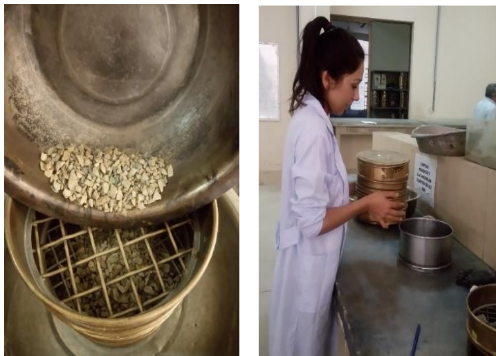
Imagen 3.10: Tamizado de los agregados pétreos
