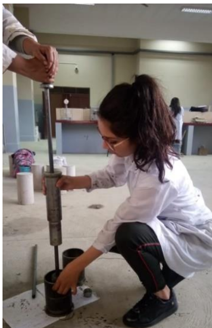
Imagen3.33: Compactación de la mezcla a 160° C en los moldes de Marshall
