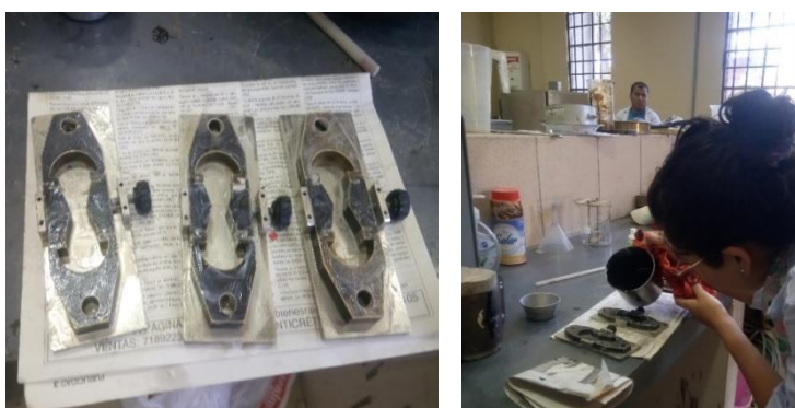
Imagen 3.28: Muestra vertida en los moldes
