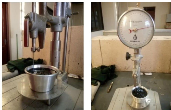
Imagen 3.22: Ensayo de penetración
