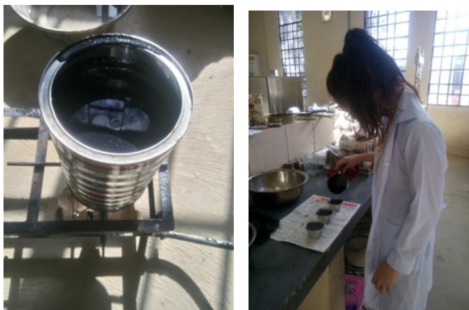
Imagen 3.21: Muestra calentada y vertida en los recipientes de ensayo
