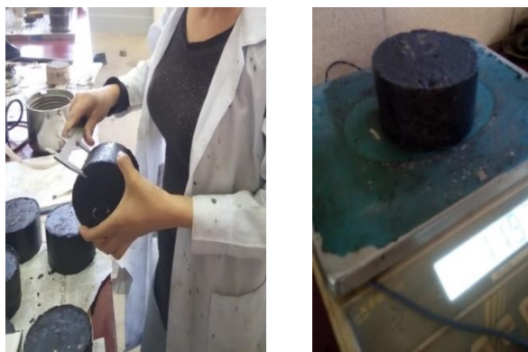
Imagen 3.34: Medición de alturas y determinación de peso seco de las briquetas
