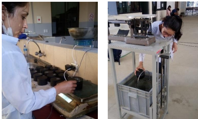
Imagen 3.35: Peso superficialmente seco y peso específico sumergido
