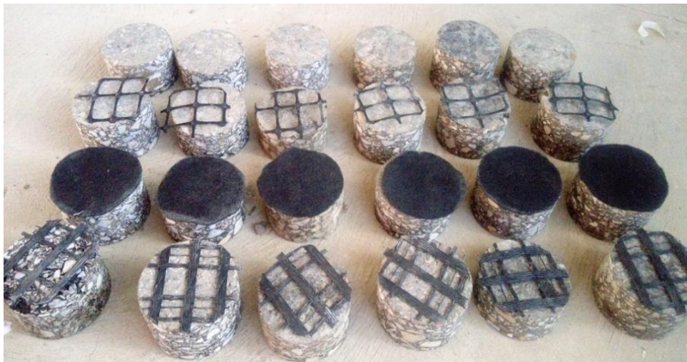
Imagen 3.49: Designación de los geosintéticos en función al tipo y el tramo de estudio
