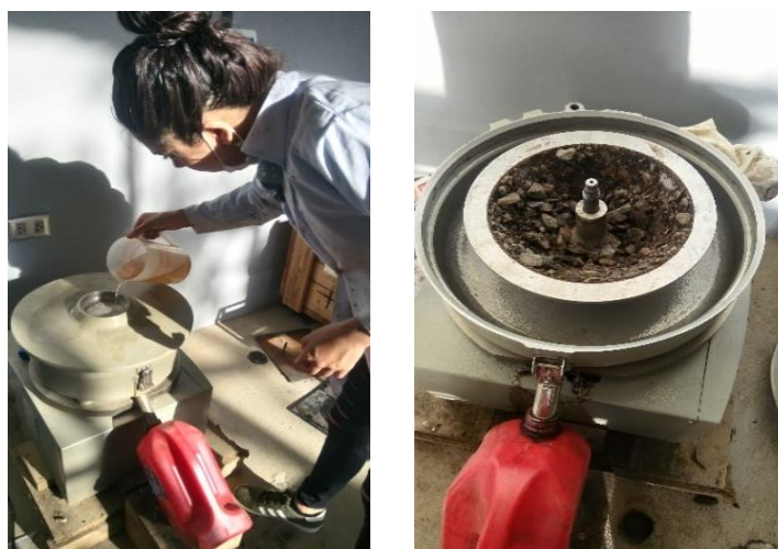
Imagen 3.47: Ensayo de extracción centrifuga
