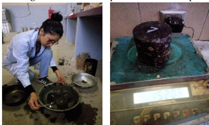
Imagen 3.44: Núcleos superficialmente secos pesados
