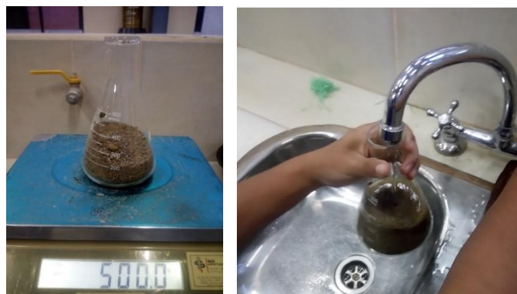
Imagen 3.16: Muestra colocada con agua en el matraz y pesada
