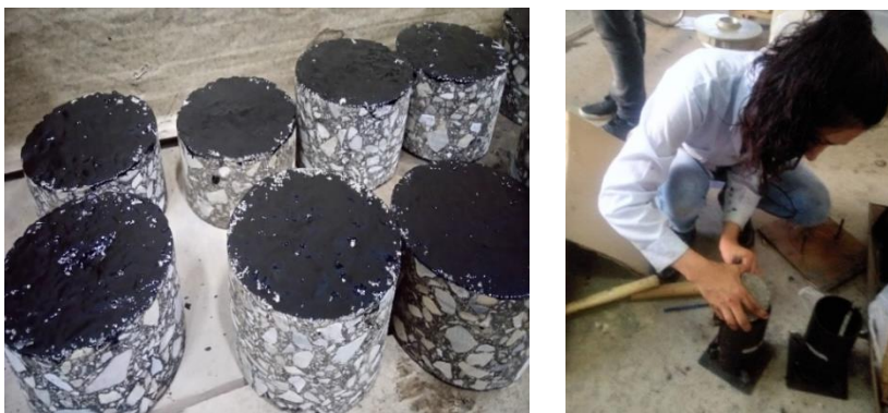
Imagen 3.50: Núcleos imprimados y colocados en los moldes
