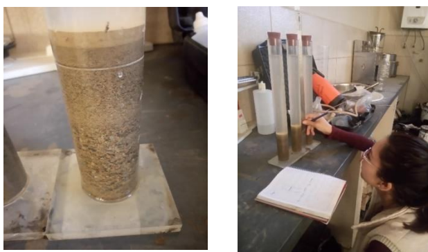
Imagen 3.20: Lectura de las alturas de separación de los finos
