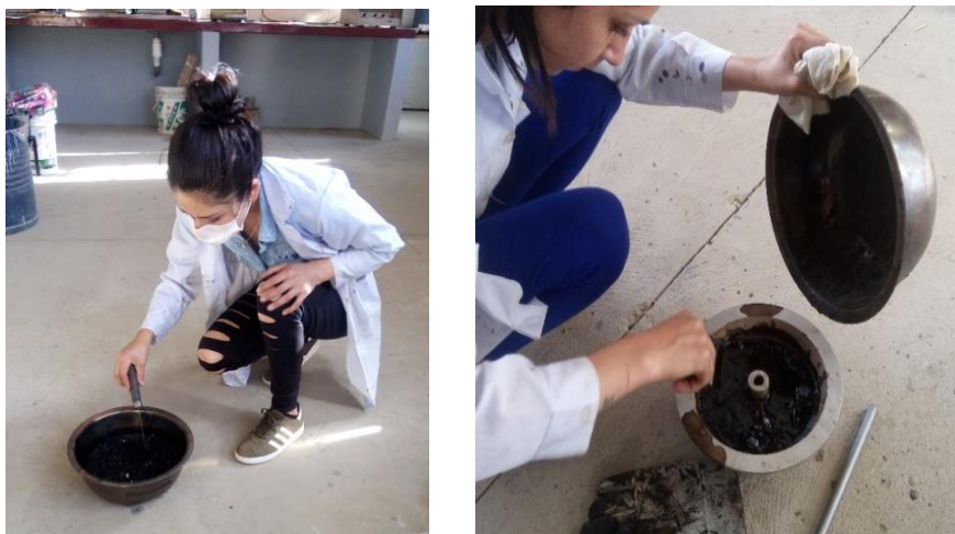
Imagen 3.46: Muestra calentada en horno y colocada en la tasa del extractor
