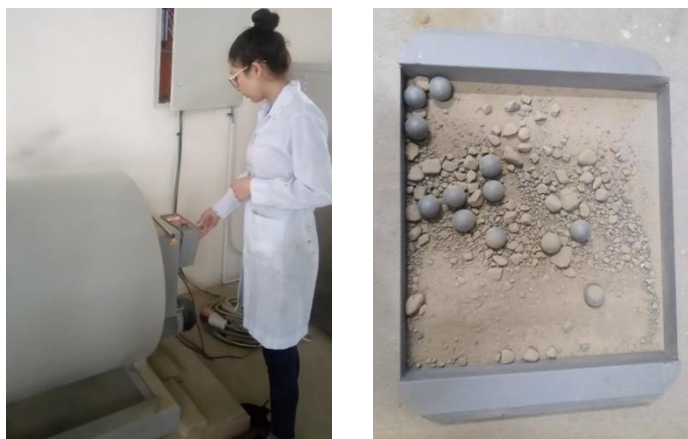
Imagen 3.18: Máquina de desgaste Los Ángeles
