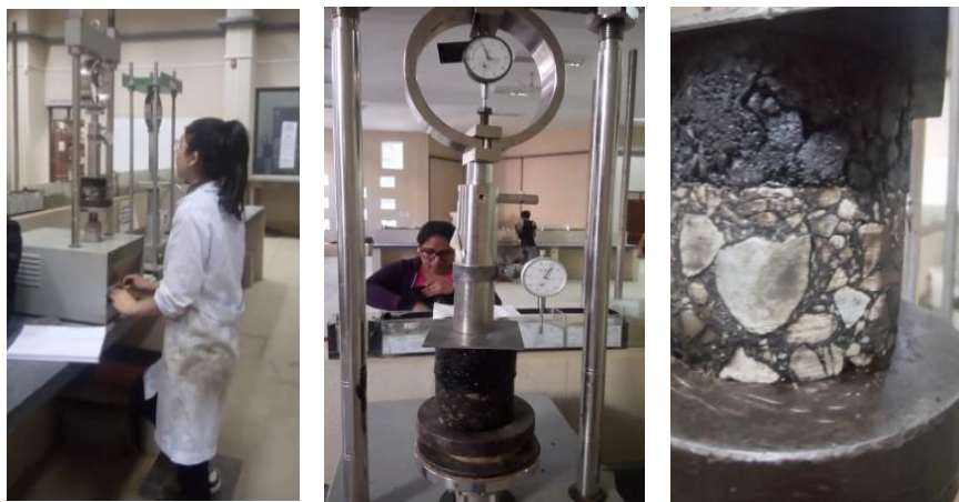
Imagen 3.54: Ensayo de compresión inconfinado de las briquetas
