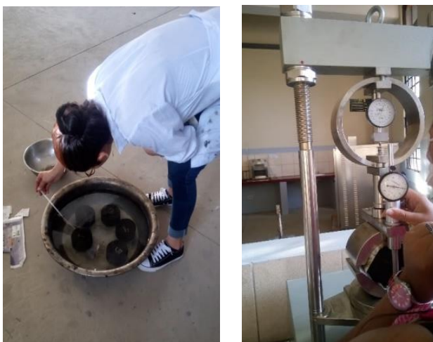
Imagen 3.36: Determinación de estabilidad y fluencia de las briquetas
