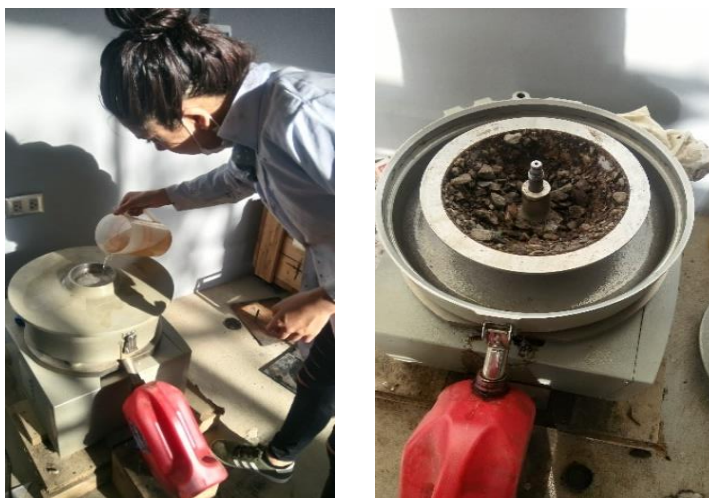
Imagen 3.47: Ensayo de extracción centrifuga
