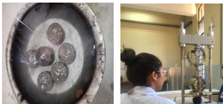
Imagen 3.45: Rotura de los núcleos en la prensa de Marshall
