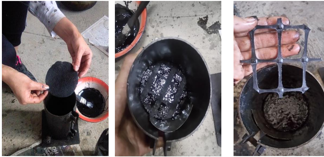
Imagen 3.51: Colocación de los geosintéticos
