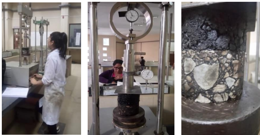
Imagen 3.54: Ensayo de compresión inconfinado de las briquetas
