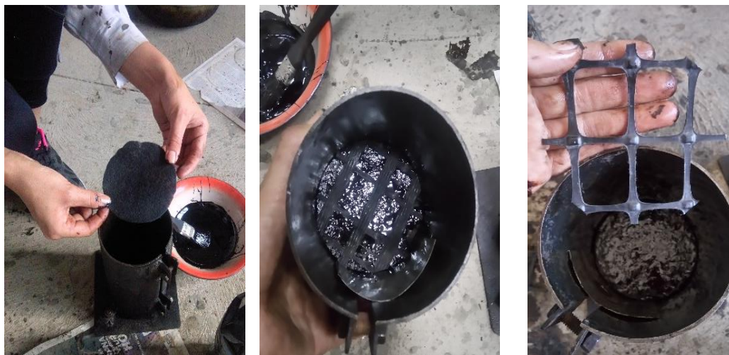
Imagen 3.51: Colocación de los geosintéticos
