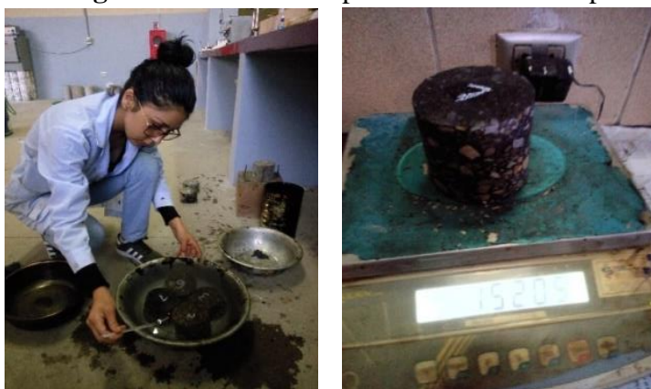
Imagen 3.44: Núcleos superficialmente secos pesados
