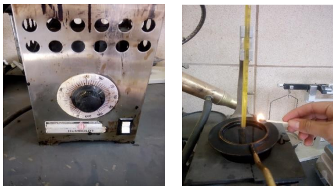
Imagen 3.25: Aumento de temperatura y verificar su punto de inflamación
