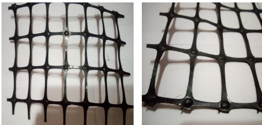
Imagen 3.6: Geomalla biaxial utilizada
