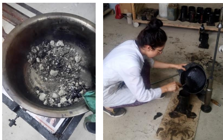
Imagen 3.52: Mezcla calentada y colocada en los moldes para compactar
