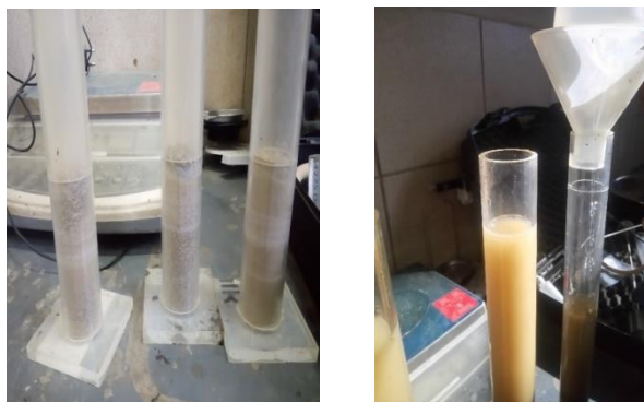
Imagen 3.19: Muestra en las tres probetas y colocación de solución
